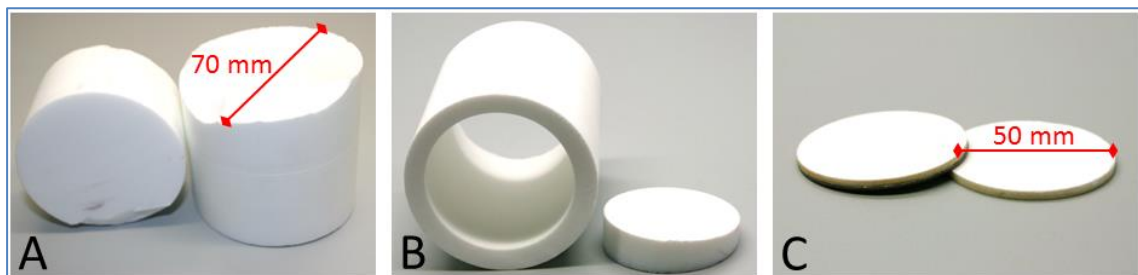
Figure 69 : Photos des différentes étapes de la préparation des cibles de verre de 50mm de diamètre : A- carottes de verre Ø : 70mm après élaboration B- découpe de tranches de Ø : 50mm C- Polissage 2 faces jusqu'à épaisseur 2mm et collage à l'indium sur une plaque de cuivre épaisseur 1 mm (gauche).
