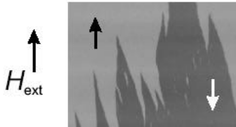
Figure I.6. Image de microscopie Kerr ( 200 \mu\text{m} \times 200 \mu\text{m} ) prise, à 20 \text{ K} , sur un film mince de Verre/ \text{Tb}_{12}\text{Fe}_{88} ( 50 \text{ nm} )/ \text{Gd}_{40}\text{Fe}_{60} ( 100 \text{ nm} )/ \text{Al} ( 5 \text{ nm} ) à un instant du renversement de l'aimantation de la couche de \text{GdFe} . Le champ est appliqué le long de l'axe d'anisotropie de la couche de \text{GdFe} observée.
