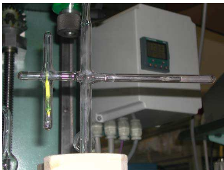
Figure 16 : Prototype de dopage relié au dispositif de pompage sous vide (en haut). L'ampoule contenant la p -nitroaniline est jaune et le capillaire plonge dans un four (en bas).
