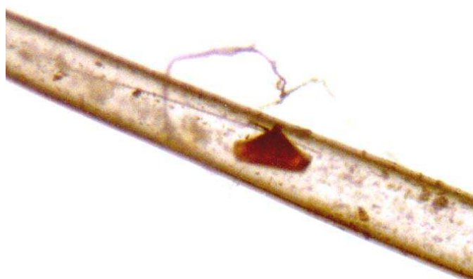
Figure 14 : Fragment pyramidal de tamis moléculaire de type MFI dopé à la p -nitroaniline dans son capillaire de silice.
