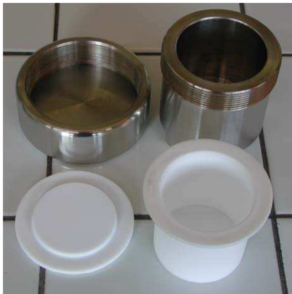
Figure 1 : Photographie du corps du réacteur en acier et de sa chemise en Téflon ® . Les dimensions internes du réacteur sont h=55\text{mm} et \varnothing=55\text{mm} .
