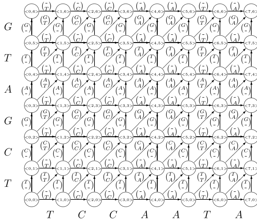
FIG. 2.1 – Graphe d'édition des mots u = TCCAATA et v = TCGATG
