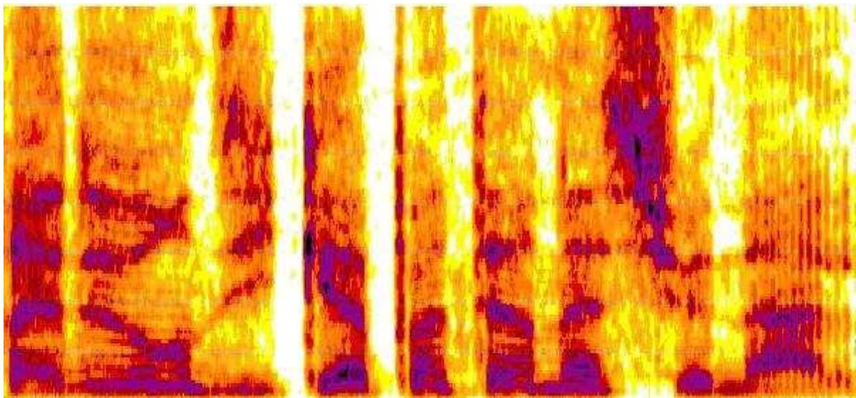
FIG. 1.1 – Spectrogramme d'un signal de parole
