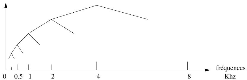
FIG. 3.5 – Résolution fréquentielle obtenue à l'aide de la décomposition en ondelettes dyadiques. (arbre de décomposition dyadique avec 5 niveaux de décomposition)
