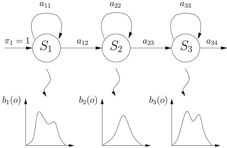
FIG. 1.10 – HMM gauche-droite à 3 états usuellement utilisé pour la modélisation de phonèmes. Les lois de probabilité  $b_i(o)$  fournissant les probabilités qu'une observation  $o$  ait été générée par un état  $S_i$  sont modélisées par des modèles à mélange de gaussiennes (GMM).
