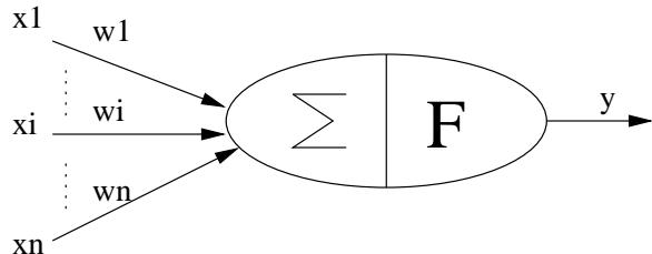
FIG. 1.12 – Architecture d'un neurone formel à  $n$  entrées.
