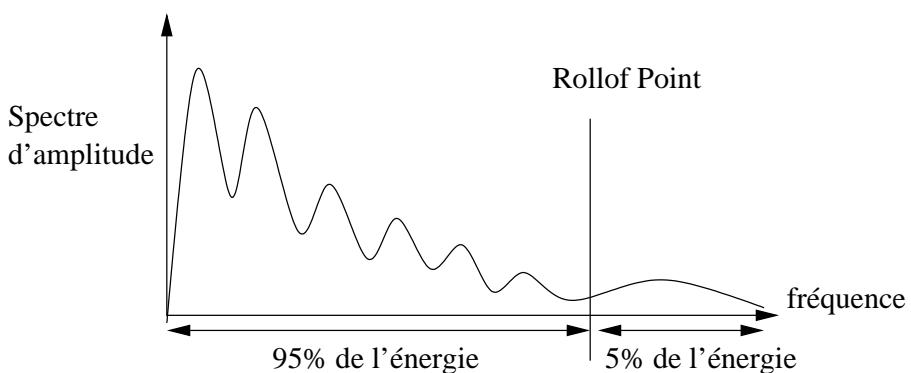
FIG. 1.5 – Définition du “*Spectral Rolloff Point*”
