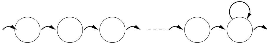
FIG. 6.5 – Topologie des HMMs utilisés pour l'approche de mise en compétition de 5 modèles dans le module de classification parole/musique. 50 GMMs à un état sont concaténés pour définir une durée minimale d'une demi-seconde.
