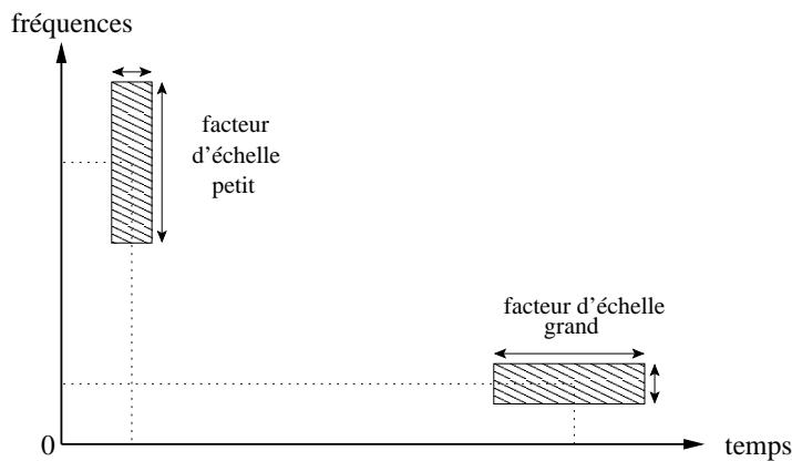
FIG. 3.1 – Boîtes de Heisenberg correspondant au pavage du plan temps-fréquence de la transformée en ondelettes à des échelles différentes. Une échelle plus petite réduit l'étagement en temps mais augmente la taille du support fréquentiel.
