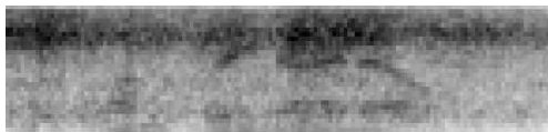
(c) - Mel spectrogramme de la séquence de chiffres : "one three nine oh" corrompue par le bruit du métro à 0 dB.
