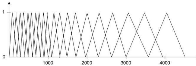
FIG. 1.4 – Banc de filtres à échelle Mel.
