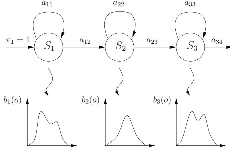
FIG. 1.6 – *HMM gauche-droite à 3 états usuellement utilisé pour la modélisation de phonèmes. Les lois de probabilité  $b_i(o)$  fournissant les probabilités qu'une observation  $o$  ait été générée par un état  $S_i$  sont modélisées par des modèles à mélange de gaussiennes (GMM).*
