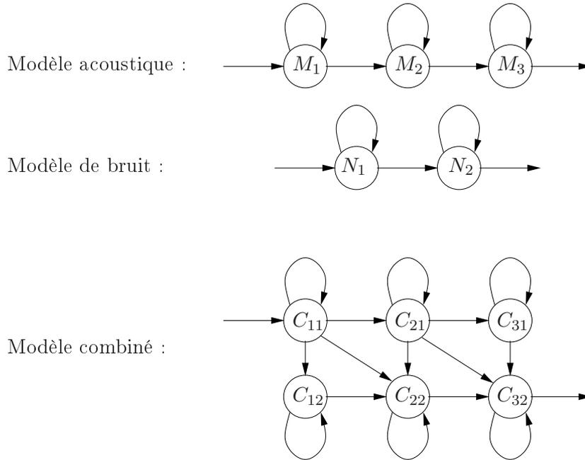
FIG. 1.10 – Combinaison parallèle de deux modèles de Markov.
