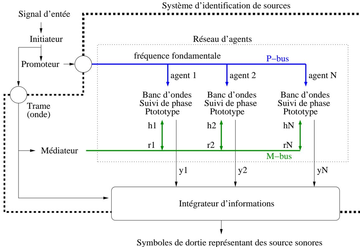
FIG. 3.3 – Exemple d'architecture d'un système CASA multi-agents : le système Ipanema d'analyse musicale. Chaque agent est spécialisé dans la traque d'un aspect du signal, sous le contrôle d'un agent « médiateur ».
