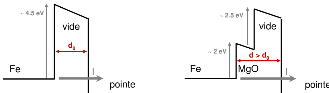
Fig. II-29 – Profils de potentiel au-dessus du Fe(001) libre et d'un îlot de MgO.
