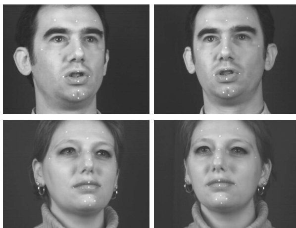
FIG. 7.2: Images en stéréovision de deux locuteurs, 15 marqueurs sont peints sur le visage de chaque locuteur.
