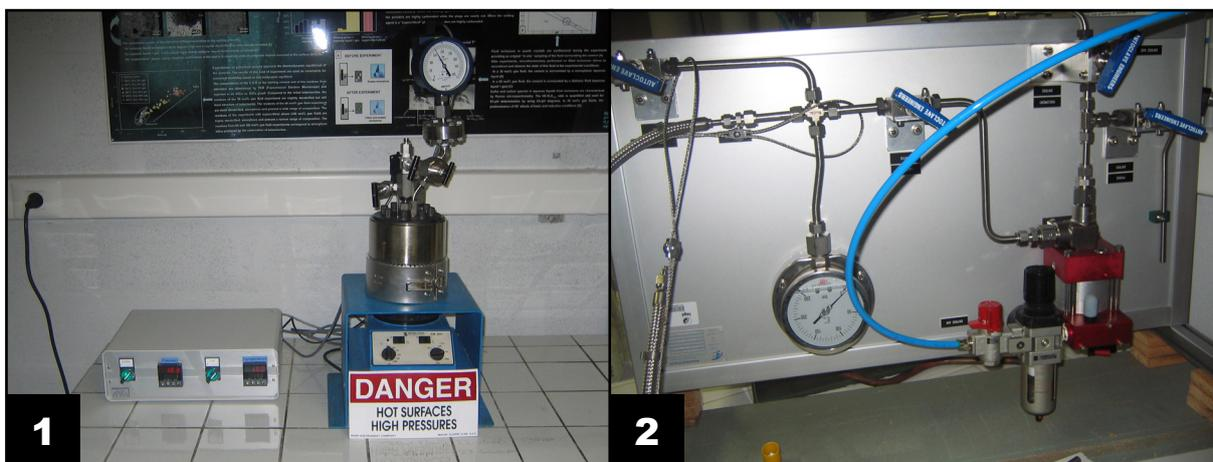
Figure V.29 : Photographies de l'autoclave Parr Instrument<sup>®</sup> avec sa station de régulation (1) et de la pompe d'injection de CO<sub>2</sub> (2).
