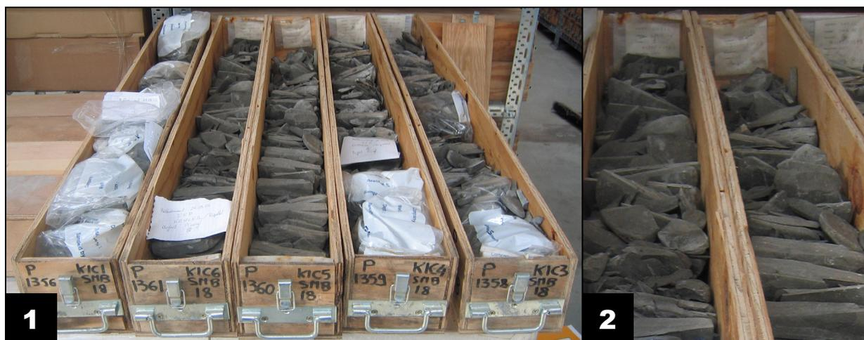
**Figure IV.7 : Photographie des carottes d'où sont issus les échantillons SMB18-1, SMB18-2 et SMB18-3 (1). L'état de conservation des carottes est médiocre (2), on peut observer la déstructuration des échantillons suite à une longue exposition aux intempéries.**
