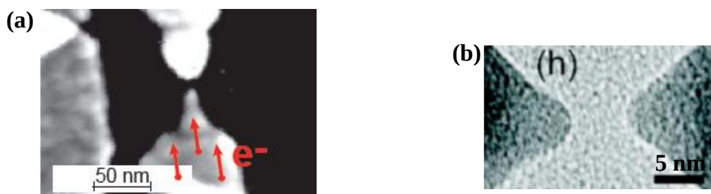
Figure I-14 : Effet du champ électrique développé dans le dernier stade de l'électromigration sur la géométrie des électrodes (a) En présence d'un champ électrique, les électrodes présentent une géométrie asymétrique avec une cathode en forme de pointe et une anode plane. Image réalisée en microscopie électronique à balayage, extraite de [MAN09-d]. (b) En l'absence de champ électrique, les électrodes sont plus symétriques. Image obtenue par microscopie électronique en transmission, Extrait de [HEE07].
