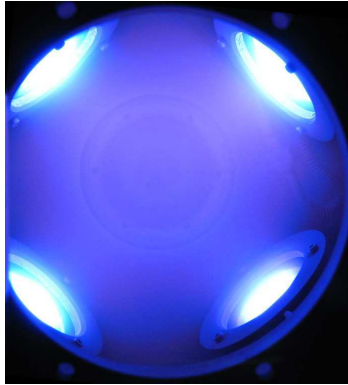
Figure 3-10 : Vue en coupe du plasma pour une puissance de 400 W avec une atmosphère de 2 Pa obtenue par l'injection d'un mélange gazeux de 33 % d'oxygène dans l'argon. La durée des impulsions est de 20 \mu s, répétées avec une fréquence de 2 kHz. La configuration électrique est de type bipolaire (cf Figure 3-4 (B))
