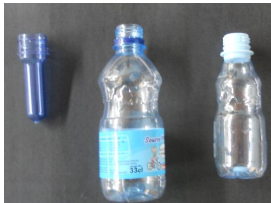
Figure 2-8: Evolution de la morphologie du PET: préforme amorphe, bouteille élaborée par soufflage/étirage la même bouteille après un maintien à 110°C pendant 1 heure
