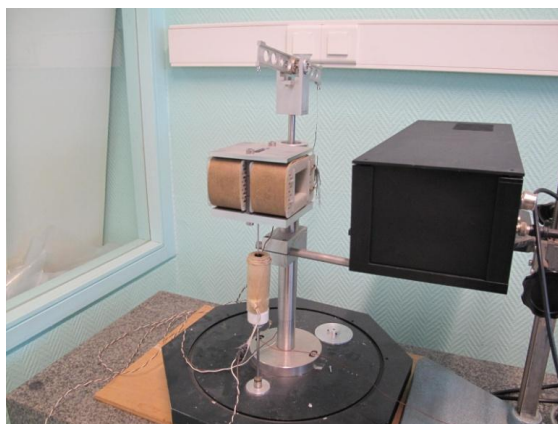
Figure 2-14: Partie mécanique de l'instrument utilisé dans cette étude pour les mesures d'élasticité dynamique du PET
