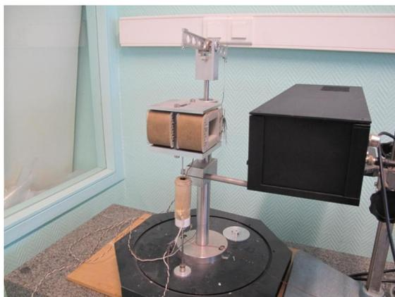
**Figure 2-14:** Partie mécanique de l'instrument utilisé dans cette étude pour les mesures d'élasticité dynamique du PET
