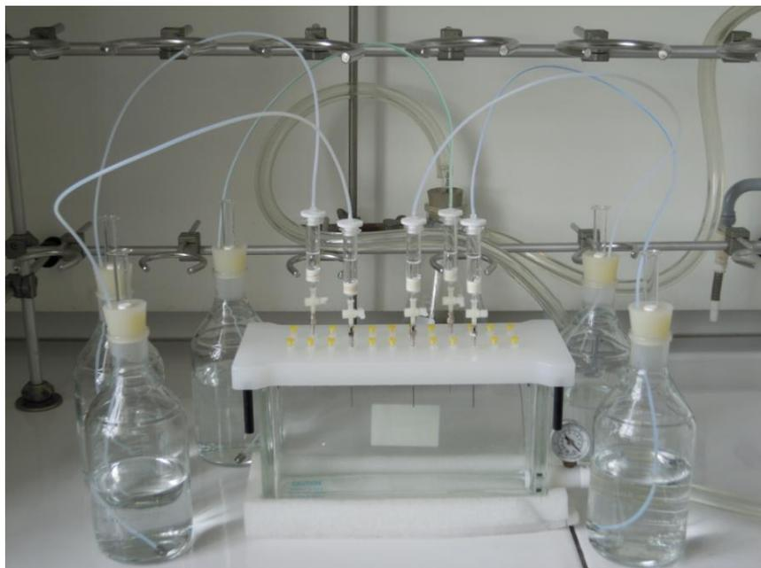
**Figure 3-15:** Dispositif d'extraction SPE
