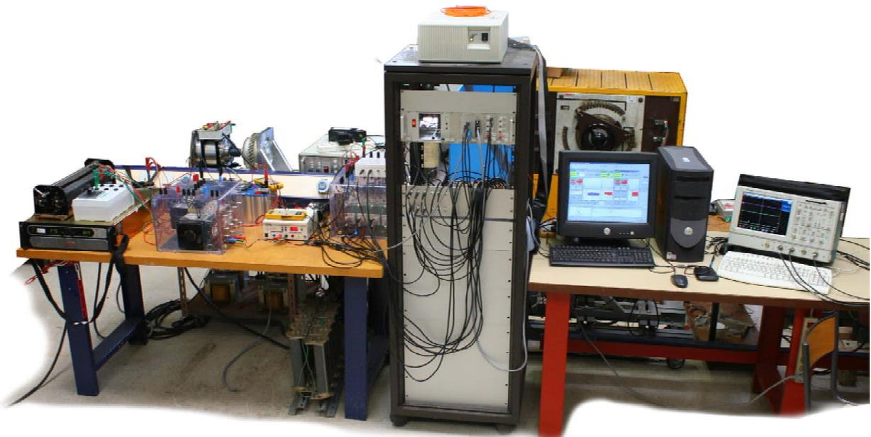
Figure A-1 : Photo du dispositif expérimental utilisé pour simuler les défauts inter-spores
