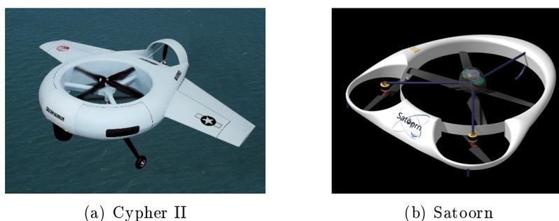
FIGURE 1.12 – Exemples de drones à rotors coaxiaux à carène courte
