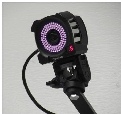
(b) Caméra IR du système OptiTrack
