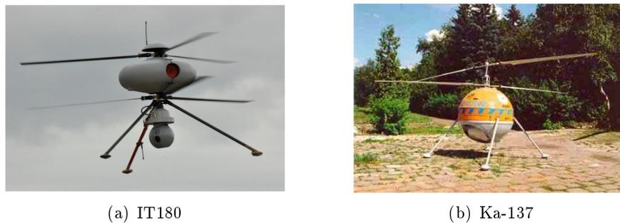
FIGURE 1.11 – Exemples de drones à rotors coaxiaux à usage externe
