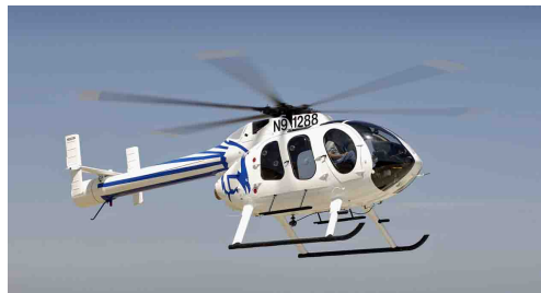
FIGURE 1.7 – Exemple d'hélicoptère NOTAR
