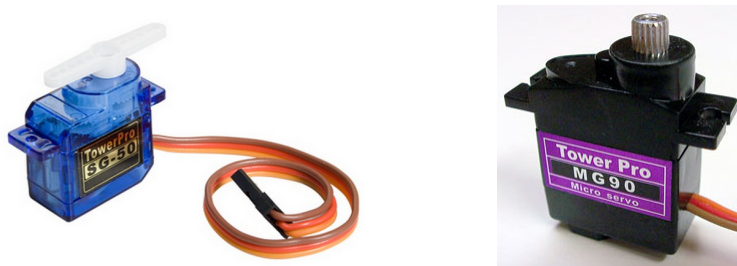
FIGURE 5.10 – Exemple de servomoteurs avec biellette et arbre à roue dentée
