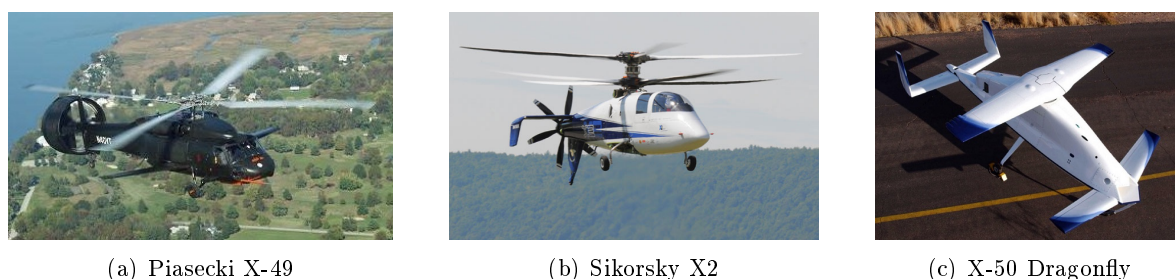
FIGURE 1.20 – Exemples de véhicules à technologie VTDP
