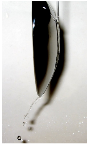
FIGURE 2.6 – Illustration de l'effet Coandă
