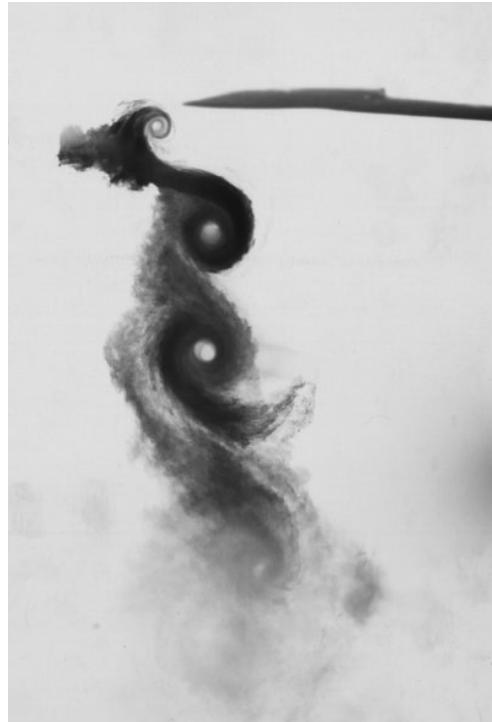
FIGURE 2.11 – Mise en évidence des tourbillons marginaux
