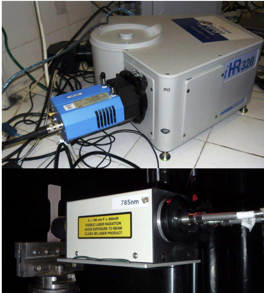
Figure II.1.15 : Spectromètre Raman iHR 320 et sa tête optique, reliés par fibre optique
