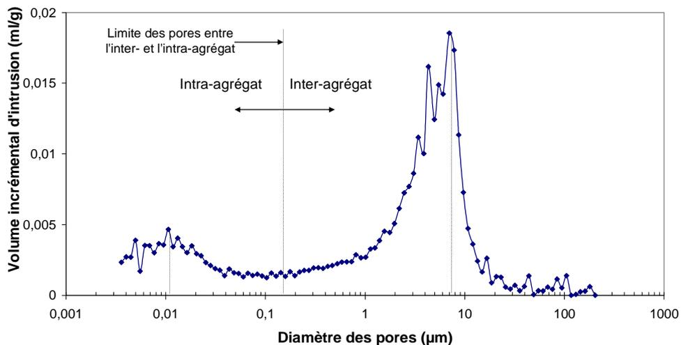
Figure II.4. Volume incrémental d'intrusion en fonction de diamètre des pores
