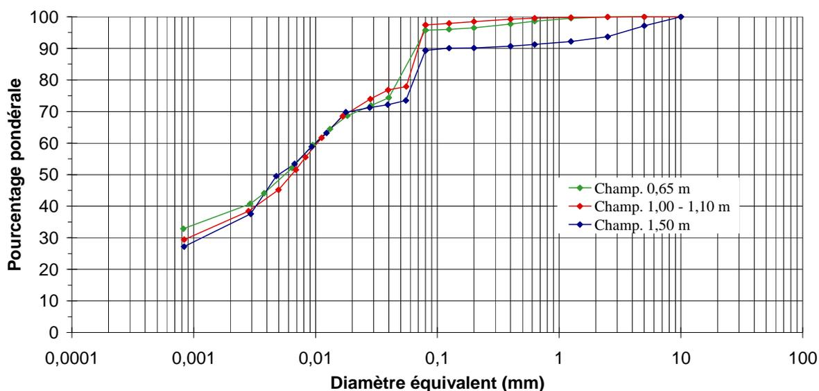
Figure III.6. Analyse granulométrique pour les trois matériaux (Champenois)
