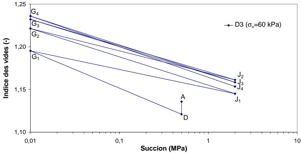
Figure III.40. Evolution de l'indice des vides sous des cycles de succion à la contrainte verticale constante de 60 kPa (site du Deffend -sondage E1)
