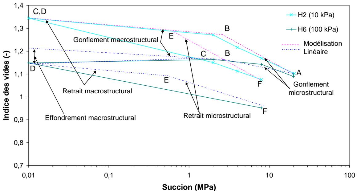
Figure II.25. Courbes d'humidification et de dessiccation sous les contraintes de 10 et 100 kPa
