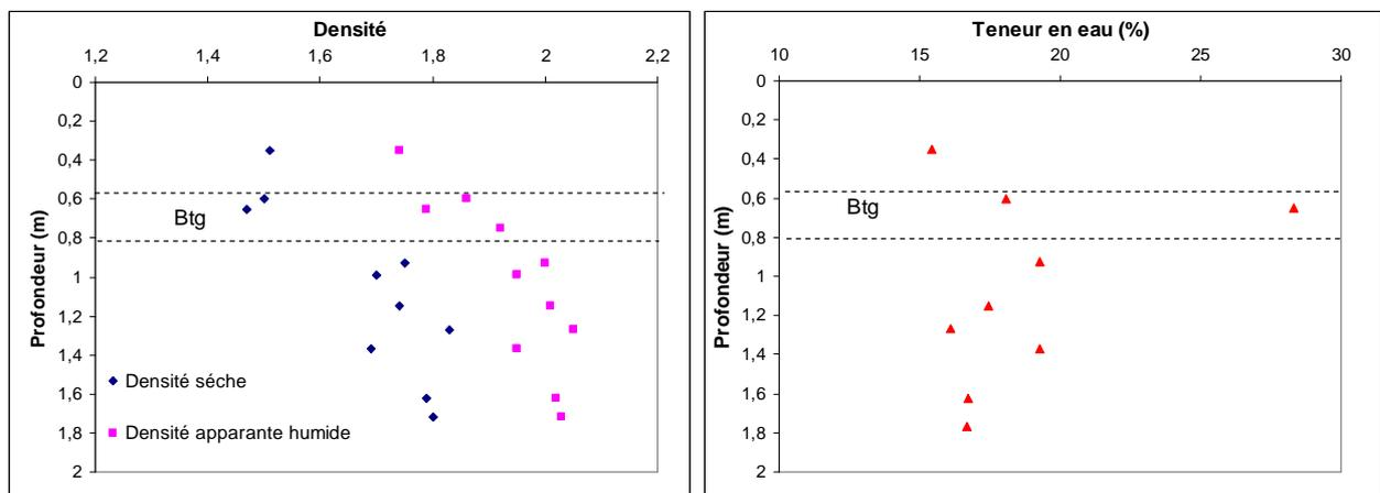
Figure III.4. Variations de la densité apparente sèche et de la teneur en eau de sol en fonction de la profondeur (Champenois)
