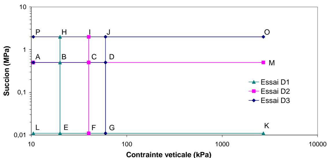
Figure III.37. Chemins de contraintes suivis dans le plan ( $\sigma_v^* - s$ ) (site du Deffend -sondage E1)
