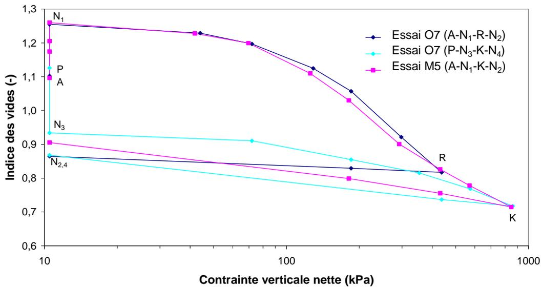
Figure II.42. Influence d'un cycle d'humidification et de séchage sur la courbe de compressibilité mécanique à la succion de 2 MPa (essais O7 et M5)
