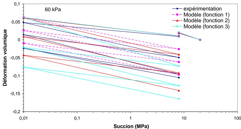
Figure II.52. Déformations volumiques expérimentales et calculées par le modèle sous des cycles de succion à la contrainte verticale constante de 60 kPa du mélange compacté
