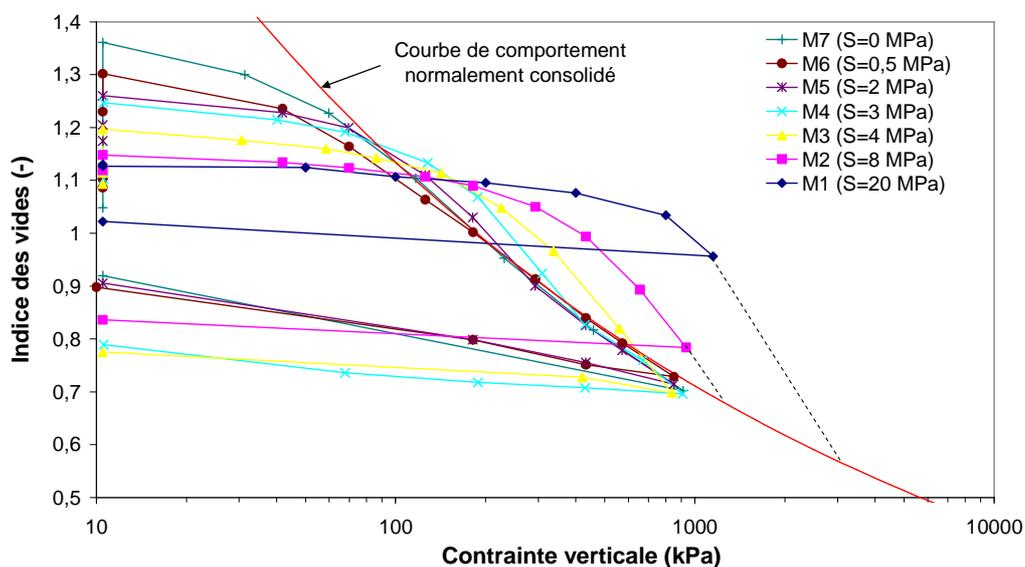
Figure II.19. Courbes de compressibilité sous différentes succions
