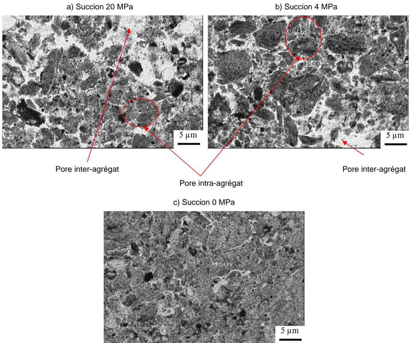
Figure I.6. Structure sous a) la succion initiale b) sous une succion de 4 MPa c) sous une succion de 0 MPa (Cuisinier, 2002)
