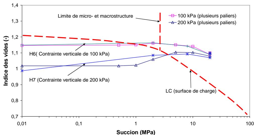
Figure II.26. Courbes d'humidification sous la contrainte de 100 et 200 kPa
