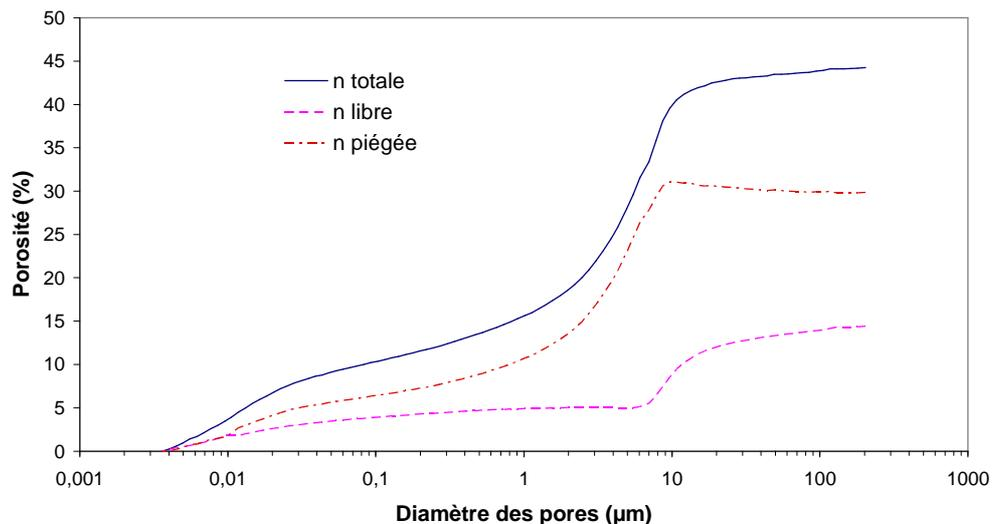
Figure II.2. Evaluation de la porosité du matériau étudié d'après un essai de porosimétrie au mercure
