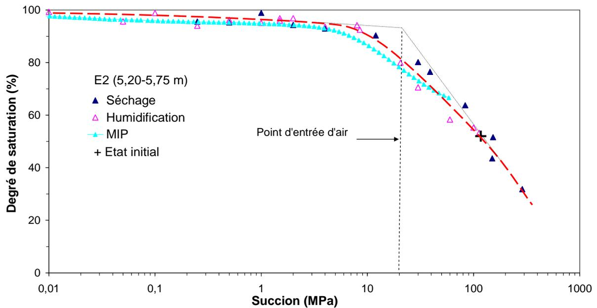
Figure III.32. Courbe (degré de saturation - suction) pour le matériau étudié (site du Deffend -sondage E2)
