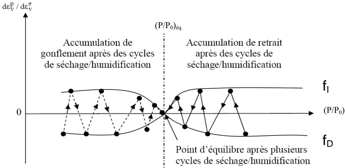
Figure 1.34. Couplage entre la micro- et la macrostructure
