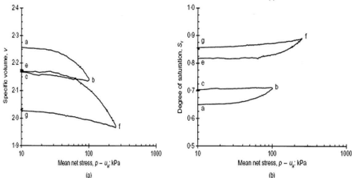
Figure I.31. Comportement mécanique et hydrique d'un mélange compacté de bentonite/kaolin à la succion constante 200 kPa (Wheeler et al., 2003).
