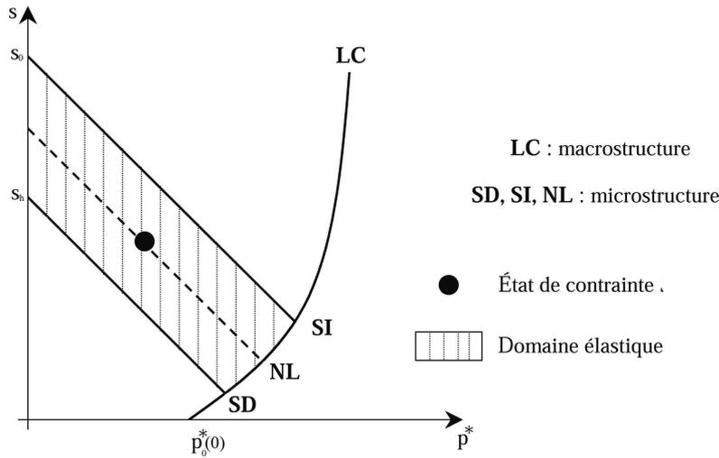
Figure I.33. Surface de charge du BExM
