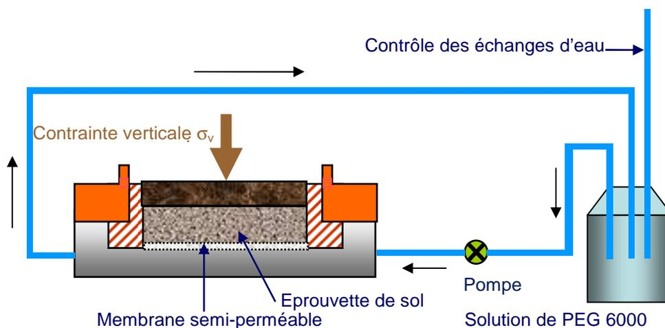
Figure I.35. Schéma de principe du dispositif œdométrique osmotique
