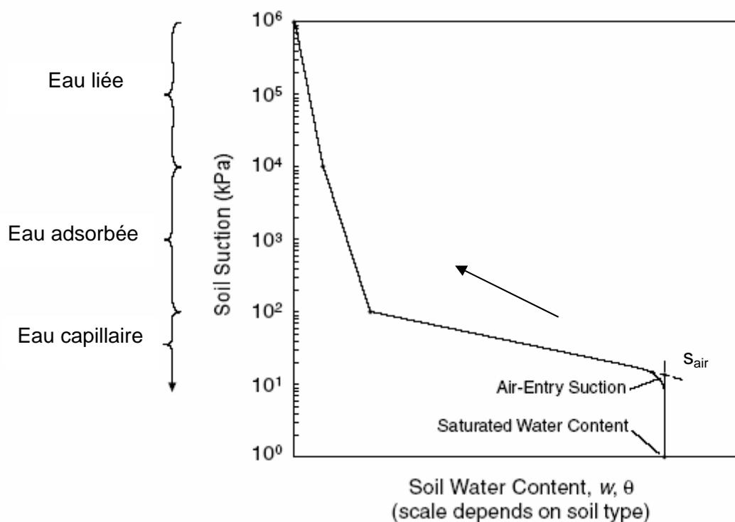
Figure I.16. Différentes phases de la désorption (McQueen & Miller, 1974)
