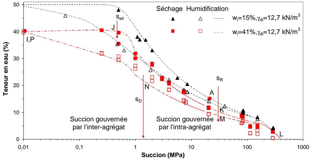
Figure II.14. Courbe de rétention aux différentes teneurs en eau initiales
