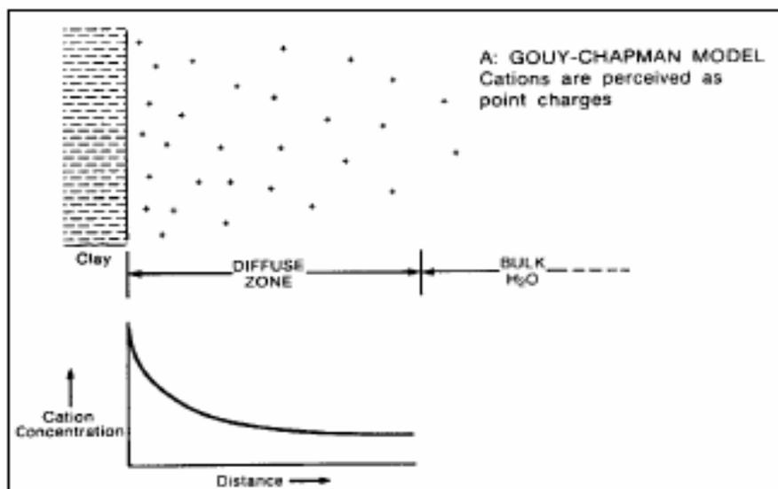
Figure I.8. Représentation schématique de la double couche diffuse
