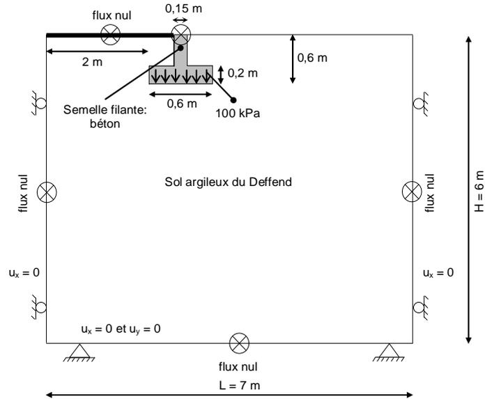
Figure III.57. Géométrie et conditions aux limites du modèle
