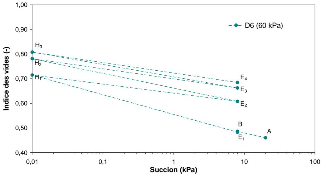
Figure III.47. Evolution de l'indice des vides sous des cycles de succion à la contrainte verticale constante de 60 kPa (site du Deffend -sondage E2)
