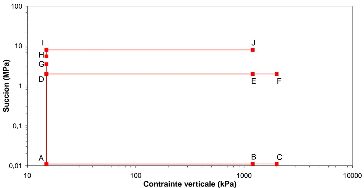
Figure III.13. Chemins de contraintes suivis dans le plan  $(\sigma_v^* - s)$  (Champenoux)
