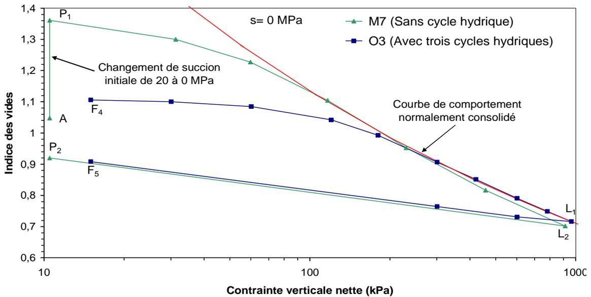
Figure II.37. Courbes de compressibilité pour les deux séries des essais sous la succion de 0 MPa
