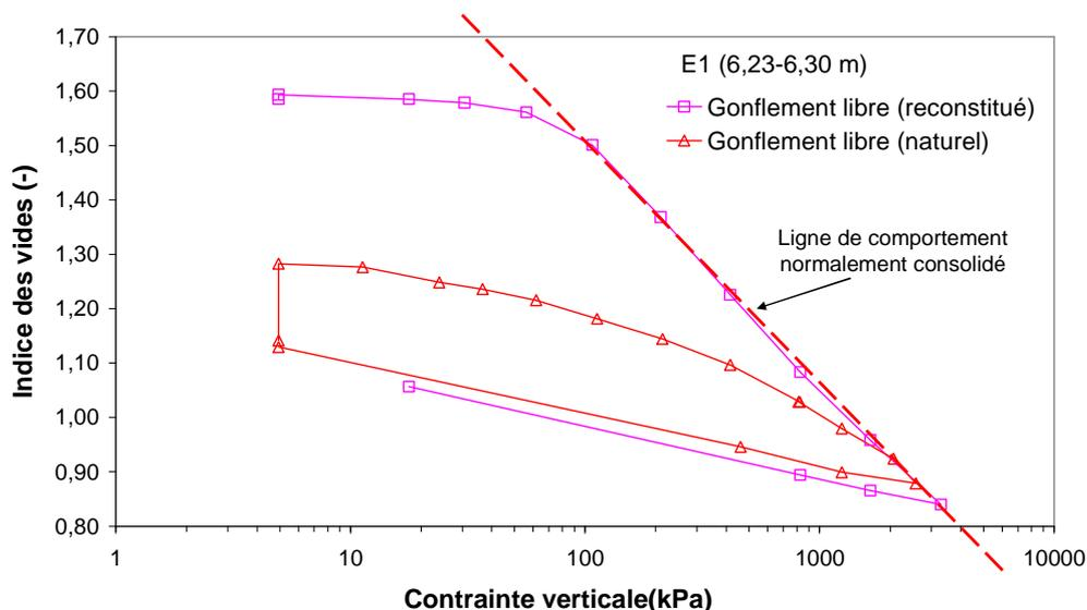
Figure III.35. Courbes de compressibilité à l'état saturé (site du Deffend - sondage E1)
