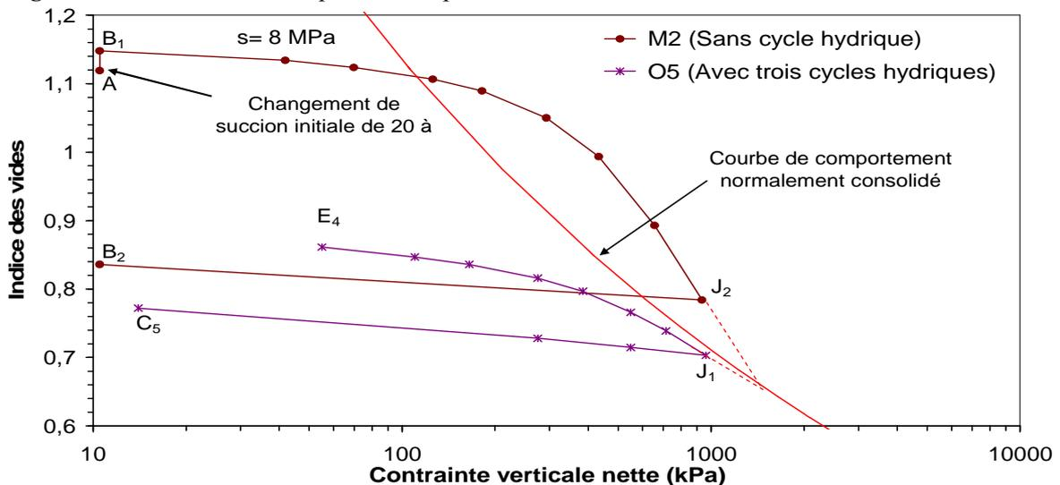
Figure II.39. Courbes de compressibilité pour les deux séries des essais sous la succion de 8 MPa
