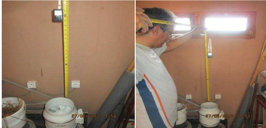
Figure.III.9.a : Mise en place du TESTO174H a 50 cm de l'entrée du tube monitoré.
