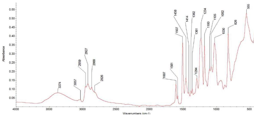
Figure 22 : Spectre IRTF du composite chargé à 10 % à l'état désorbé après un cycle sorption-désorption à 30 °C.
