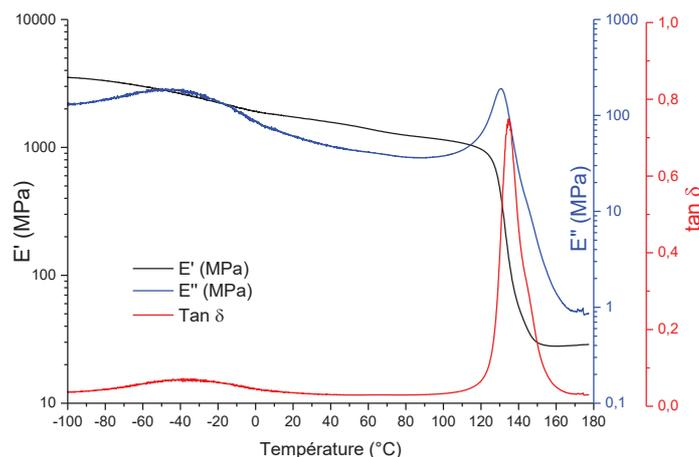
Figure 13 : Evolution du module de conservation  $E'$ , du module de perte  $E''$  et du facteur d'amortissement  $\tan \delta$  pour le composite chargé à 10 %.
