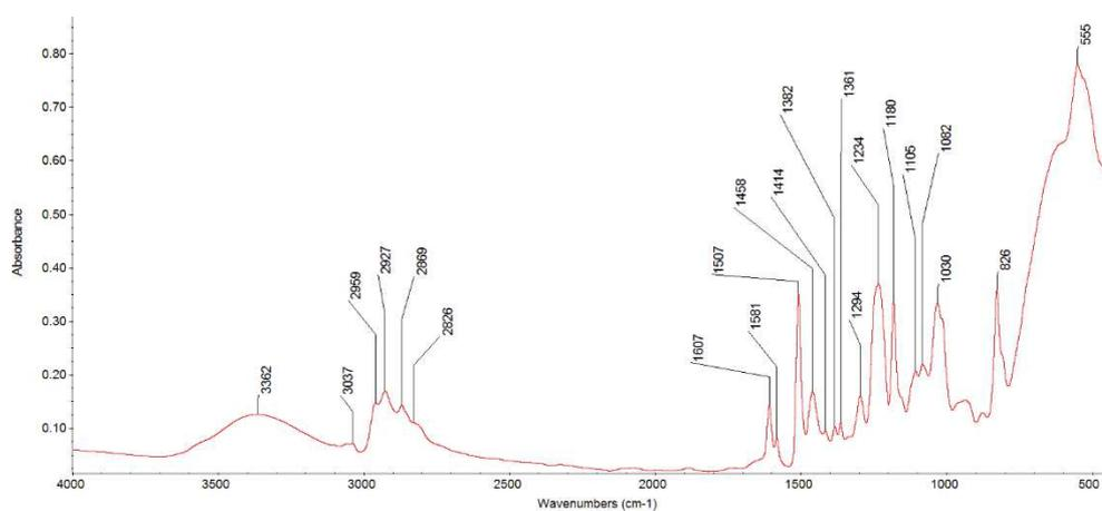
Figure 20 : Spectre IRTF du composite chargé à 20 % à l'état désorbé après un cycle sorption-désorption à 60 °C.
