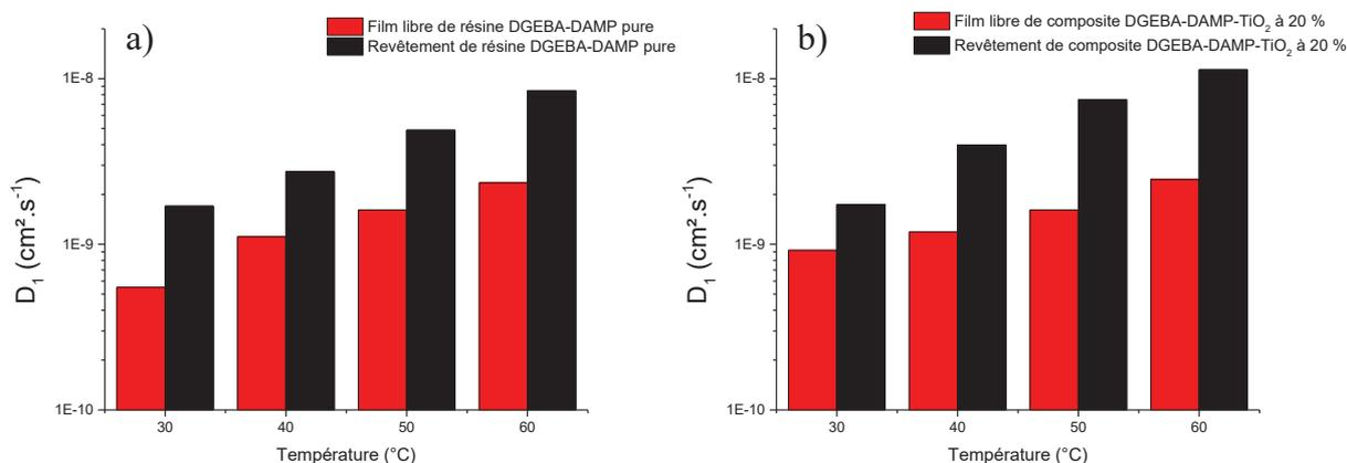
Figure 23 : Coefficients de diffusion  $D_1$  des films libres suivis par gravimétrie et des revêtements suivis par SIE pour la résine DGEBA-DAMP pure [1] (a) et pour le composite chargé à 20 % (b).
