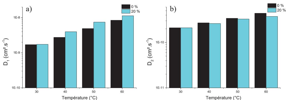
Figure 14 : Coefficients de diffusion  $D_1$  (a) et  $D_2$  (b) pour les revêtements de résine DGEBA-DAMP pure et de composite DGEBA-DAMP- $\text{TiO}_2$  chargé à 20 %.
