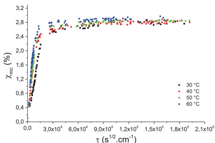
Figure 03 : Courbes de sorption de la résine DGEBA-DAMP pure [1,10].
