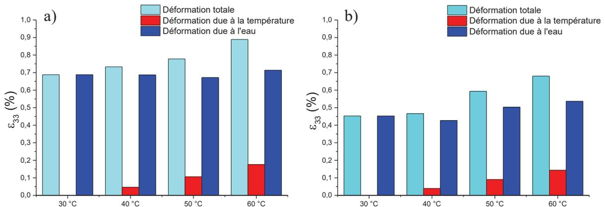
Figure 17 : Séparations des contributions thermique et due à l'eau du gonflement pour la résine DGEBA-DAMP pure (a) et pour le composite chargé à 20 % (b).
