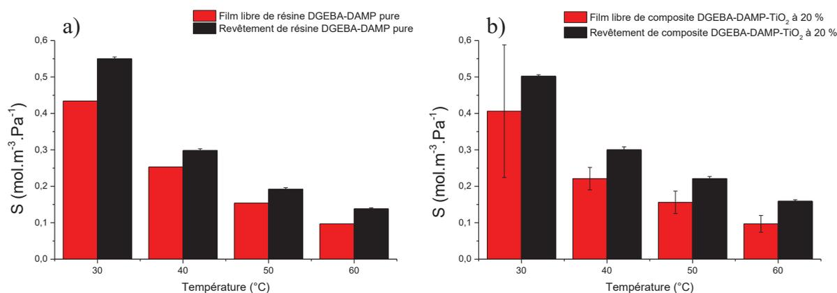
Figure 26 : Solubilités des films libres suivis par gravimétrie et des revêtements suivis par SIE pour la résine DGEBA-DAMP pure [1] (a) et pour le composite chargé à 20 % (b).
