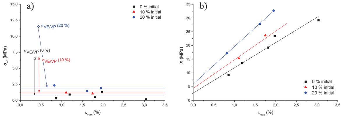
Figure 17 : Evolution de la contrainte effective  $\sigma_{eff}$  (a) et de la contrainte interne  $X$  (b).
