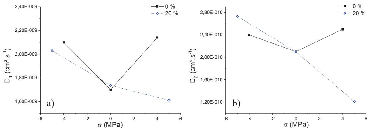
Figure 22 : Evolution des coefficients de diffusion  $D_1$  (a) et  $D_2$  (b) de la résine DGEBA-DAMP pure [1] et du composite DGEBA-DAMP-TiO<sub>2</sub> en fonction de la contrainte mécanique appliquée.
