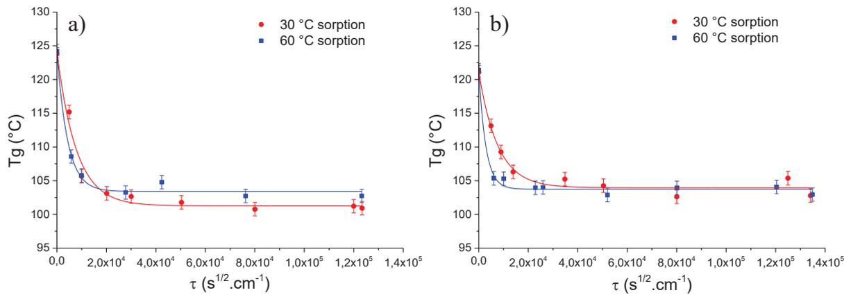
Figure 24 : Evolution de la Tg pendant la prise de en eau pour le composite chargé à 10 % (a) et à 20 % (b).
