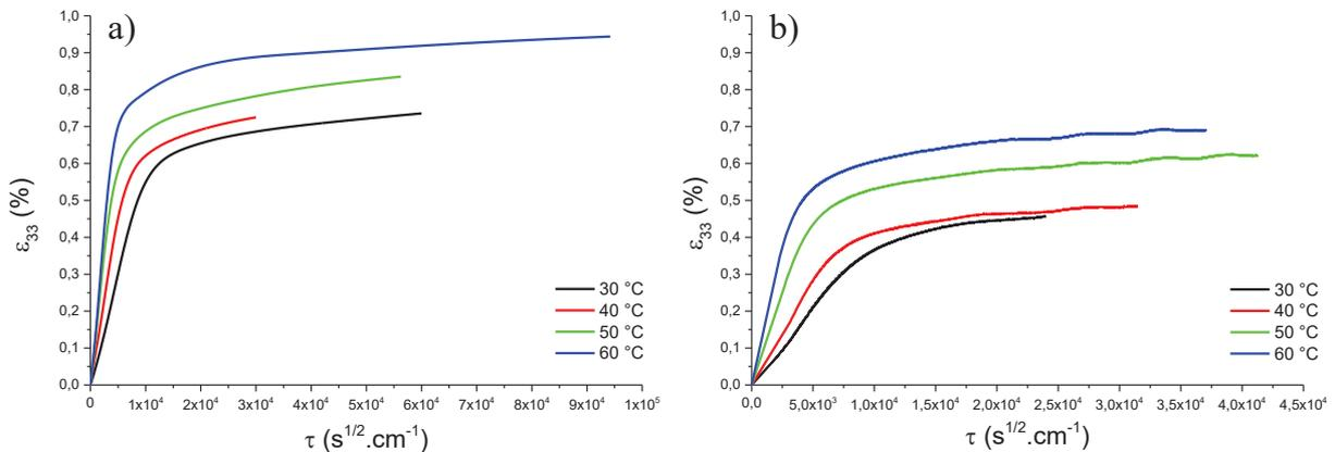
Figure 16 : Evolution de la déformation  $\varepsilon_{33}$  pour la résine DGEBA-DAMP pure (a) et pour le composite chargé à 20 % (b).
