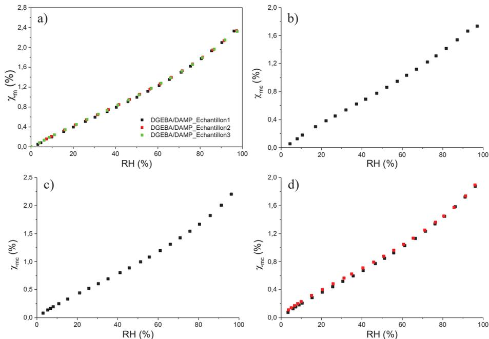
Figure 14 : Isotherme de sorption de la résine DGEBA-DAMP pure à 40 °C [1] (a), du composite chargé à 20 % à 30 °C (b), des composites chargés à 10 % (c) et à 20 % (d) à 50 °C.
