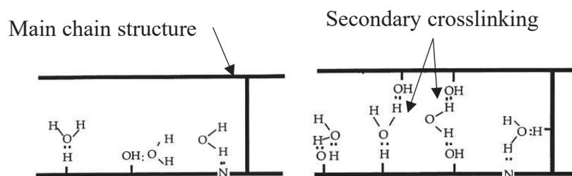
Figure 08 : Différents types d'eau liée pénétrant dans les réseaux macromoléculaires [26].
