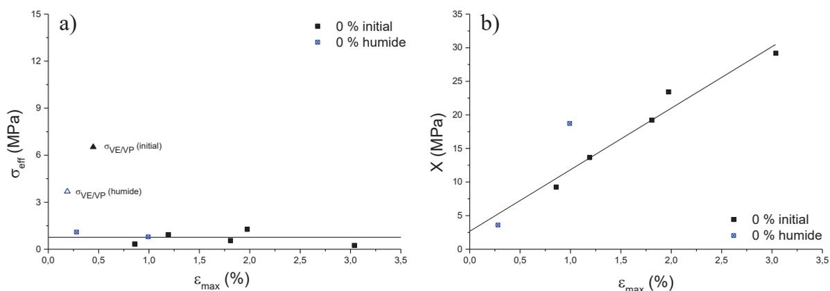
Figure 29 : Evolution de la contrainte effective  $\sigma_{\text{eff}}$  (a) et de la contrainte interne  $X$  (b) au cours du vieillissement pour la résine DGEBA-DAMP pure.
