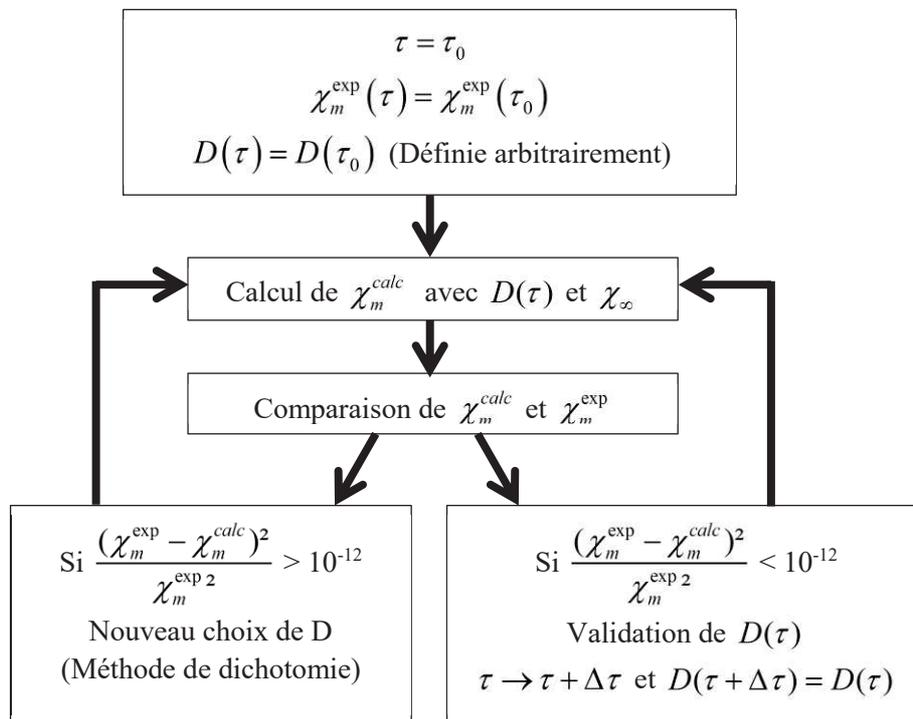
Figure 20 : Algorithme de calcul de  $D(\tau)$  au cours du vieillissement [1].
