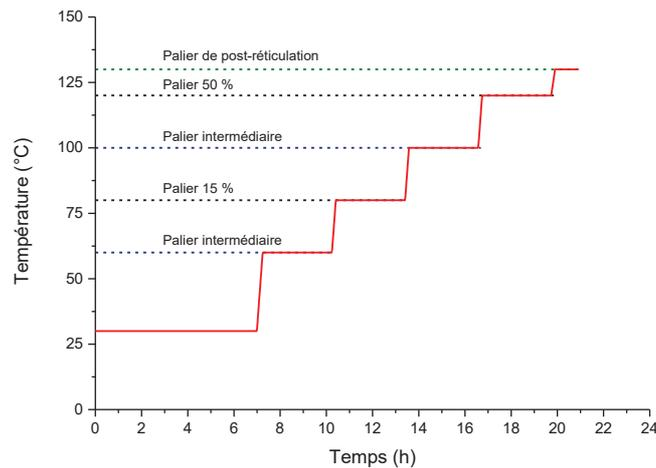
Figure 02 : Protocole de réticulation du système stœchiométrique DGEBA-DAMP [1].
