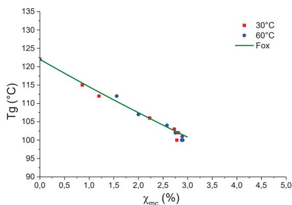
Figure 22 : Evolution de la Tg avec la teneur massique en eau pour la résine DGEBA-DAMP pure [1] pendant la prise en eau.
