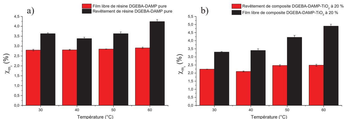
Figure 25 : Teneurs en eau à l'équilibre des films libres suivis par gravimétrie et des revêtements suivis par SIE pour la résine DGEBA-DAMP pure [1] (a) et pour le composite chargé à 20 % (b).
