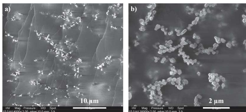
Figure 09 : Images MEB des échantillons de films libres de composites chargés à 10 % (a) et à 20 % (b).
