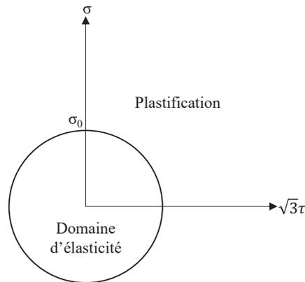
Figure 19 : Surface de charge définie par la contrainte équivalente de von Mises.
