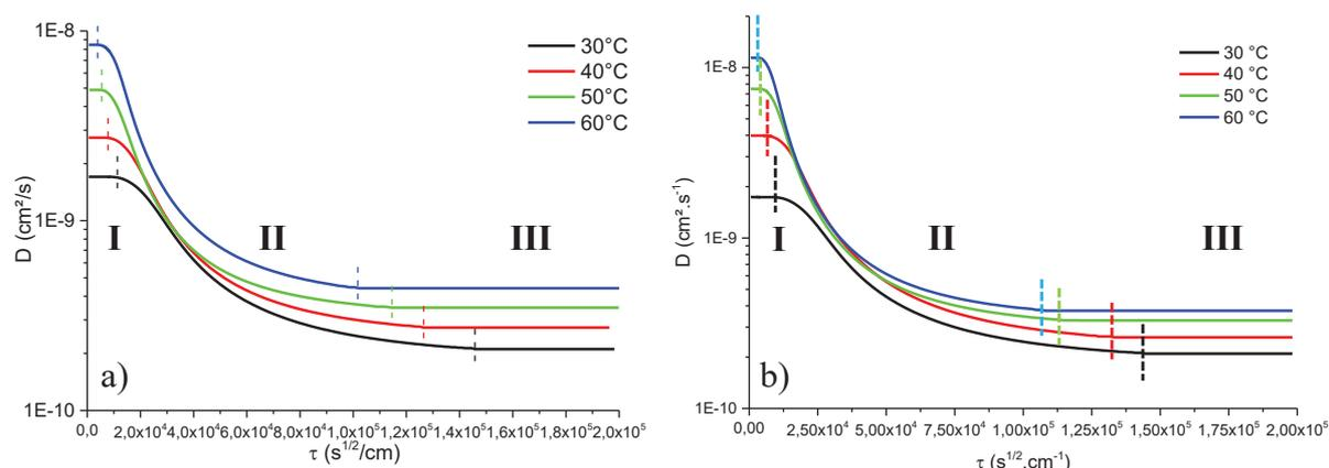
Figure 13 : Evolution du coefficient de diffusion pour la résine DGEBA-DAMP pure [1] (a) et pour le composite chargé à 20 % (b).
