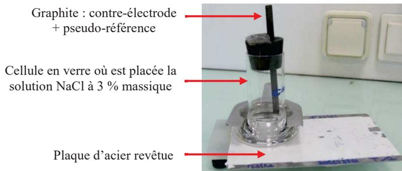
Figure 08 : Montage utilisé pour réaliser les mesures de SIE.
