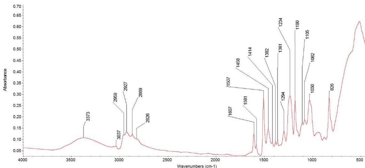
Figure 16 : Spectre IRTF de la surface extérieure du revêtement composite chargé à 20 % après prise en eau à 30 °C et désorption.
