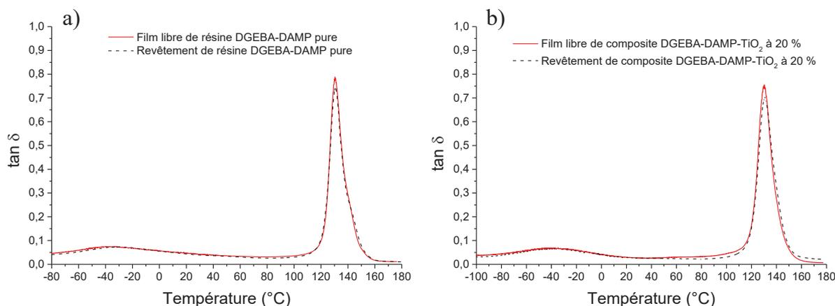
Figure 06 : Comparaison des balayages en température des films libres et des revêtements de résine DGEBA-DAMP pure [1] (a) et de composite DGEBA-DAMP-TiO<sub>2</sub> chargé à 20 % (b).
