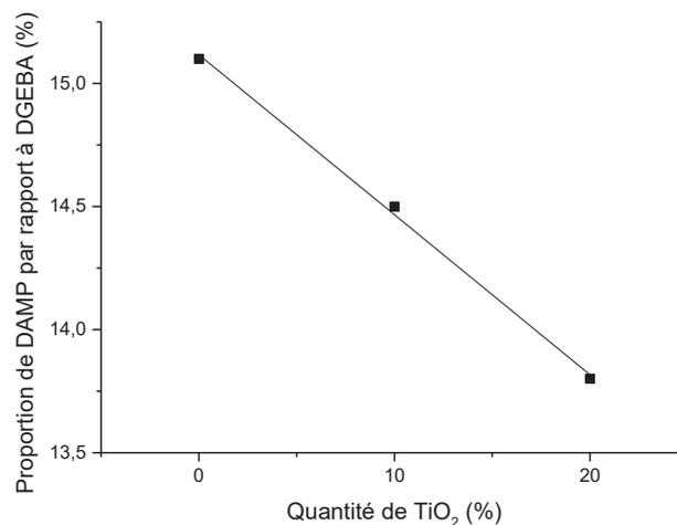
Figure 05 : Evolution de la stœchiométrie d'un mélange DGEBA-DAMP en fonction de la quantité massique de dioxyde de titane incorporée.
