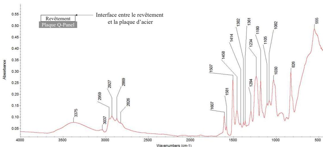
Figure 04 : Spectre IRTF de l'interface entre le substrat d'acier et le revêtement composite chargé à 20 % à l'état initial.
