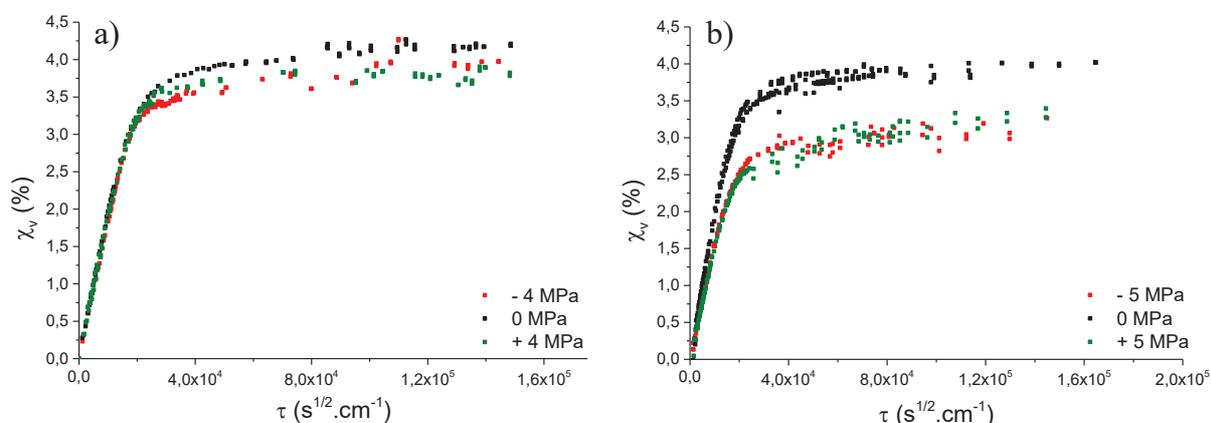
**Figure 21 :** Courbes de sorption des revêtements contraints et non contraints de résine DGEBA-DAMP pure [1] (a) et de composite chargé à 20 % (b).
