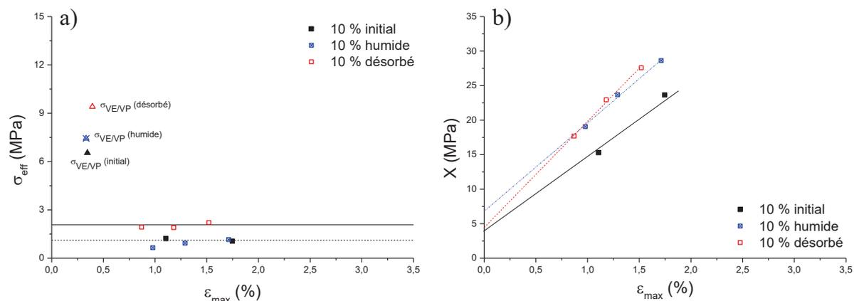
Figure 30 : Evolution de la contrainte effective  $\sigma_{\text{eff}}$  (a) et de la contrainte interne X (b) au cours du vieillissement pour le composite chargé à 10 %.
