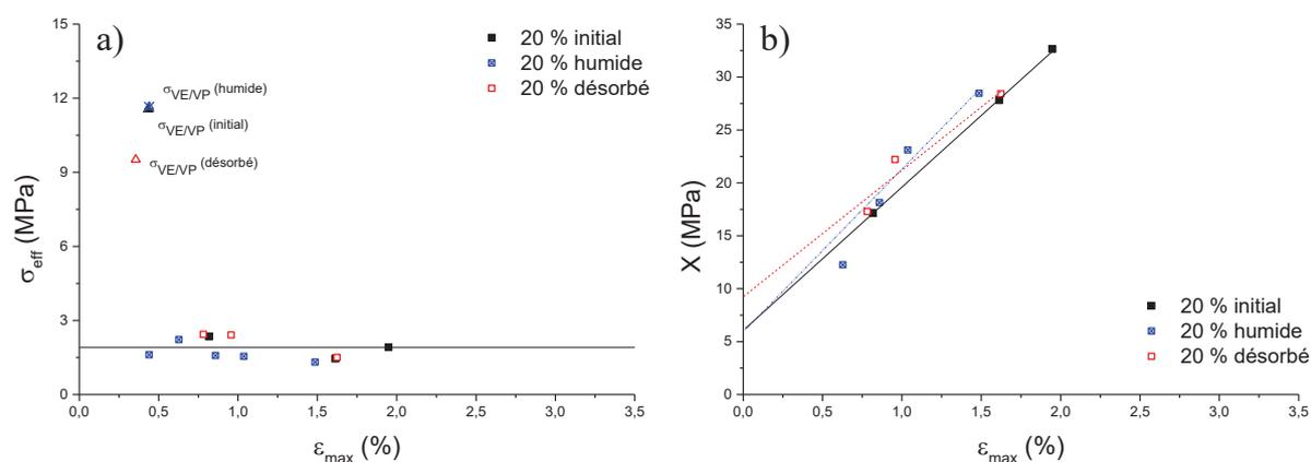
Figure 31 : Evolution de la contrainte effective  $\sigma_{\text{eff}}$  (a) et de la contrainte interne X (b) au cours du vieillissement pour le composite chargé à 20 %.
