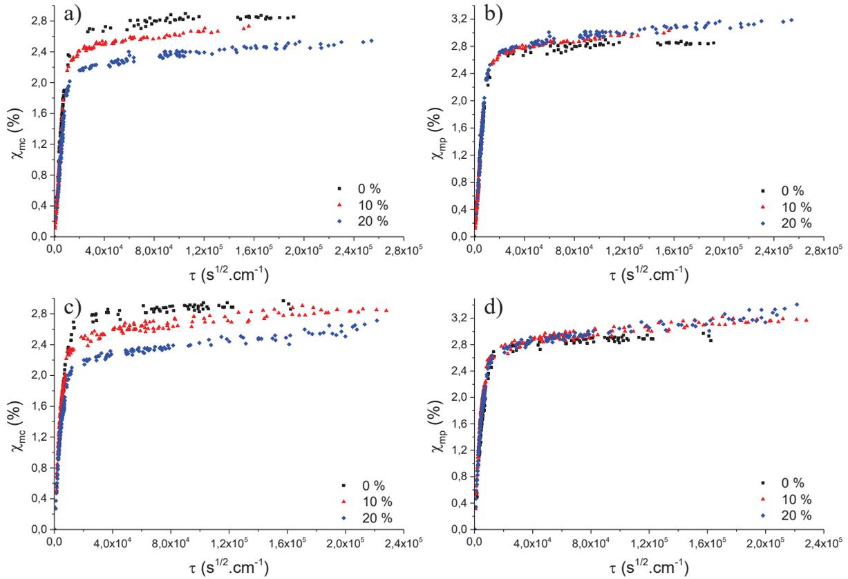
Figure 17 : Comparaison des prises en eau suivant le taux de dioxyde de titane à 50 °C (a) et (b) et à 60 °C (c) et (d).
