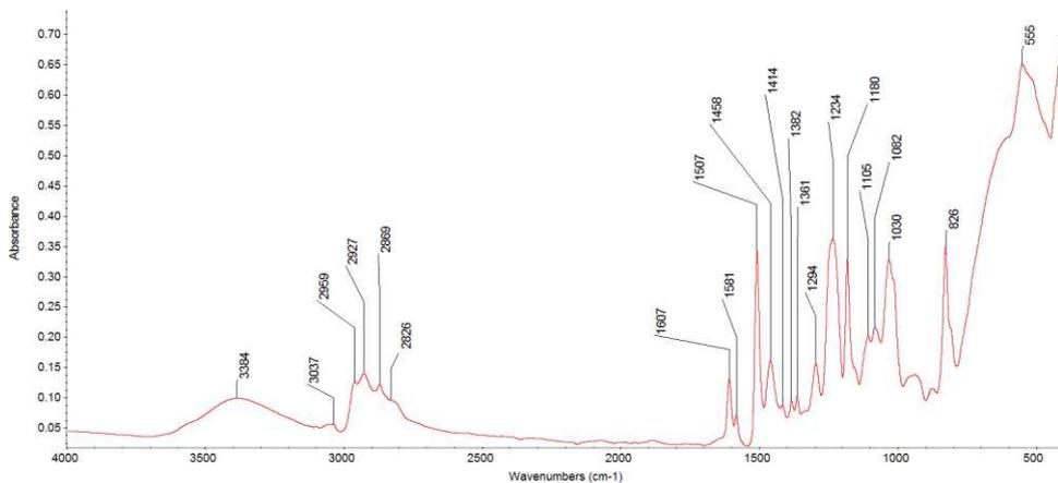
Figure 12 : Spectre IRTF du composite DGEBA-DAMP-TiO<sub>2</sub> chargé à 20 %.
