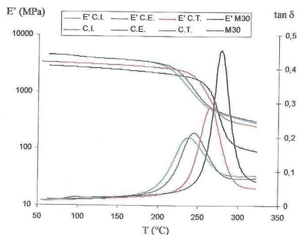
Figure 15 : Evolution de  $E'$  et  $\tan \delta$  pour des composites cyanate / fibres de verre D [84].
