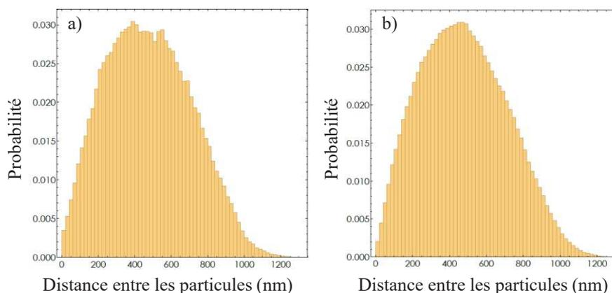
Figure 08 : Distance entre les particules pour les composites chargés à 10 % (a) et à 20 % (b).
