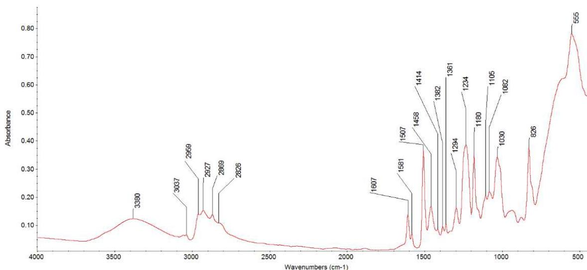
Figure 15 : Spectre IRTF de l'interface entre le substrat d'acier et le revêtement composite chargé à 20 % après prise en eau à 30 °C et désorption.
