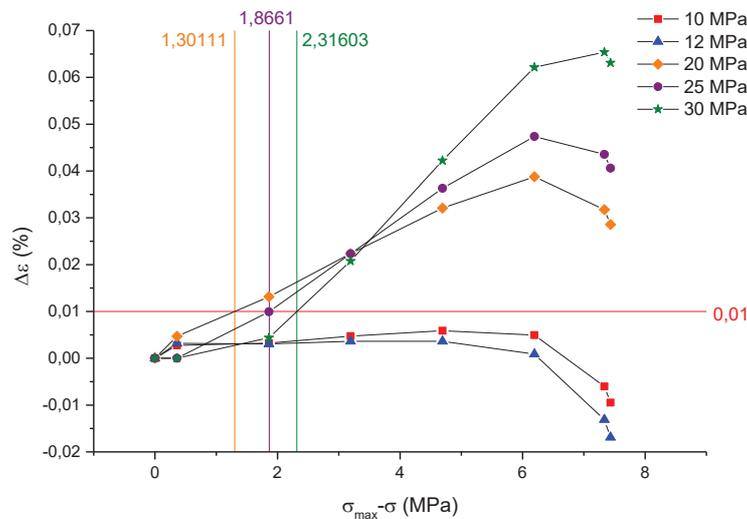
Figure 16 : Détermination du diamètre du domaine élastique  $\alpha$ .
