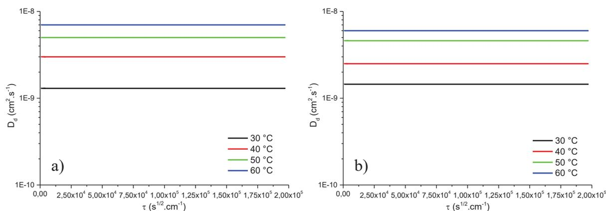
Figure 11 : Evolution du coefficient de diffusion en désorption  $D_d$  pour les composites chargés à 10 % (a) et à 20 % (b).
