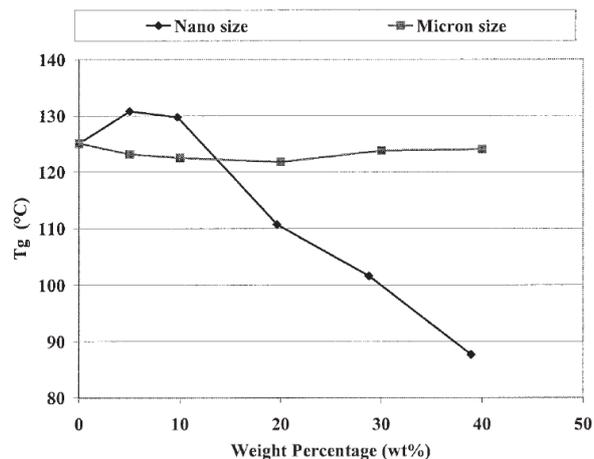
Figure 13 : Evolution de la T<sub>g</sub> des composites en fonction de la proportion de silice [78].
