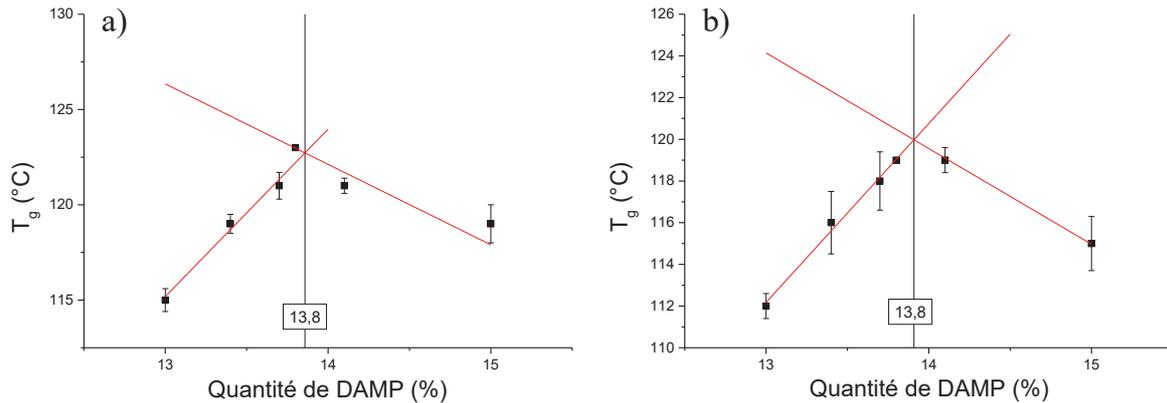
Figure 04 : Détermination de la stœchiométrie pour des mélanges chargés à 20 % en dioxyde de titane en seconde montée en température (a) et en refroidissement (b).
