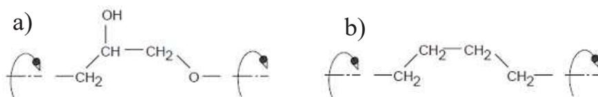
Figure 14 : Mouvement de vilebrequin des unités hydroxypropyléther (a) et de rotation des unités  $\text{CH}_2$  (b) [32].
