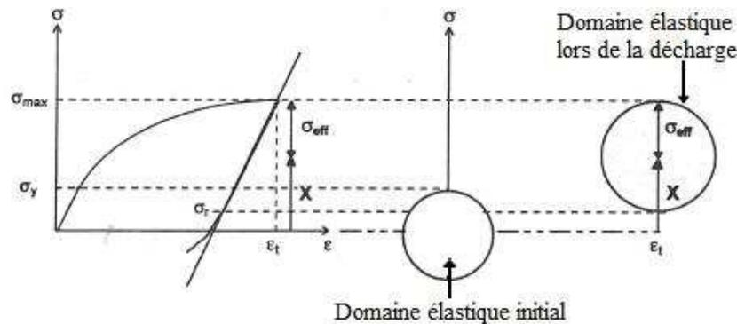
Figure 21 : Evolution des domaines élastiques lors d'un essai de charge-décharge [95].
