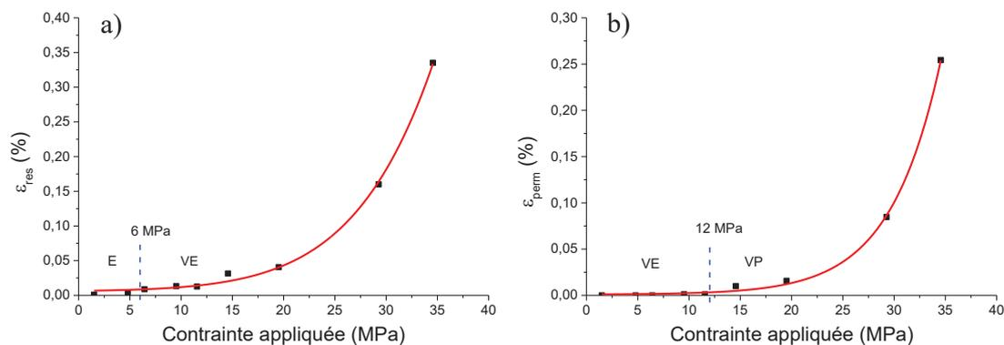
Figure 15 : Evolution des déformations résiduelle (a) et permanente (b) pour le composite chargé à 20 %.
