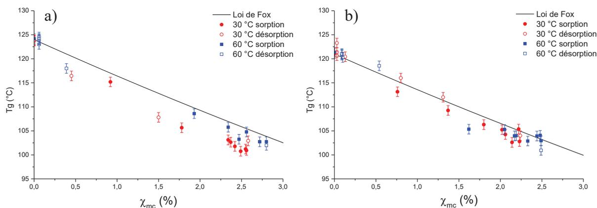
Figure 27 : Evolution de la Tg avec la teneur massique en eau pour les composites chargés à 10 % (a) et à 20 % (b).
