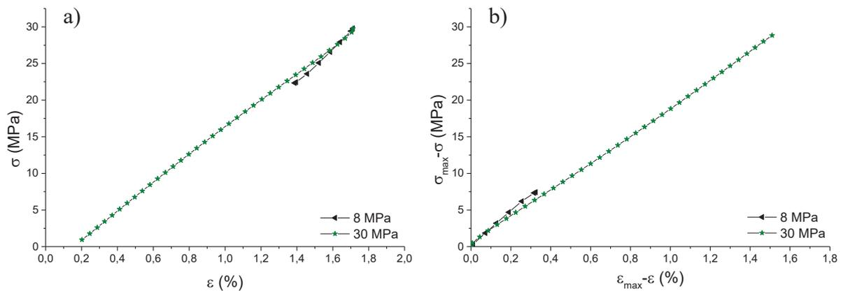
Figure 03 : Translation de la courbe de décharge de la limite des domaines viscoélastique et viscoplastique (a) et retournement des décharges (b).
