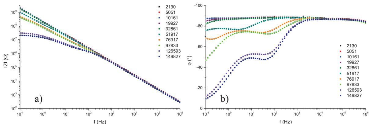
Figure 10 : Diagramme de Bode : module d'impédance (a) et phase (b).
