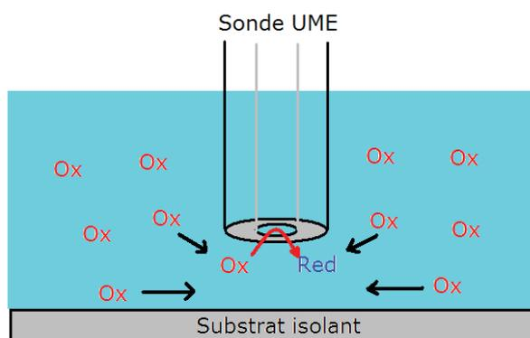
Figure 31 : Fonctionnement du SECM en mode « negative feedback » [28].
