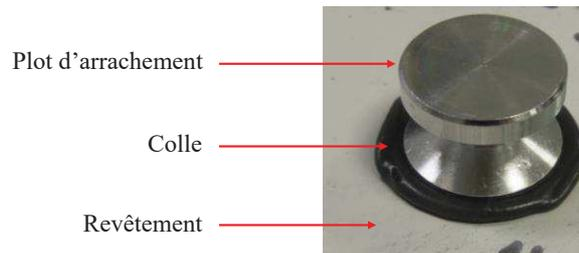
Figure 01 : Plot collé sur un revêtement pour le test d'arrachement.
