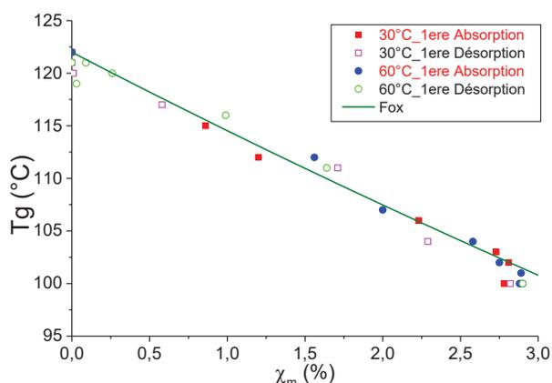
Figure 26 : Evolution de la Tg avec la teneur massique en eau pour la résine DGEBA-DAMP pure [1].
