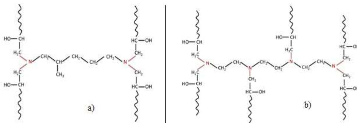
Figure 10 : Motif élémentaire idéal des systèmes DGEBA-DAMP (a) et DGEBA-TETA (b) [3].
