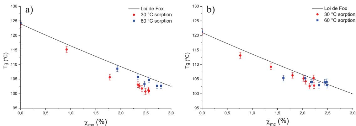
Figure 23 : Evolution de la Tg avec la teneur massique en eau pour les composites chargés à 10 % (a) et à 20 % (b) pendant la prise en eau.
