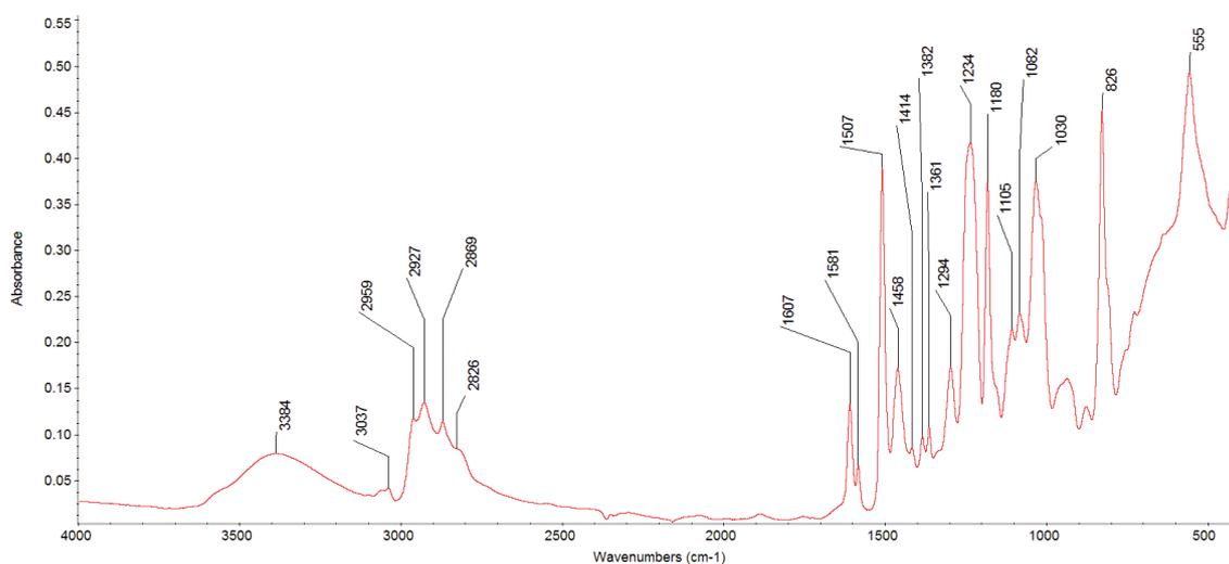
Figure 10 : Spectre IRTF du composite DGEBA-DAMP-TiO<sub>2</sub> chargé à 10 %.
