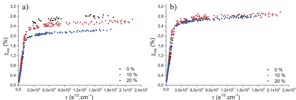
Figure 05 : Comparaison des prises en eau en fonction du taux de dioxyde de titane suivant les équations (04) (a) et (05) (b) à 30 °C.
