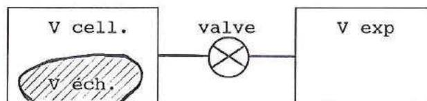
Figure 01 : Composition d'un pycnomètre à Hélium.
