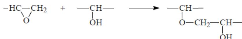
**Figure 06 :** Homopolymérisation des cycles époxy [10].
