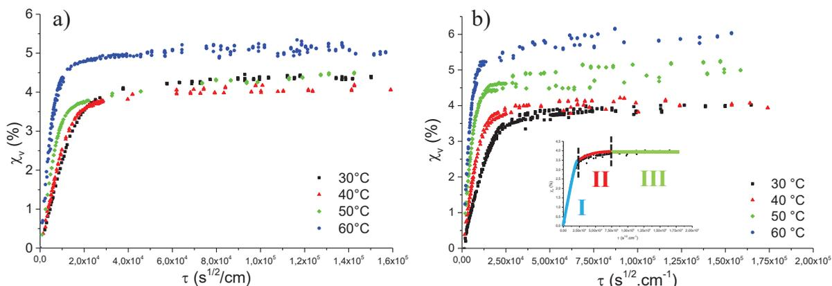
Figure 12 : Courbes de prise en eau des revêtements de résine DGEBA-DAMP pure [1] (a) et de composite DGEBA-DAMP-TiO<sub>2</sub> chargé à 20 % (b).
