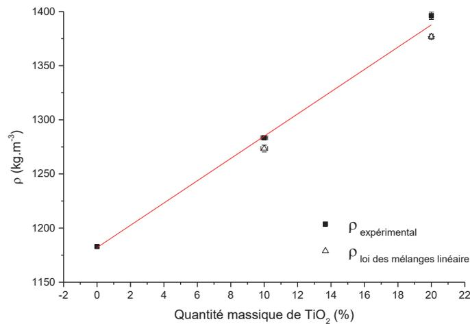
Figure 11 : Evolution de la masse volumique suivant le taux de dioxyde de titane et comparaison avec la loi des mélanges linéaire.
