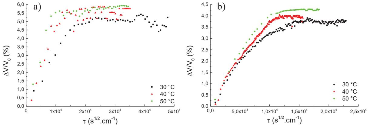
Figure 33 : Evolution du gonflement des revêtements de résine DGEBA-DAMP pure [1] (a) et de composite DGEBA-DAMP-TiO<sub>2</sub> chargé à 20 % (b) par SECM.
