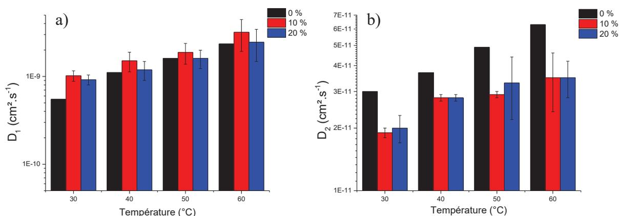
Figure 10 : Coefficients de diffusion  $D_1$  (a) et  $D_2$  (b) de la résine DGEBA-DAMP pure [1] et des composites DGEBA-DAMP-TiO<sub>2</sub>.
