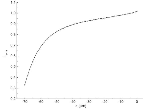
Figure 32 : Courbe d'approche obtenue sur un revêtement de résine pure dans une solution à 30 °C.
