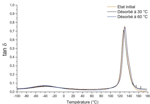
Figure 28 : Evolution du facteur d'amortissement  $\tan \delta$  pour le composite chargé à 20 % à l'état initial, après un cycle de vieillissement à 30 °C et après un cycle à 60 °C.
