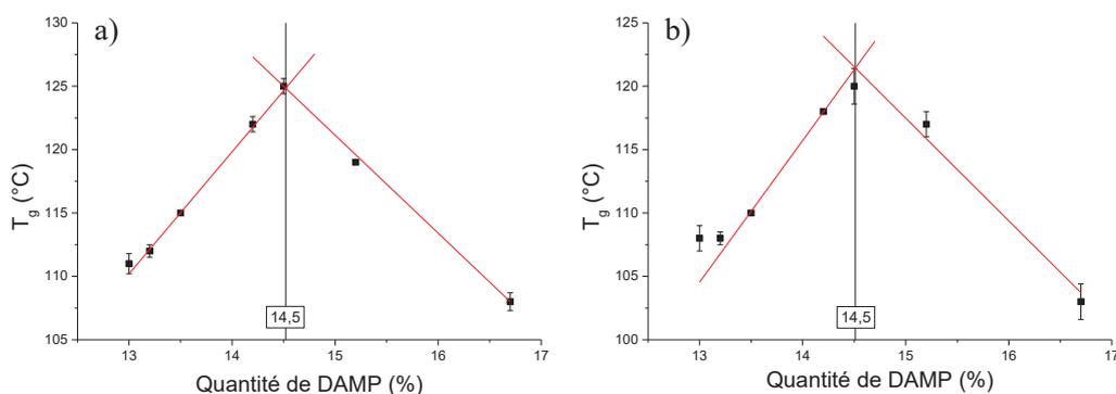
Figure 03 : Détermination de la stœchiométrie pour des mélanges chargés à 10 % en dioxyde de titane en seconde montée en température (a) et en refroidissement (b).
