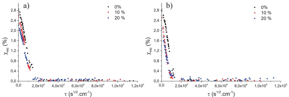
Figure 18 : Comparaison des évolutions de proportion d'eau en suivant le taux de dioxyde de titane à 30 °C (a) et 40 °C (b).
