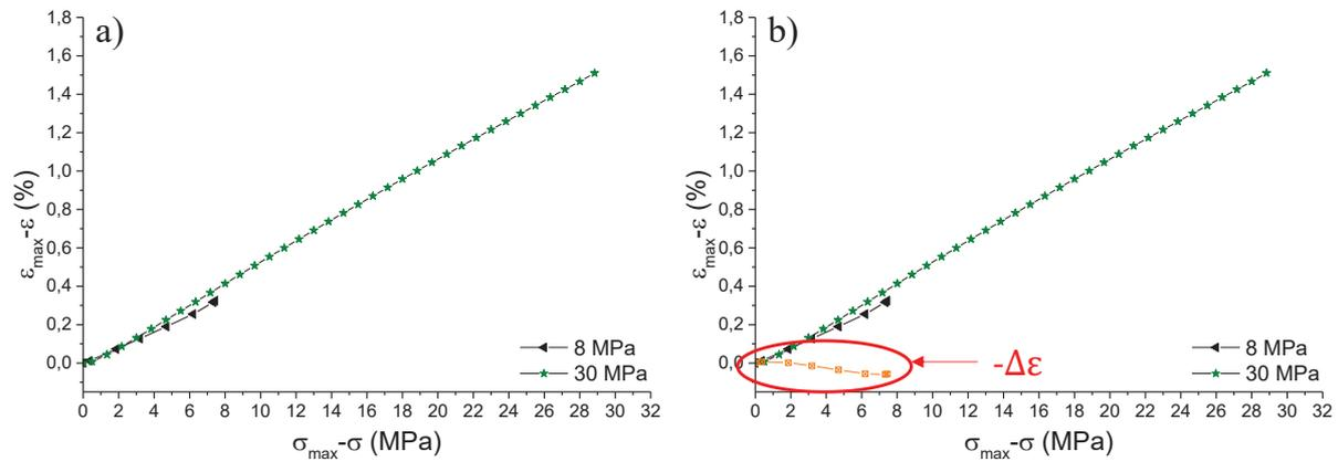
Figure 04 : Inversion des axes pour pouvoir effectuer la soustraction des courbes de décharge (a) et détermination de  $-\Delta\epsilon$  (b).
