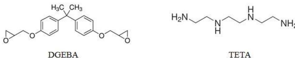
Figure 08 : Structure des composés de la résine DGEBA-TETA [46].
