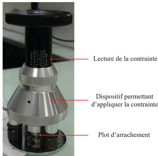
Figure 02 : Dispositif utilisé pour les tests d'arrachement.
