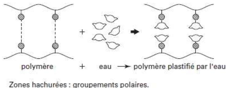
Figure 26 : Rupture des liaisons secondaires du réseau macromoléculaire par les molécules d'eau [145].
