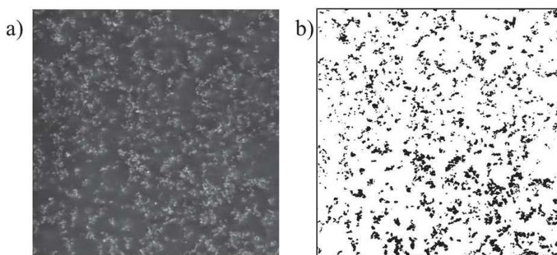
Figure 09 : Image MEB avant (a) et après (b) binarisation pour un échantillon chargé à 20 %.
