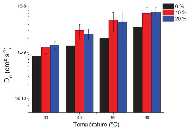
Figure 12 : Coefficients de diffusion  $D_d$  de la résine DGEBA-DAMP pure [1] et des composites DGEBA-DAMP-TiO<sub>2</sub>.
