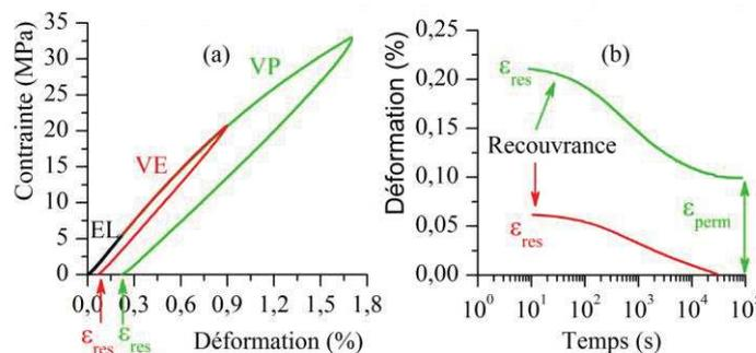
Figure 20 : Courbes obtenues pour des essais de charge-décharge-recouvrance [46].
