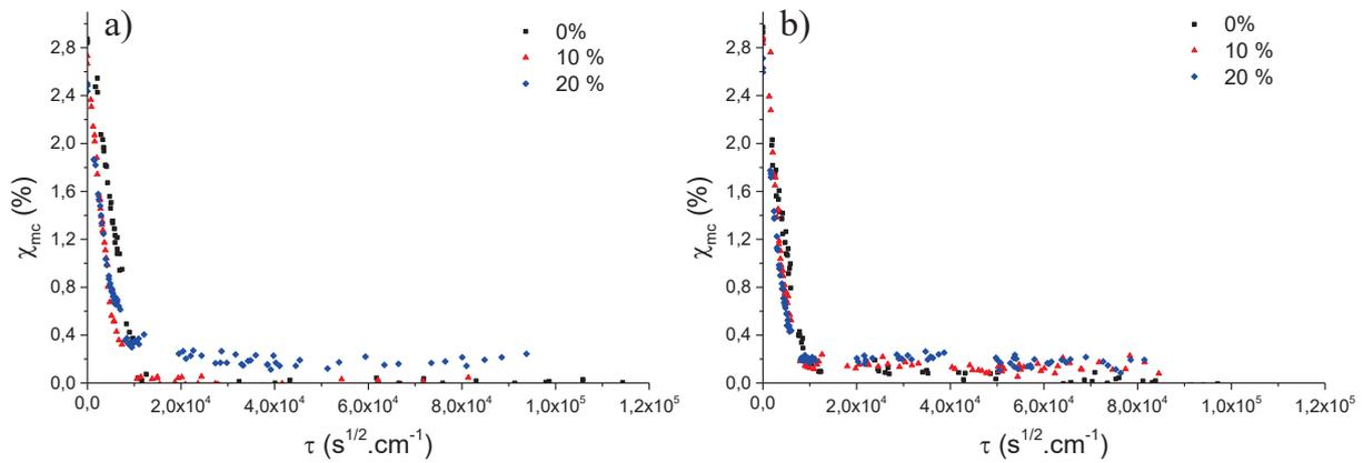
Figure 19 : Comparaison des évolutions de proportion d'eau en suivant le taux de dioxyde de titane à 30 °C (a), 40 °C (b), 50 °C (c) et 60 °C (d).
