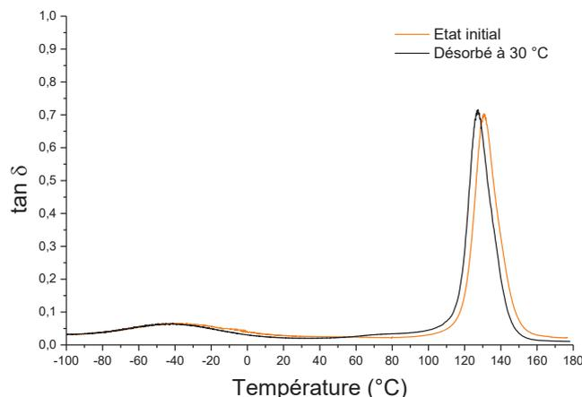
Figure 17 : Evolution du facteur d'amortissement  $\tan \delta$  pour le revêtement de composite chargé à 20 % à l'état initial et après un cycle à 30 °C constitué d'une prise en eau et d'une désorption.
