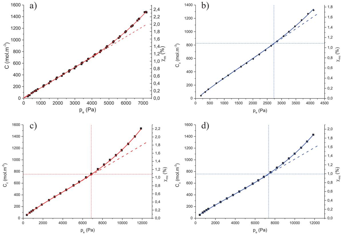
Figure 15 : Evolution des concentrations et des teneurs en eau à l'équilibre pour la résine DGEBA-DAMP pure à 40 °C [1] (a), du composite chargé à 20 % à 30 °C (b), des composites chargés à 10 % (c) et à 20 % (d) à 50 °C.
