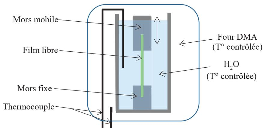
Figure 14 : Montage DMA en immersion [1].
