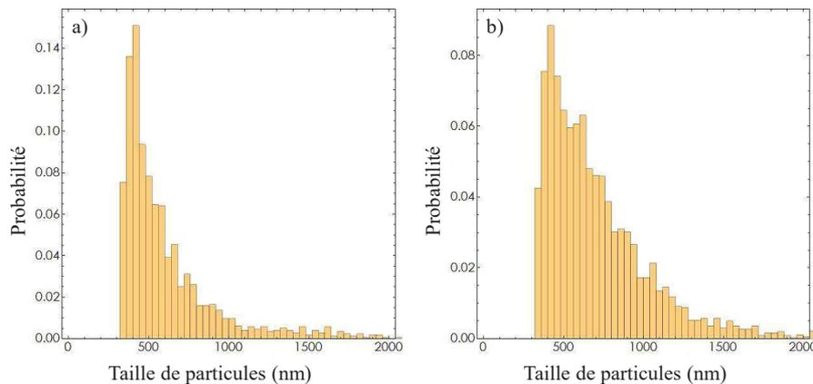
Figure 07 : Répartition de taille de particules pour les composites chargés à 10 % (a) et à 20 % (b).
