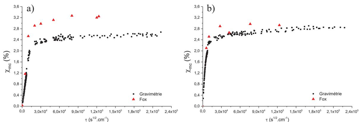
Figure 24 : Comparaison entre la prise en eau calculée par la loi de Fox et les mesures de gravimétrie pour le composite chargé à 10 % à 30 °C (a) et à 60 °C (b).
