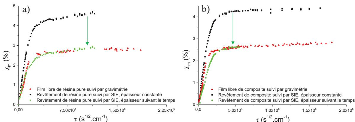
Figure 34 : Courbes de sorption en tenant compte du gonflement des revêtements pour la résine DGEBA-DAMP pure (a) et pour le composite chargé à 20 % (b).
