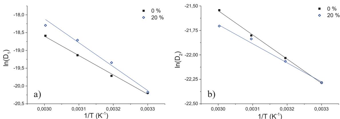
Figure 18 : Evolution des coefficients  $D_1$  (a) et  $D_2$  (b) en fonction de l'inverse de la température.
