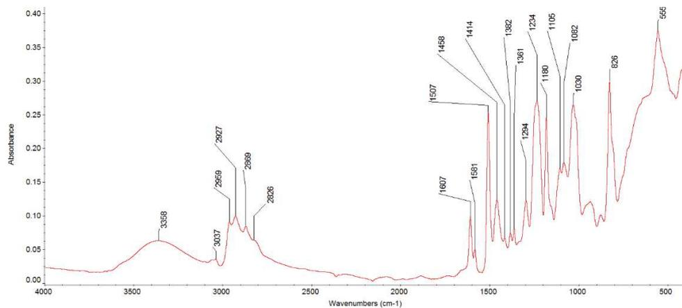
Figure 23 : Spectre IRTF du composite chargé à 10 % à l'état désorbé après un cycle sorption-désorption à 60 °C.
