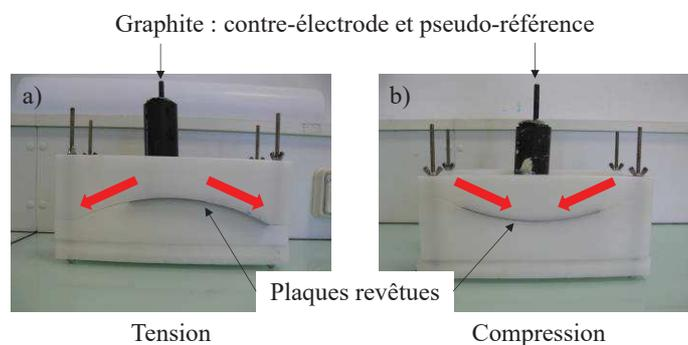
Figure 20 : Montages permettant d'appliquer une contrainte en tension (a) et en compression (b) aux plaques.
