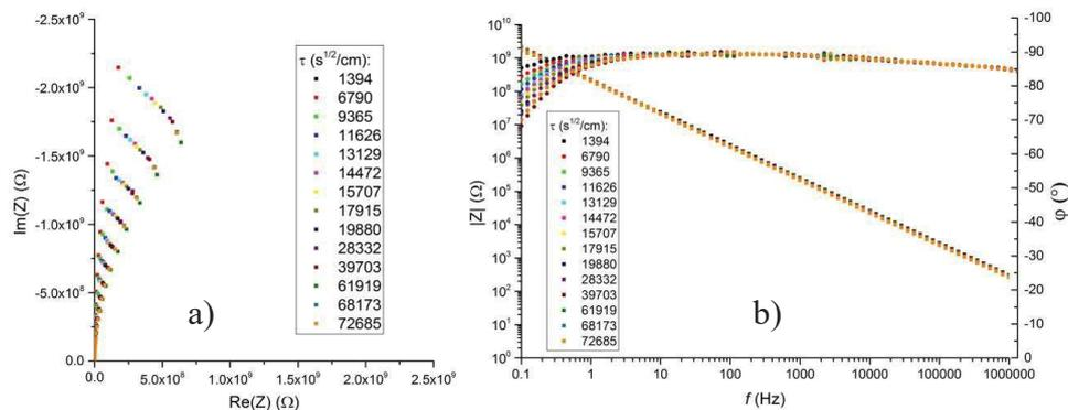
Figure 29 : Diagrammes de Nyquist (a) et de Bode (b) obtenus pour un revêtement DGEBA-DAMP [3].
