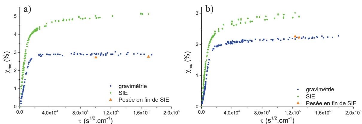
**Figure 30 :** Courbes de sorption à 30 °C obtenues en gravimétrie et en SIE sur des films libres de résine DGEBA-DAMP pure (a) et de composite DGEBA-DAMP-TiO<sub>2</sub> (b).
