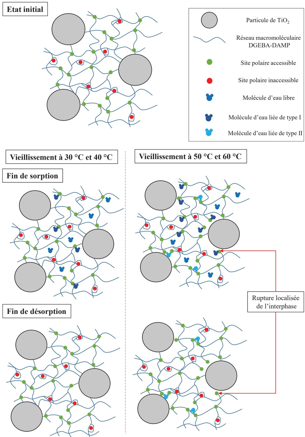
Figure 39 : Scénario de vieillissement des composites.
