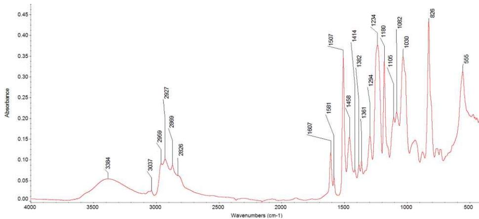
Figure 11 : Spectre IRTF de la résine DGEBA-DAMP pure.
