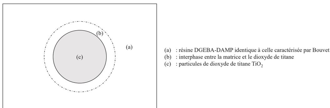
Figure 35 : Structure classique d'un composite à matrice polymère autour d'une particule.
