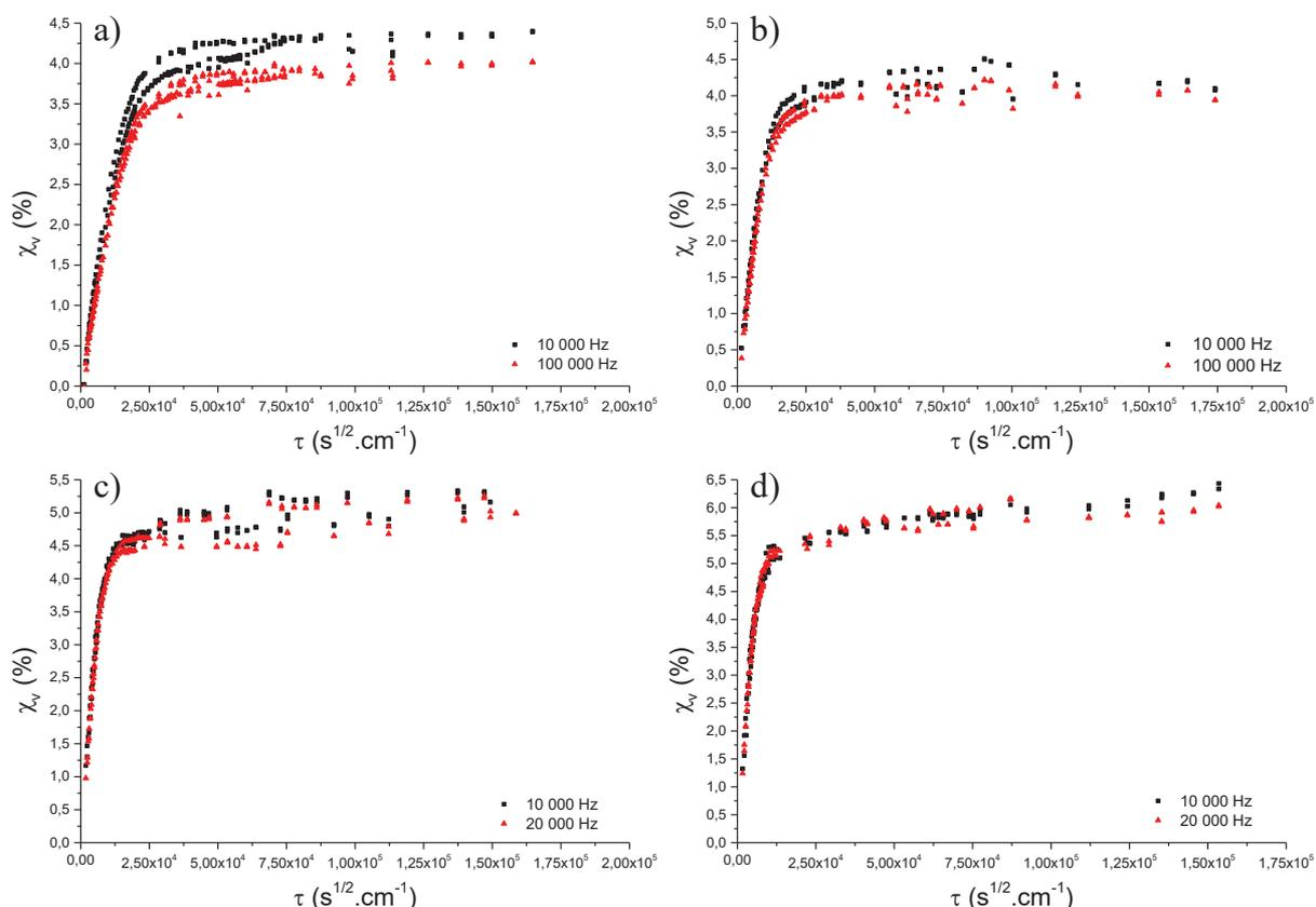
Figure 11 : Impact de la fréquence utilisée sur la prise en eau des revêtements composites à 30 °C (a), 40 °C (b), 50 °C (c) et 60 °C (d).
