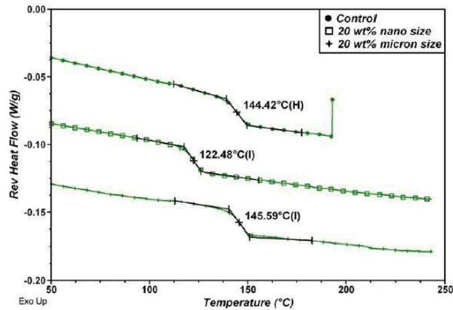
Figure 12 : Thermogrammes de composites composés de silice et de résine DGEBA-HMPA [78].
