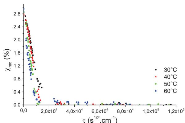
Figure 06 : Courbes de désorption de la résine DGEBA-DAMP pure [1].
