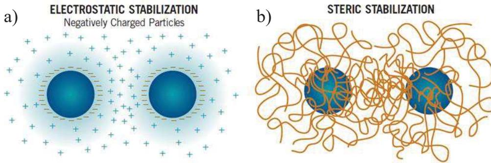
Figure 11 : Stabilisations électrostatique (a) et stérique (b) des particules [59].
