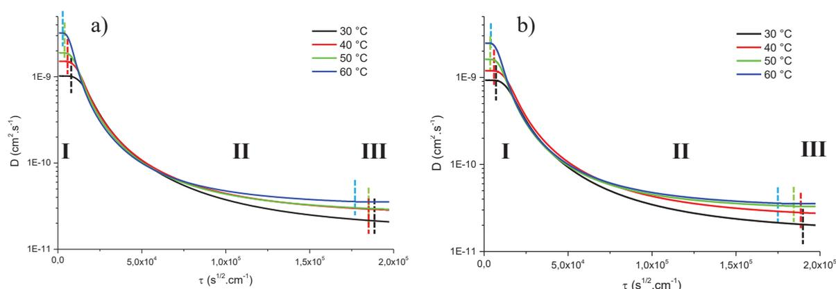
Figure 09 : Evolution du coefficient de diffusion pour les composites chargés à 10 % (a) et à 20 % (b).
