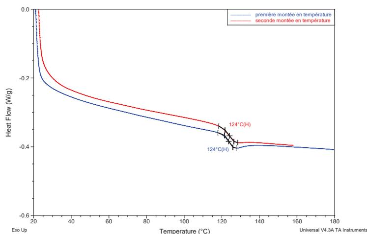
Figure 12 : Thermogramme obtenu pour un composite chargé à 10 %.
