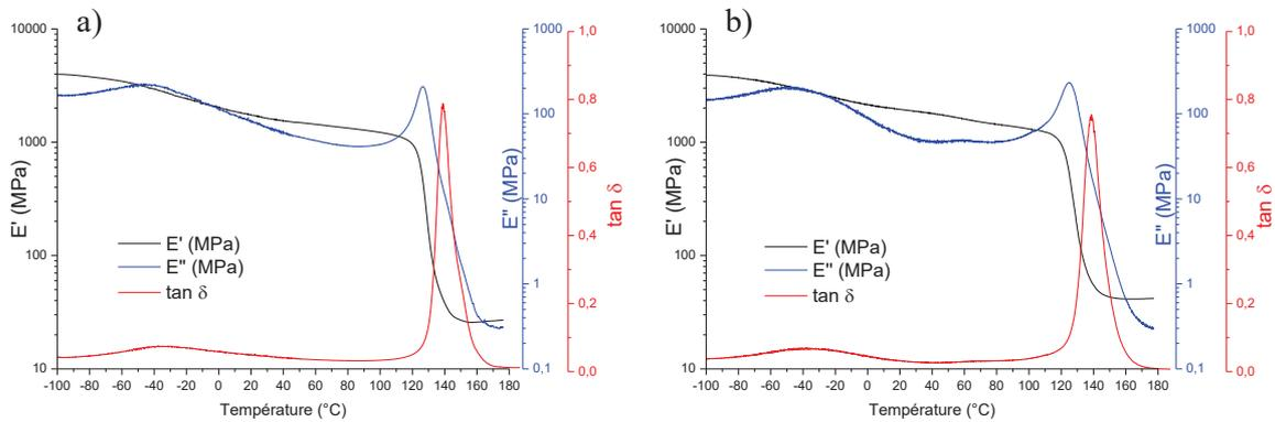
Figure 13 : Evolution du module de conservation  $E'$ , du module de perte  $E''$  et du facteur d'amortissement  $\tan \delta$  pour la résine DGEBA-DAMP pure [1] (a) et pour le composite chargé à 20 % (b).
