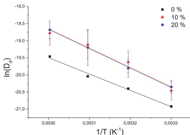
Figure 33 : Evolution du coefficient  $D_d$  en fonction de l'inverse de la température.
