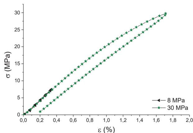
**Figure 02 :** Cycle charge-décharge pour une contrainte viscoplastique et pour la contrainte à la limite des domaines viscoélastique et viscoplastique.
