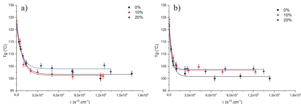
Figure 21 : Evolution de la  $T_g$  au cours de la prise en eau à 30 °C (a) et à 60 °C (b).
