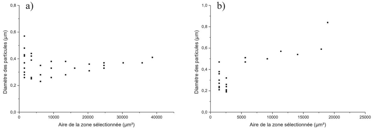
Figure 10 : Evolution de la taille des particules en fonction de la taille de la zone étudiée pour des échantillons chargés à 10 % (a) et à 20 % (b).
