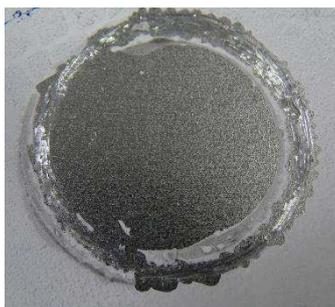
Figure 03 : Revêtement de composite décollé après le test d'arrachement.
