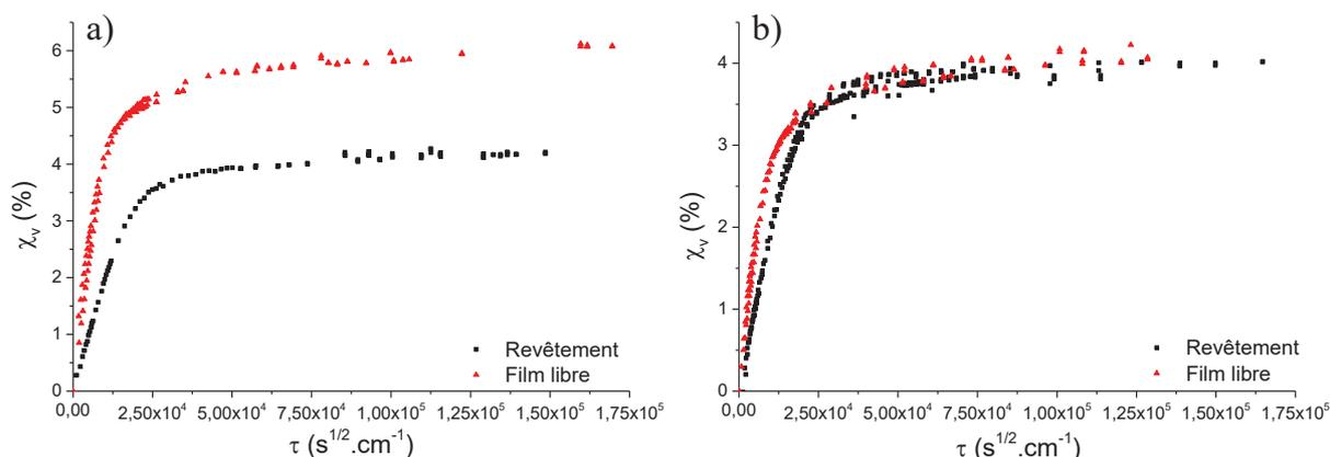
Figure 29 : Courbes de prise en eau à 30 °C obtenues par SIE des revêtements et des films libres de résine DGEBA-DAMP pure (a) et de composite DGEBA-DAMP-TiO<sub>2</sub> (b).
