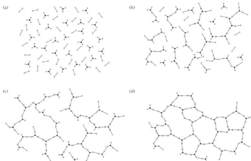
**Figure 05 :** Formation du réseau tridimensionnel [32] : (a) composés n'ayant pas réagi, (b) croissance linéaire et branchement des chaînes, (c) formation d'un gel, (d) produit complètement réticulé.
