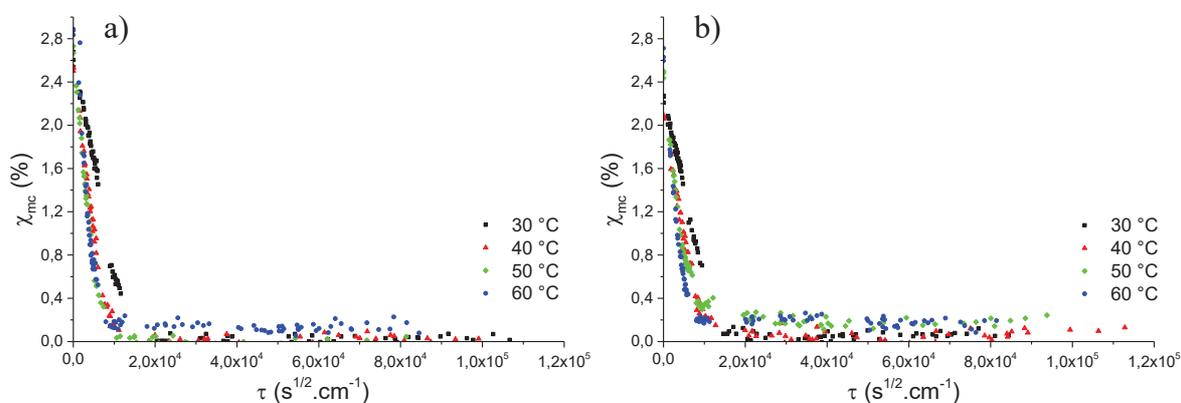
Figure 07 : Courbes de désorption des composites à 10 % (a) et à 20 % (b).
