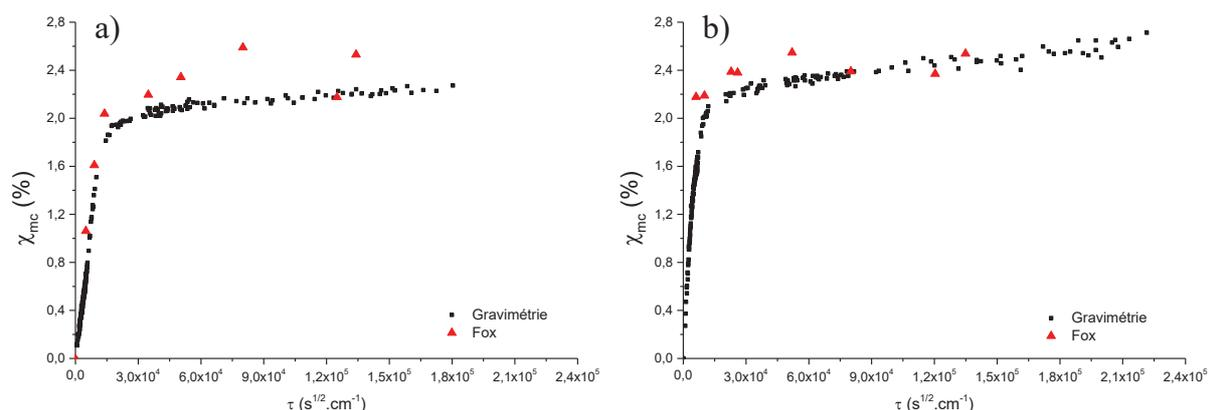
Figure 25 : Comparaison entre la prise en eau calculée par la loi de Fox et les mesures de gravimétrie pour le composite chargé à 20 % à 30 °C (a) et à 60 °C (b).
