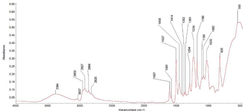
Figure 19 : Spectre IRTF du composite chargé à 20 % à l'état désorbé après un cycle sorption-désorption à 30 °C.
