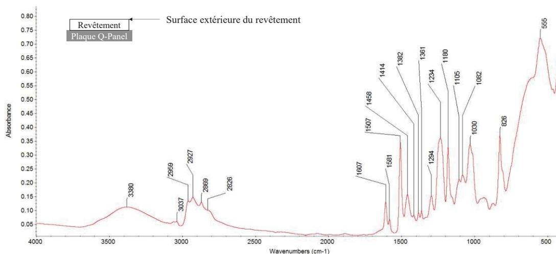
Figure 05 : Spectre IRTF de la surface extérieure du revêtement composite chargé à 20 % à l'état initial.
