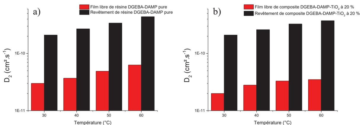
Figure 24 : Coefficients de diffusion  $D_2$  des films libres suivis par gravimétrie et des revêtements suivis par SIE pour la résine DGEBA-DAMP pure [1] (a) et pour le composite chargé à 20 % (b).
