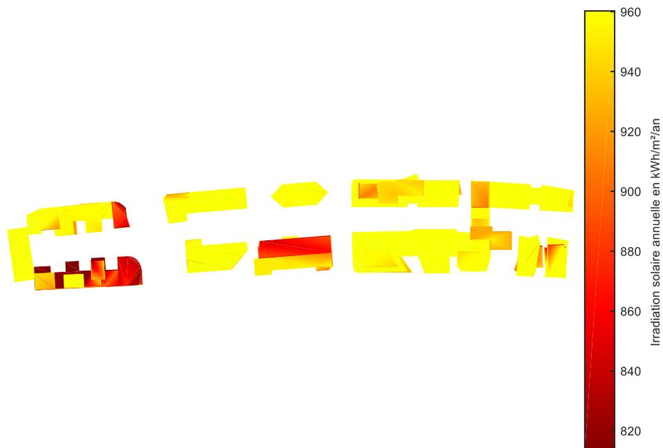
Figure 3.8. Irradiation solaire reçue pour les différentes toitures d'un quartier
