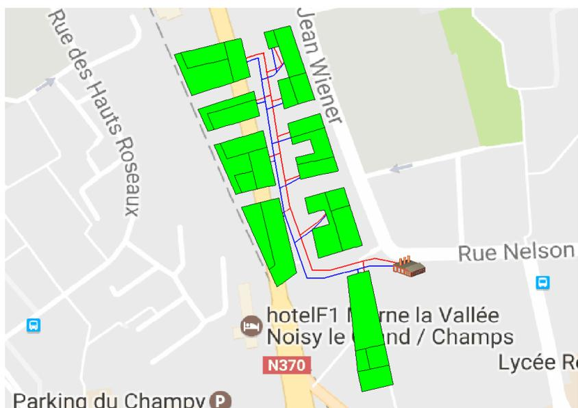
Figure 3.19. Représentation du réseau thermique initial optimal (étape 3)
