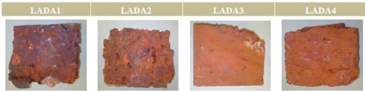
*Figure II-11 : Échantillons bruts des différentes strates de latérite de la carrière de Dano*
