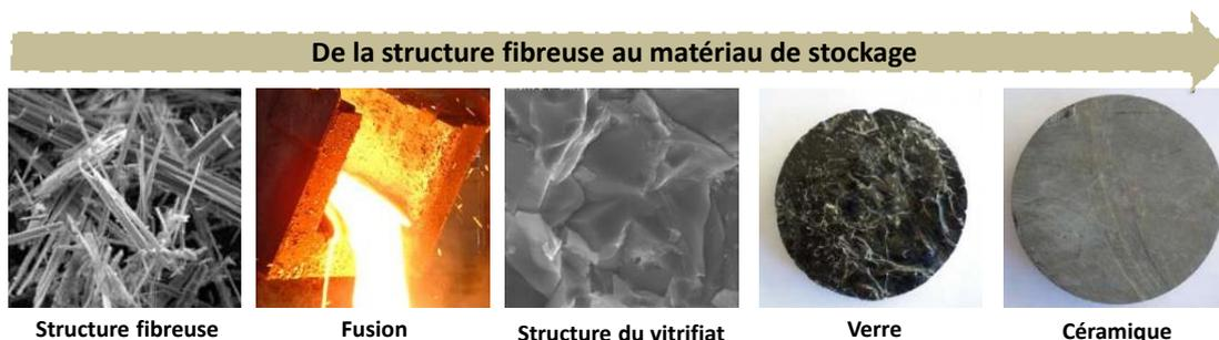
*Figure I-13 : Processus d'élaboration de céramique réfractaires à partir de l'amiante*
