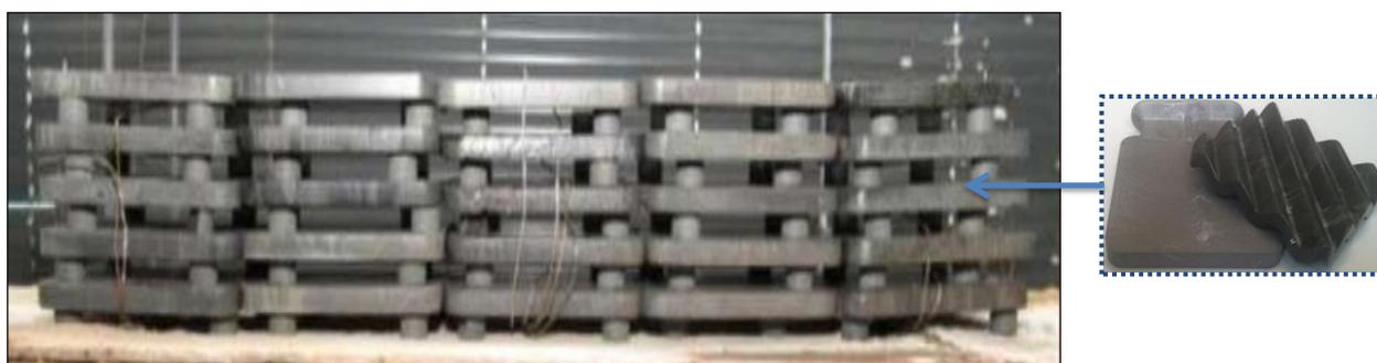
*Figure I-14 : Vue d'ensemble du module de stockage thermique utilisant des céramiques élaborées à partir d'amiante.*
