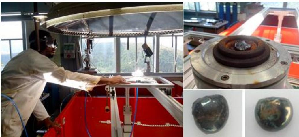
**Figure IV-10: Fusion des échantillons (gauche) et creuset avec les vitrifiés (droite)**
