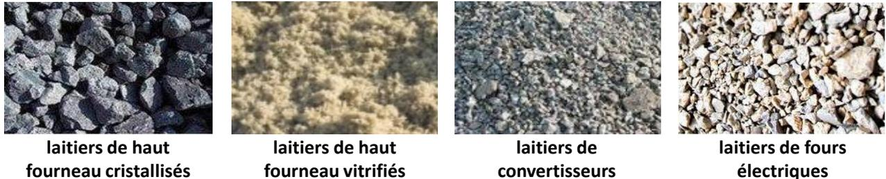
*Figure I-16 : Vue des différents types de laitiers*
