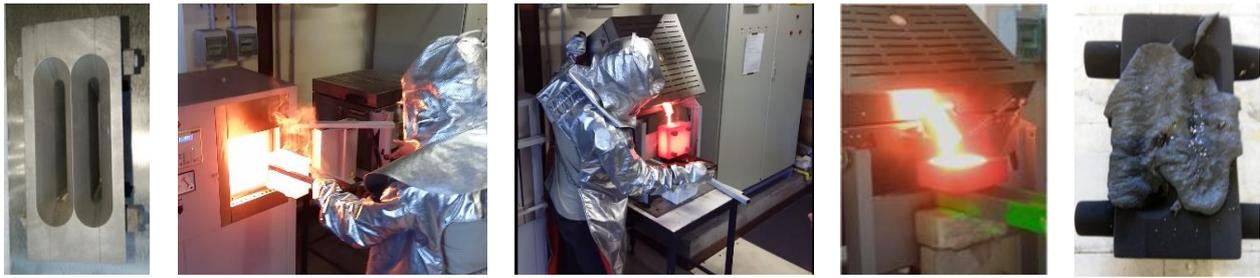
*Figure IV-41 : Procédé d'élaboration de module de stockage par la méthode petrurgique*
