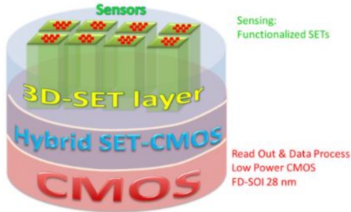
Figure E.1 Concept de l'intégration 3D de circuits hybrides SET-CMOS et capteurs chimique à base de SET [1].
