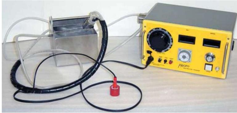
Figure 2-6 : Machine d'électro-polissage
