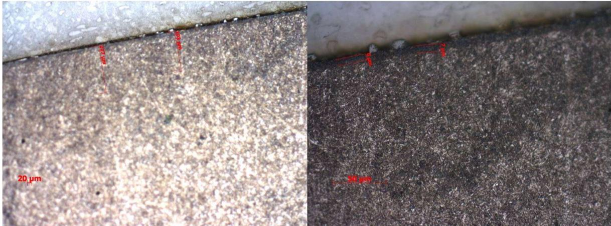
Figure 2-22: Micrographie optique de l'AISI 4140 montrant la profondeur de brunissage.
