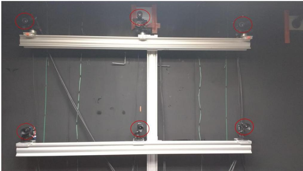
Fig. 37. Exemple d'un système à 6 caméras : premier système à 3 caméras en haut et le deuxième en bas.
