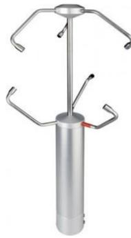
Fig. 2. Capteur d'un anémomètre à ultrasons.
