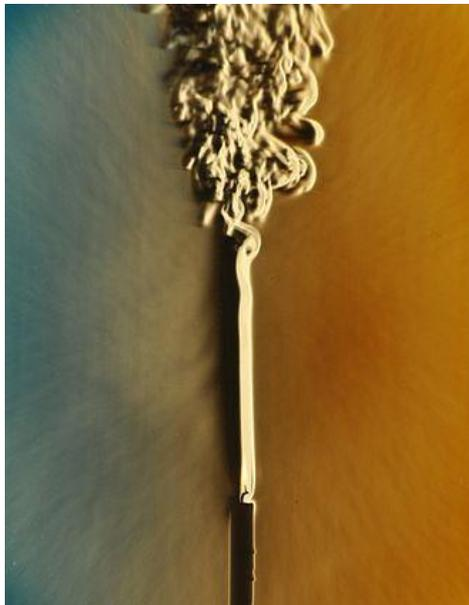
Fig. II. Transition laminaire – turbulent au-dessus de la flamme d'une bougie
