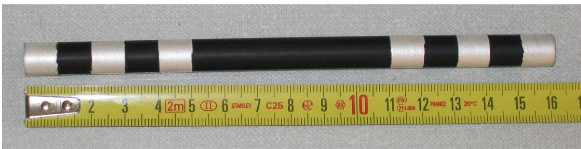
Figure 3.1 : Photo de l'amenée de courant \text{Bi}_{1.8}\text{Pb}_{0.26}\text{Sr}_2\text{Ca}_2\text{Cu}_3\text{O}_{10+x} étudiée.
