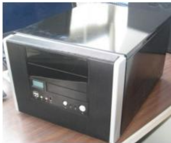
Figure 2.1 : Prototype de 2 ème génération de l'analyseur. Le prototype est transportable (env. 8 kg) et a une dimension de 28,5 x 23 x 38 cm.
