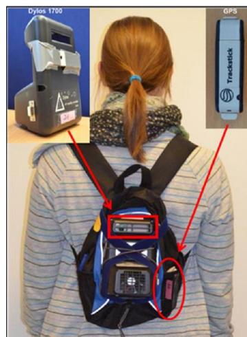
Figure 1.6 : le système portable « sac à dos » [72]
