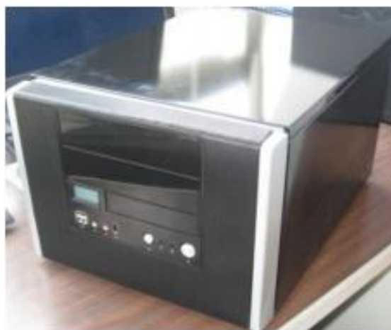
Figure 2.1 : Prototype de 2ème génération de l'analyseur. Le prototype est transportable (env. 8 kg) et a une dimension de 28,5 x 23 x 38 cm.
