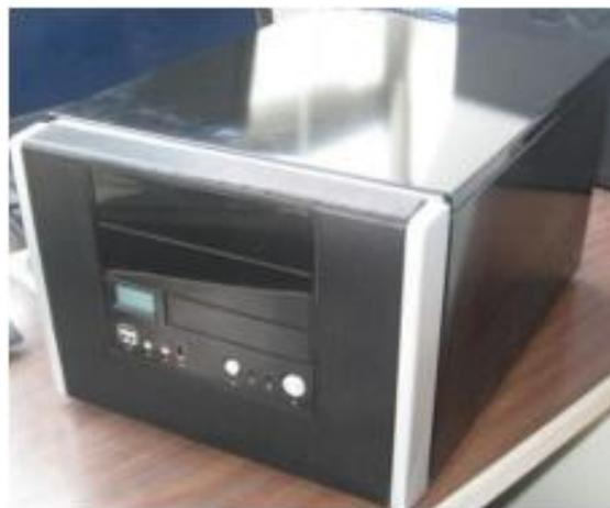
**Figure 2.1 : Prototype de 2<sup>ème</sup> génération de l'analyseur. Le prototype est transportable (env. 8 kg) et a une dimension de 28,5 x 23 x 38 cm.**
