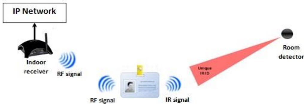
**Figure 4.11 : Interaction entre le badge et les éléments du sous-système de localisation**
