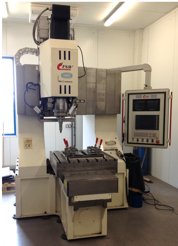
FIGURE 2.1 – Machine FSW utilisée pour tous les essais de soudage.
