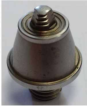
FIGURE 2.2 – Outil Triflat® de 5 mm utilisé pour la réalisation des essais de soudage.
