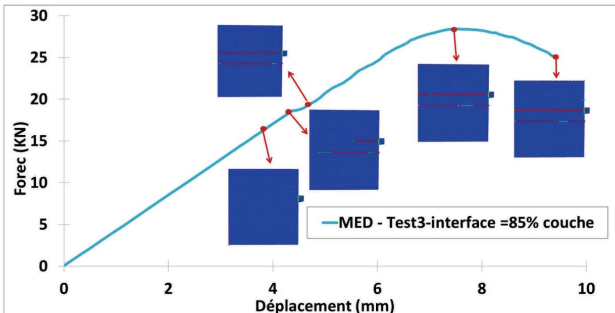
Figure 124 : Courbe force-déplacement numérique du Mur 2 – Code 3DEC
