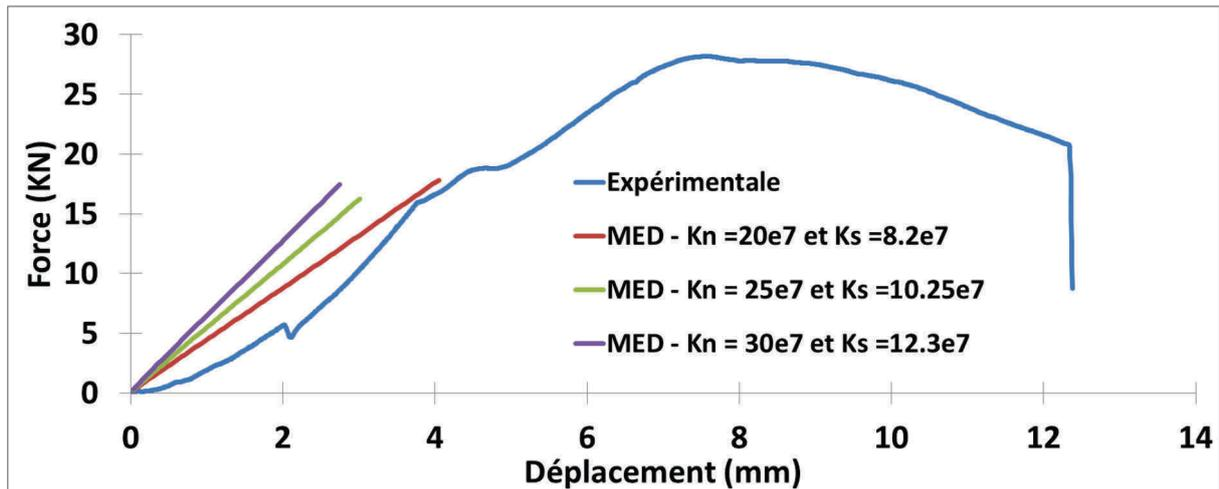
Figure 118 : Ajustement des valeurs des raideurs normales et de cisaillement du contact plaque-mur – Mur 2 – Test 3
