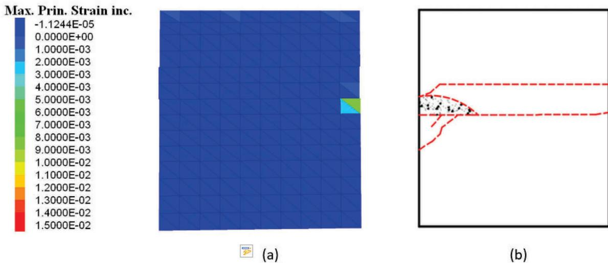
Figure 136 : Mur 6 – Essai 3 a) Déformations principales maximales numériques – maillage (10 x 3 x 2), b) mode de la rupture expérimentale
