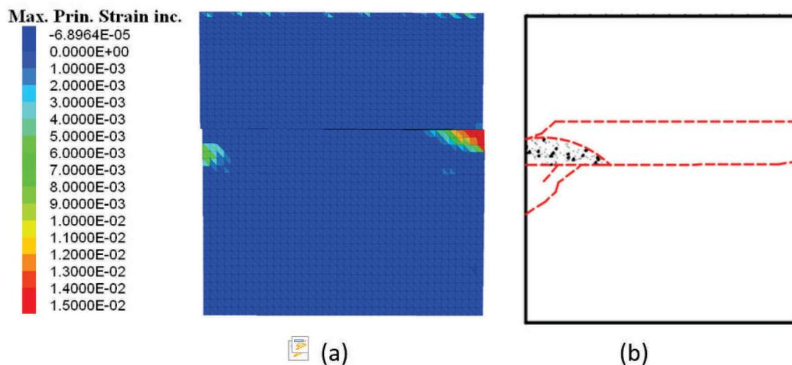
**Figure 123 : a) Déformation dans le modèle numérique MED 70% - point P5''; b) Rupture expérimentale**
