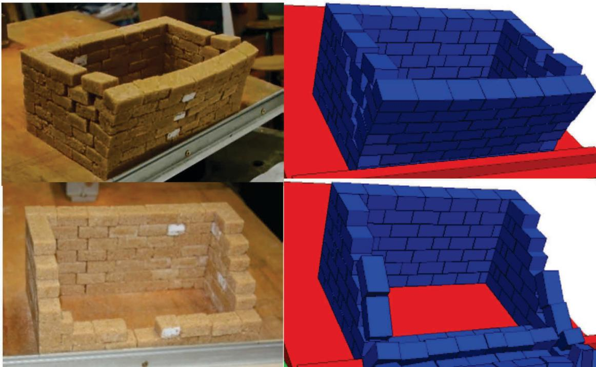
*Figure 56 : Comparaison entre les processus de ruptures expérimentales et numériques–Essai 6*
