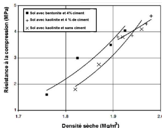
**Figure 67: Résistance à la compression en fonction de la densité sèche (Morel et al. 2007)**
