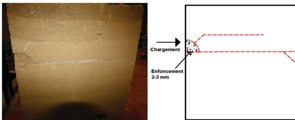
Figure 85 : Mur 1 après rupture - Face B (Force appliquée à gauche)
