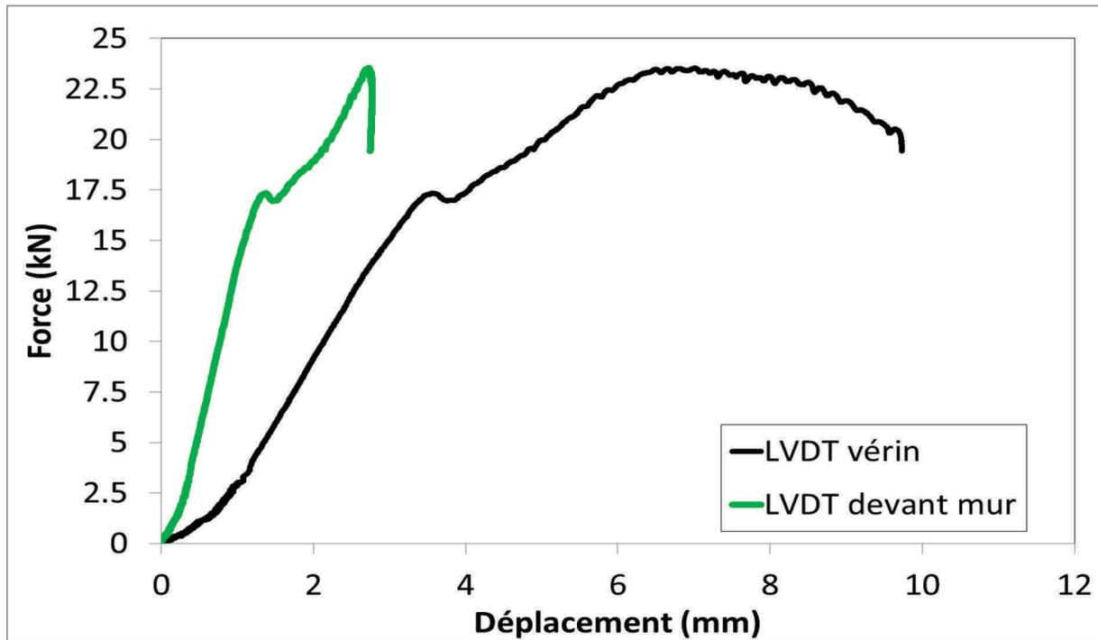
Figure 94 : Courbes des déplacements horizontaux/force pour le Mur 6 – Essai 1
