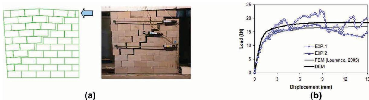
**Figure 15 : Comparaison entre les résultats expérimentaux et numériques (MEF and MED) (Mohebkhah and Tasnimi 2007): (a) mode de rupture numérique et expérimental; (b) courbes force – déplacement**
