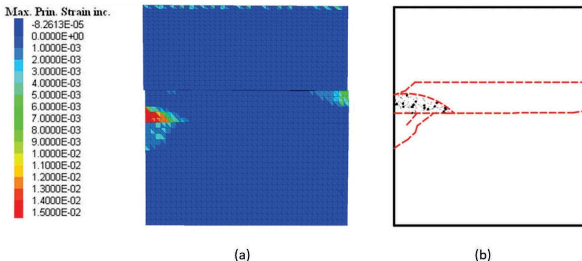
**Figure 133 : Mur 6 – Essai 3 a) Déformations principales maximales numériques – maillage (40 x 12 x 6), b) mode de la rupture expérimentale**
