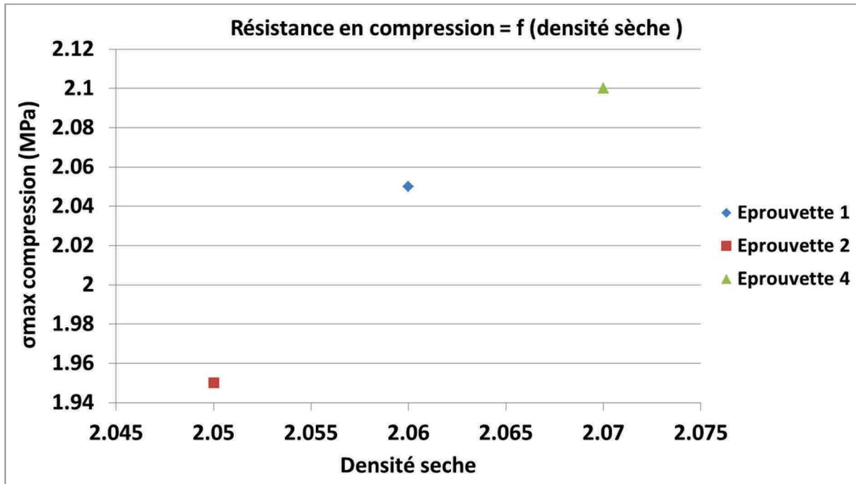
Figure 165 : résistance en compression en fonction de la densité sèche des éprouvettes
