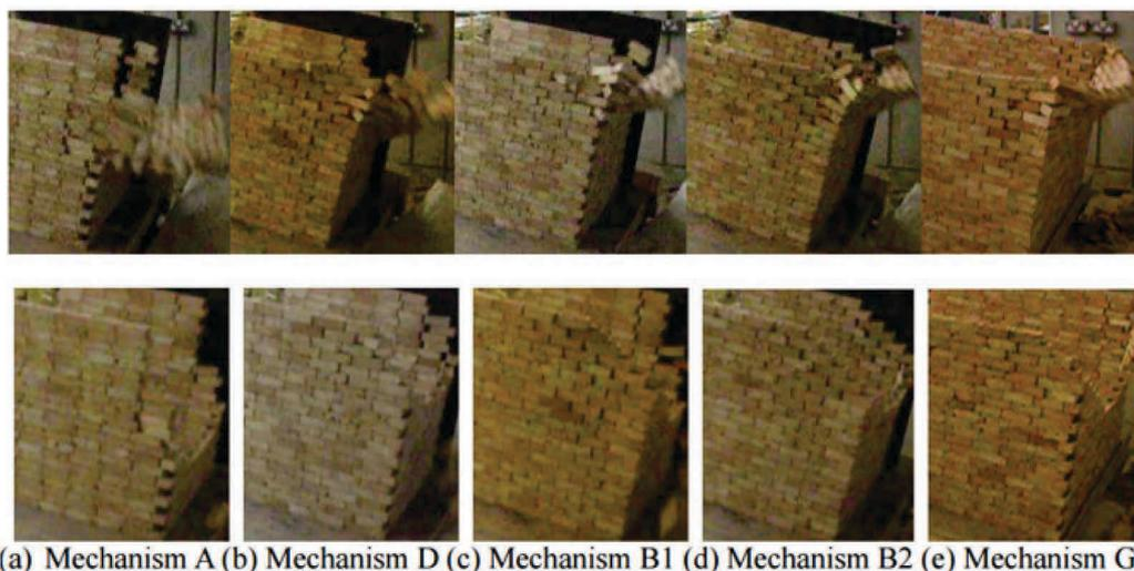
Figure 7 : Modes de ruptures des murs en maçonneries chargement hors plan (Shi et al. 2008)
