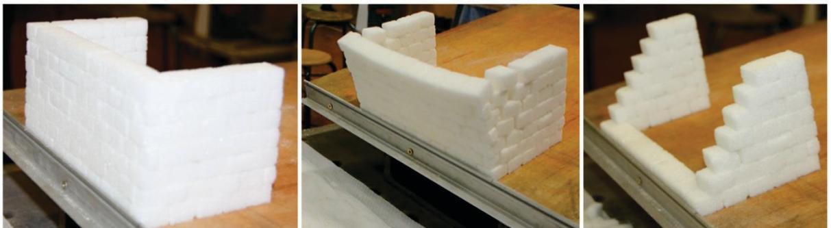
*Figure 33 : Processus de rupture de l'essai 3*
