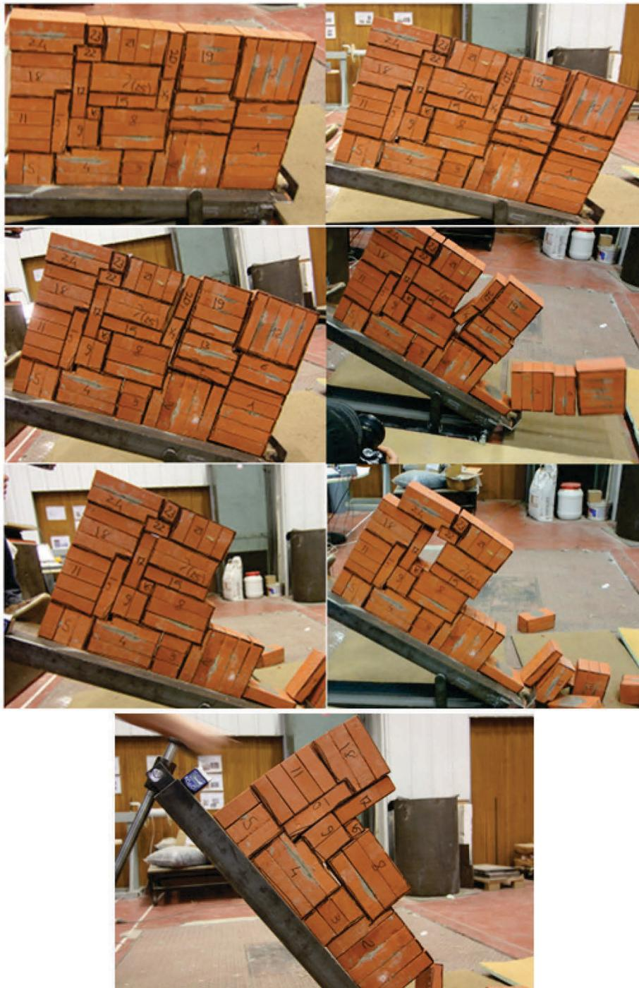
*Figure 49 : Processus de rupture de l'essai 9*
