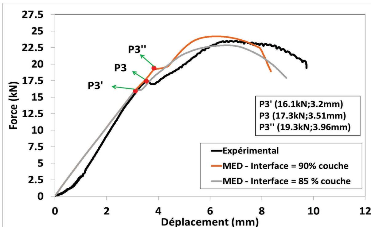
Figure 110 : comparaison entre les courbes force déplacement numériques et expérimentales – Essai 1 – Mur 6
