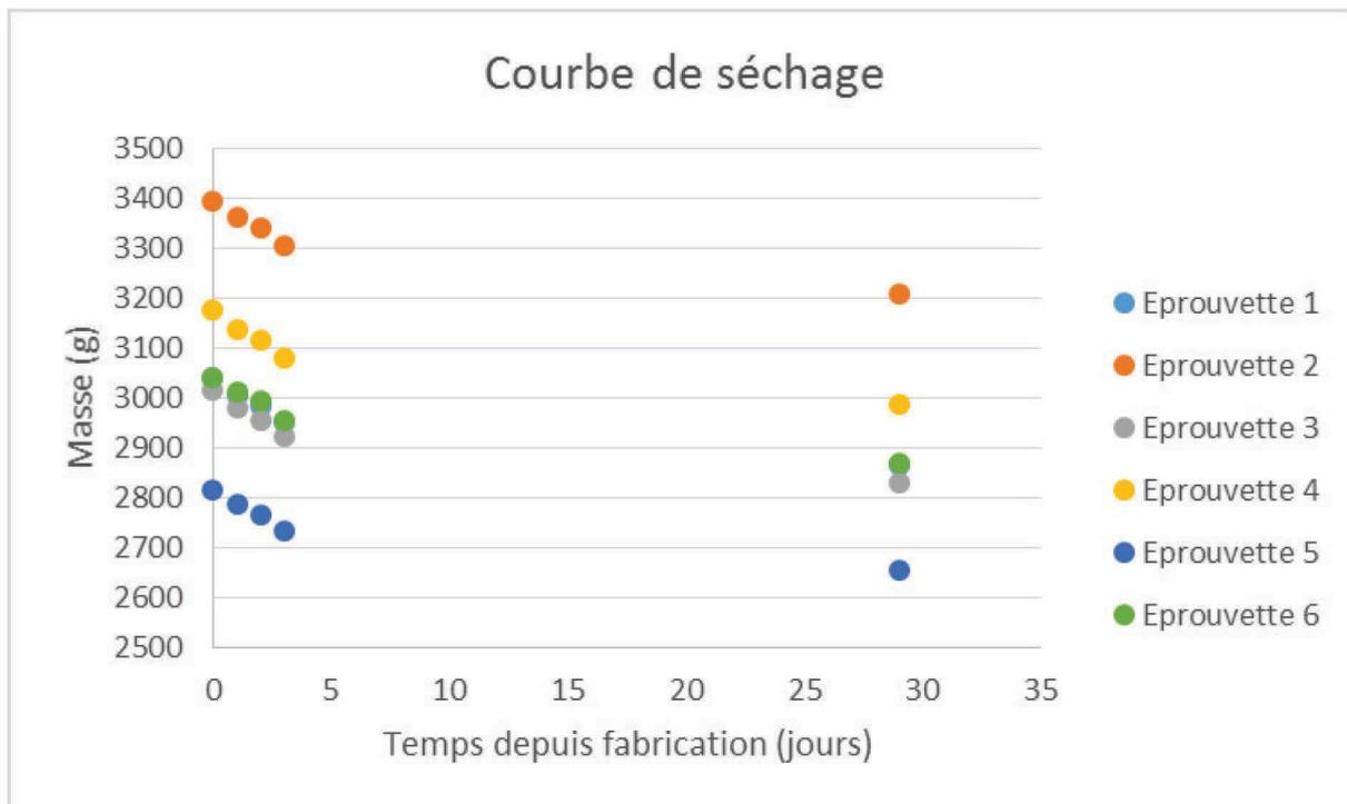
Figure 163 : Courbe de séchage des éprouvettes cylindriques
