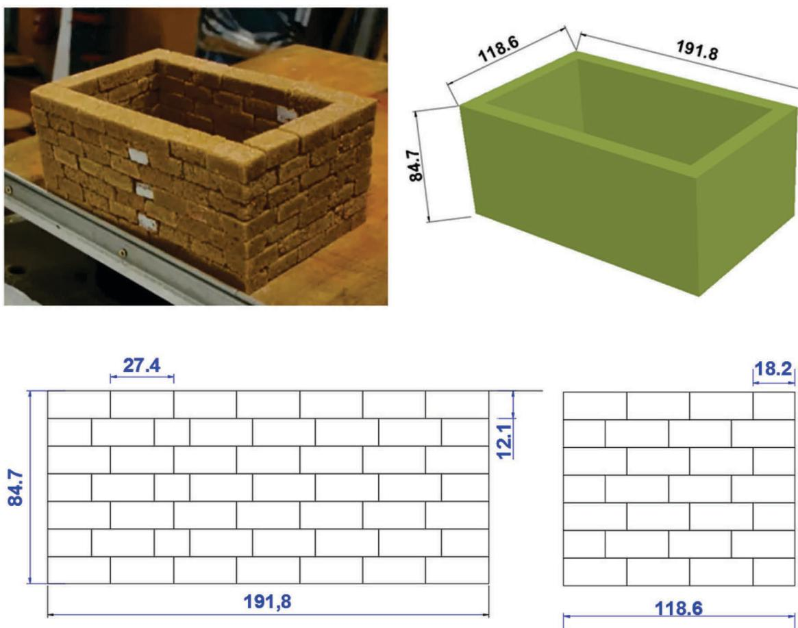
Figure 38 : Essai 6 – maison de quatre murs (blocs type 2)
