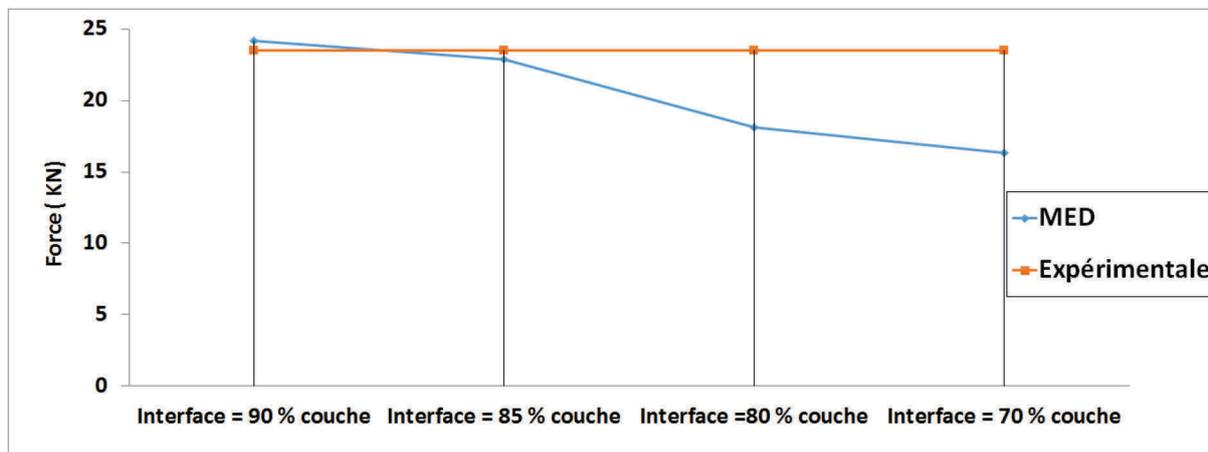
**Figure 106 : comparaison entre les valeurs des forces ultimes numériques et expérimentale – Mur6 – Essai**
