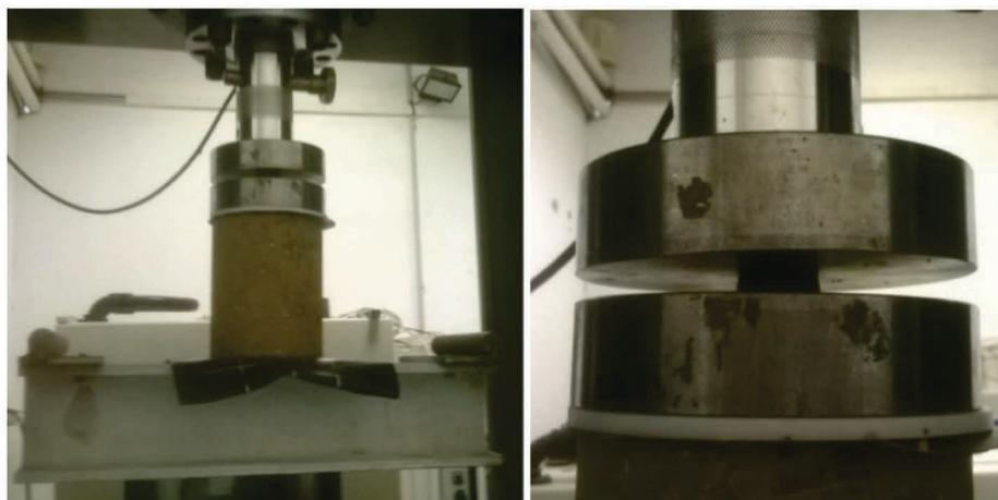
Figure 164 : Dispositifs anti-fretage et anti-déversement
