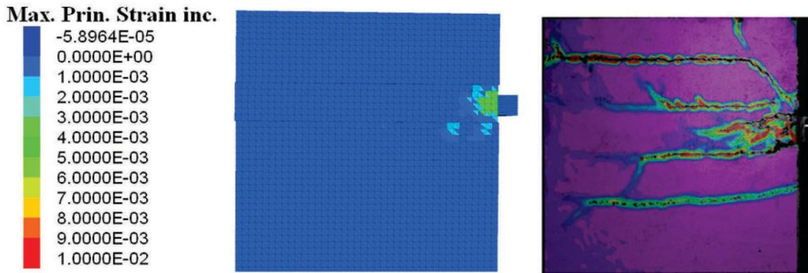
*Figure 114 : Comparaison des déformations principales maximales numériques (MED 70%) avec les déformations expérimentales (Méthode de la corrélation d'images) – Essai 1 – Mur6*
