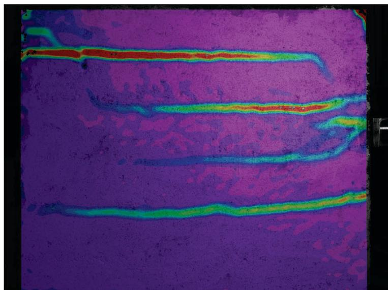
Figure 96 : Déformation principale e1 au point P3
