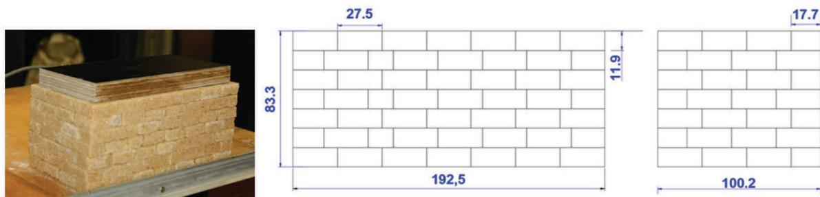
Figure 36 : Essai 5 - Mur principal et deux murs de refends - sucre de type 2
