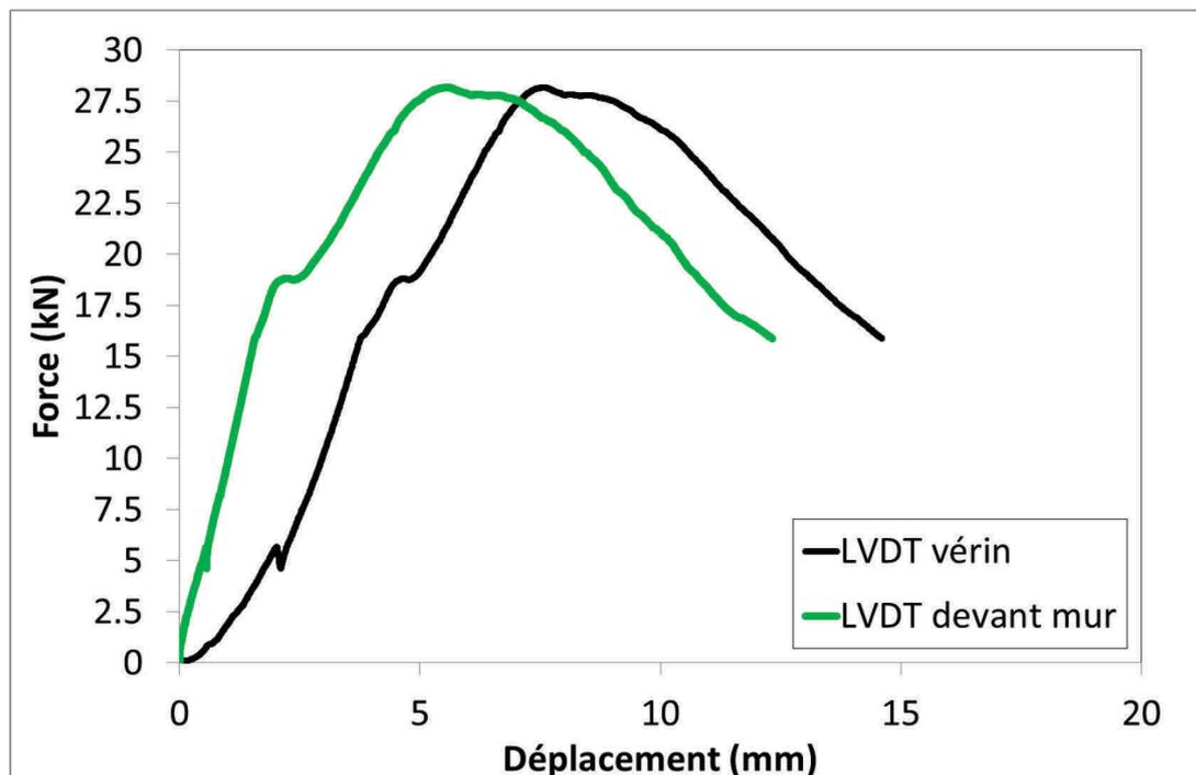
Figure 100 : Courbes des déplacements horizontaux/force pour le Mur 2 – Essai 3
