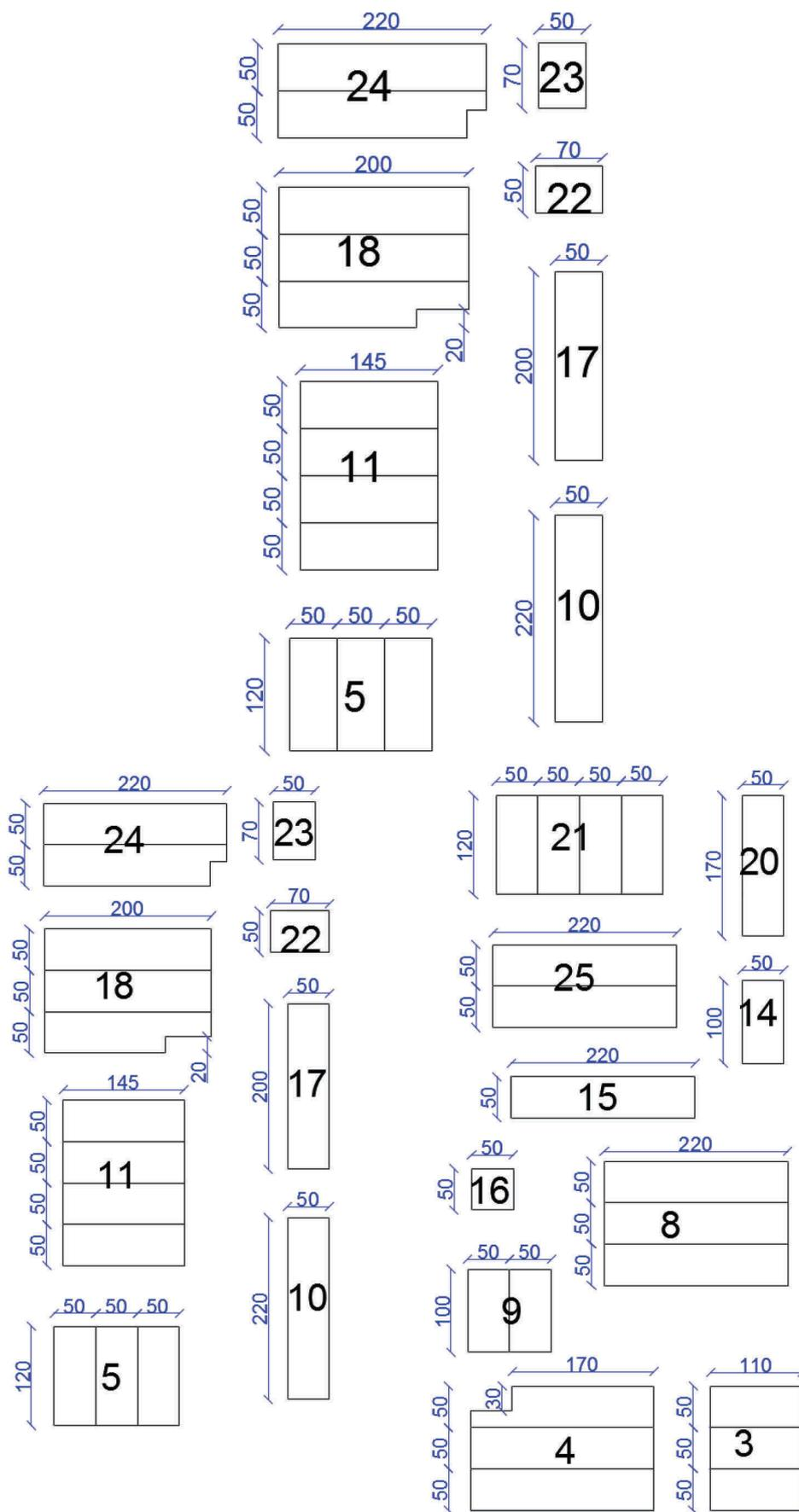
Figure 139 : Dimensions des assemblages des briques -essai 9
