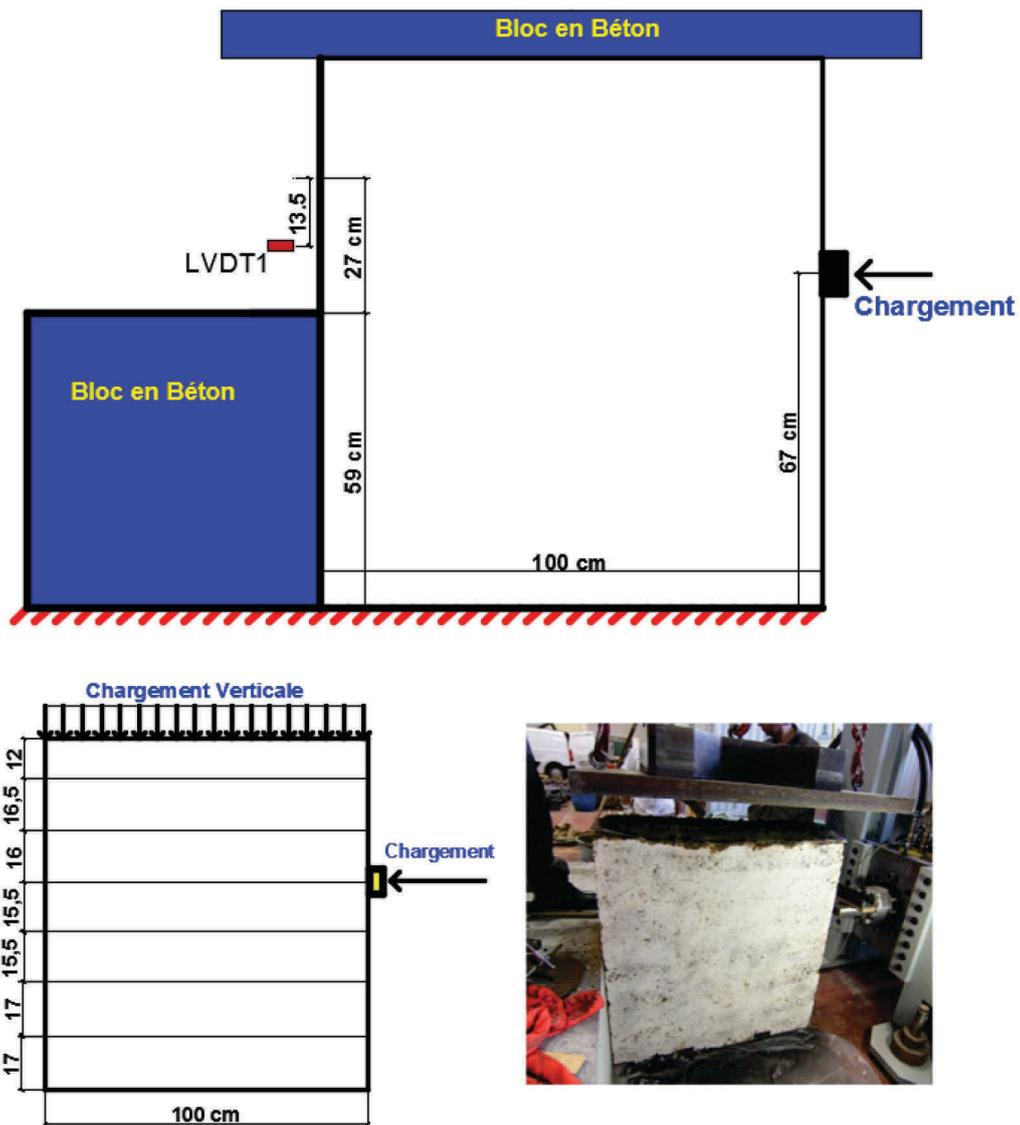
Figure 83 : Banc d'essai pour l'essai 3
