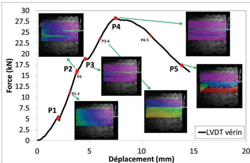
Figure 101 : Modes des ruptures du Mur 2 – Essai 3
