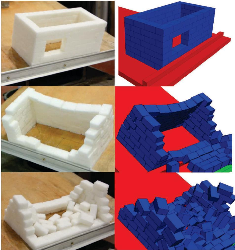
*Figure 57 : Comparaison entre les processus de ruptures expérimentales et numériques–Essai 7*
