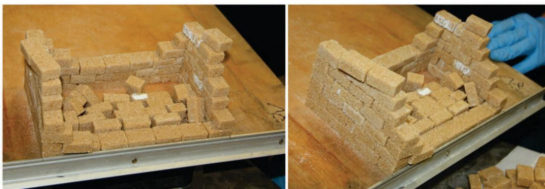
*Figure 40 : Processus de rupture de l'essai 6 – rupture mur aval*
