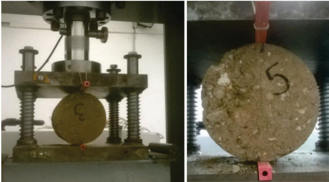
**Figure 166 : Dispositif traction par fendage**
