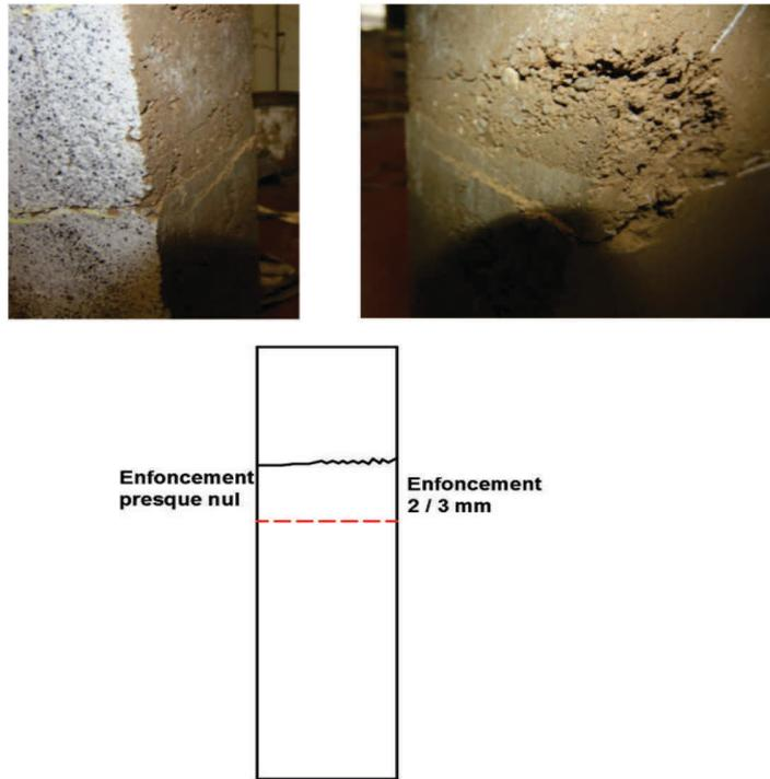
*Figure 88 : Mur 1 après rupture - Face A*
