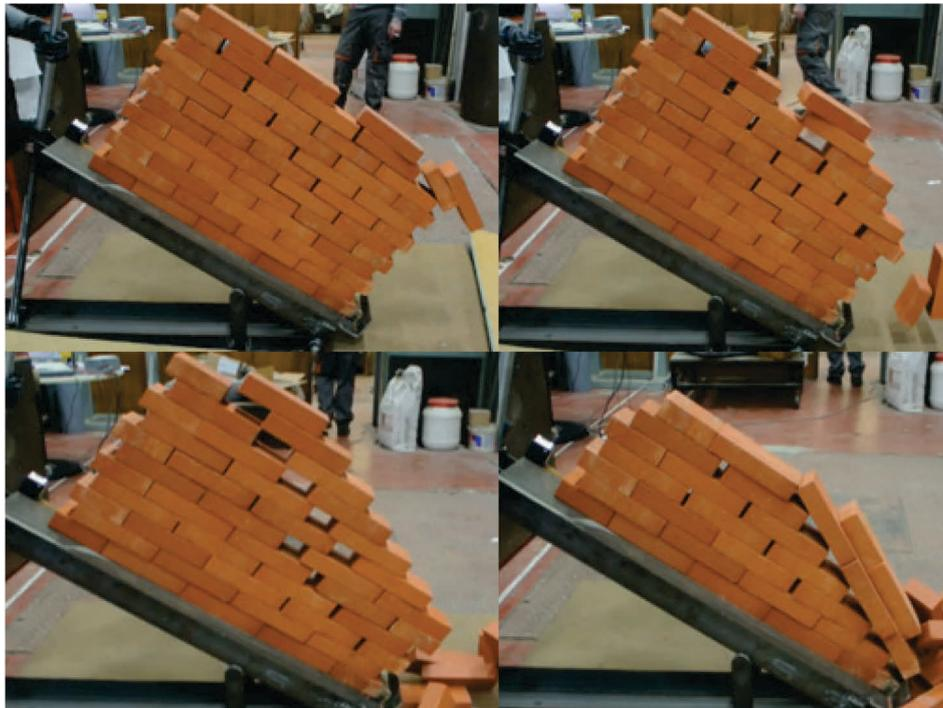
*Figure 47 : Processus de rupture de l'essai 8*
