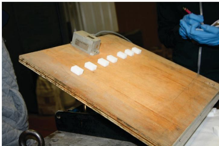
**Figure 25 : Essai pour déterminer l'angle de frottement entre les blocs de sucres et la table inclinée**
