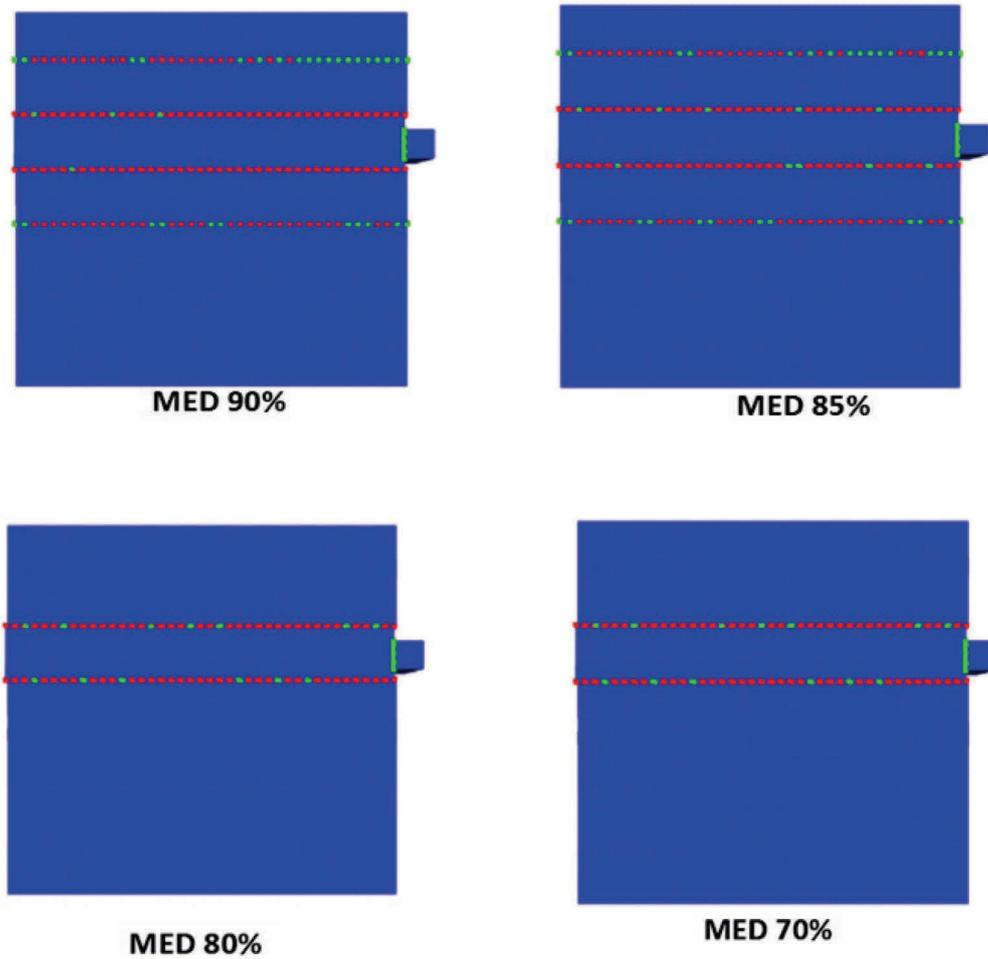
*Figure 109 : Les fissures au niveau des joints pour les modèles numériques (code 3DEC) – Mur 6 – Essai 1*
