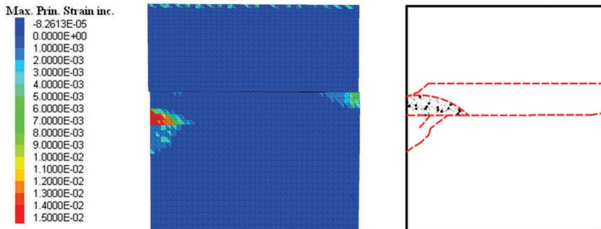
**Figure 121 : a) Déformation dans le modèle numérique MED 85% - point P5; b) Rupture expérimentale**
