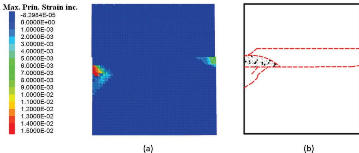
**Figure 132 : Mur 6 – Essai 3 a) Déformations principales maximales numériques – maillage (48 x 14 x 7), b) mode de la rupture expérimentale**
