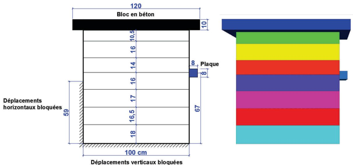
Figure 117 : Model 3DEC du Mur 2 – Essai 3
