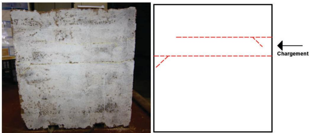
*Figure 87 : Mur 1 après rupture - Face D (Force appliquée à droite)*
