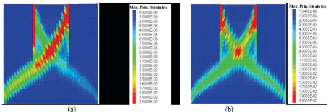
Figure 75: Isovaleurs de la déformation principale maximale: (a) avec les interfaces (b) sans les interfaces (Bui et al. 2016)
