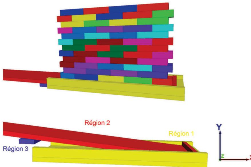
**Figure 58 : Modèle numérique 3DEC de l'essai type 3 – Mur en briques avec agencement traditionnelle**
