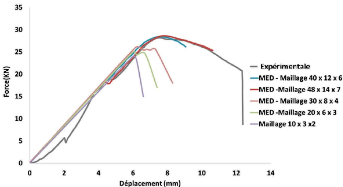
*Figure 129 : Comparaison entre courbe expérimentale et courbes numériques pour différents maillages – Essai1-Mur 6*
