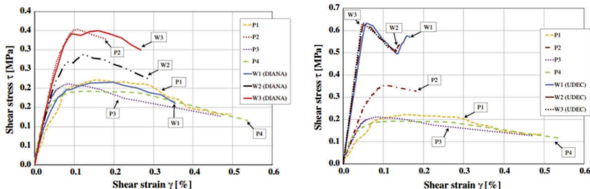
**Figure 14 : A droite : Résultats expérimentaux et numériques UDEC, A gauche : Résultats expérimentaux et numériques DIANA , Maçonnerie a faible liaison , (Giamundo et al. 2014)**
