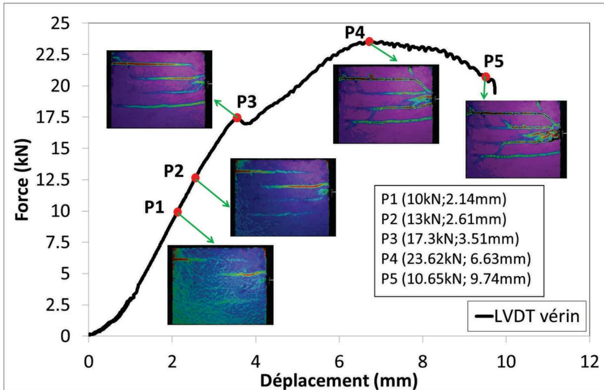
Figure 95 : Les modes des ruptures du Mur 6 – Essai 1
