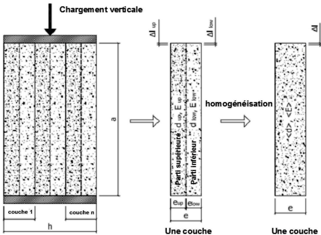
Figure 70 : Procédure de l'homogénéisation dans le sens parallèle aux lits (Bui et al. 2009)
