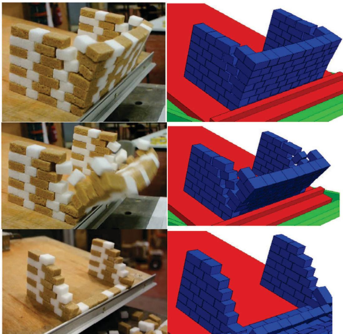
*Figure 55 : Comparaison entre les processus de ruptures expérimentales et numériques –Essai 4*
