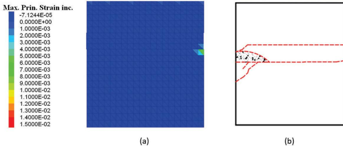
Figure 135 : Mur 6 – Essai 3 a) Déformations principales maximales numériques – maillage (20 x 6 x 3), b) mode de la rupture expérimental
