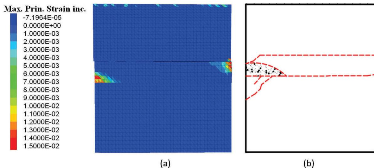
**Figure 122 : a) Déformation dans le modèle numérique MED 80% - point P5'; b) Rupture expérimentale**
