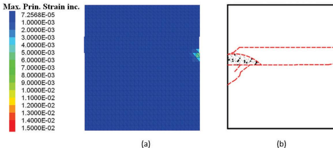
**Figure 134 : Mur 6 – Essai 3 a) Déformations principales maximales numériques – maillage (30 x 8 x 4), b) mode de la rupture expérimentale**
