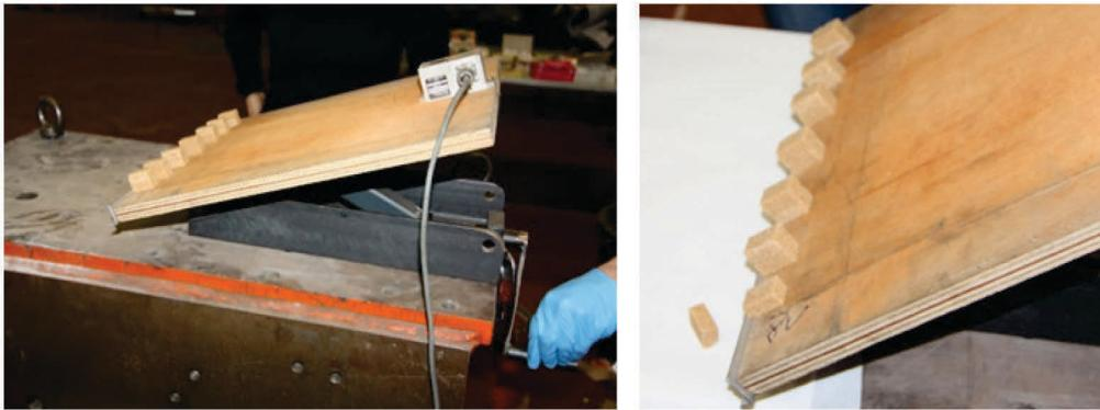
**Figure 24 : Essai visant à déterminer l'angle de frottement entre les blocs de sucre**
