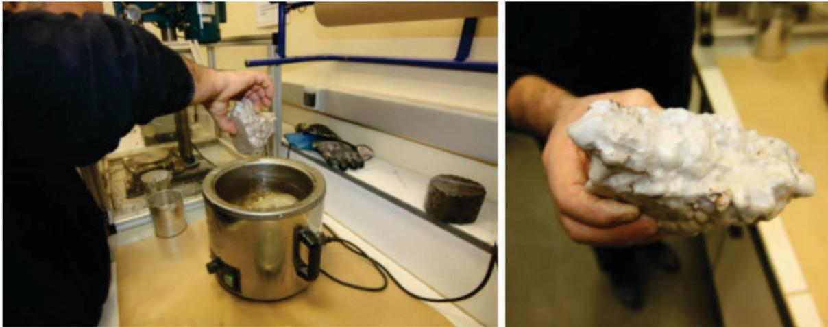
*Figure 159 : Echantillon recouvert de paraffine*
