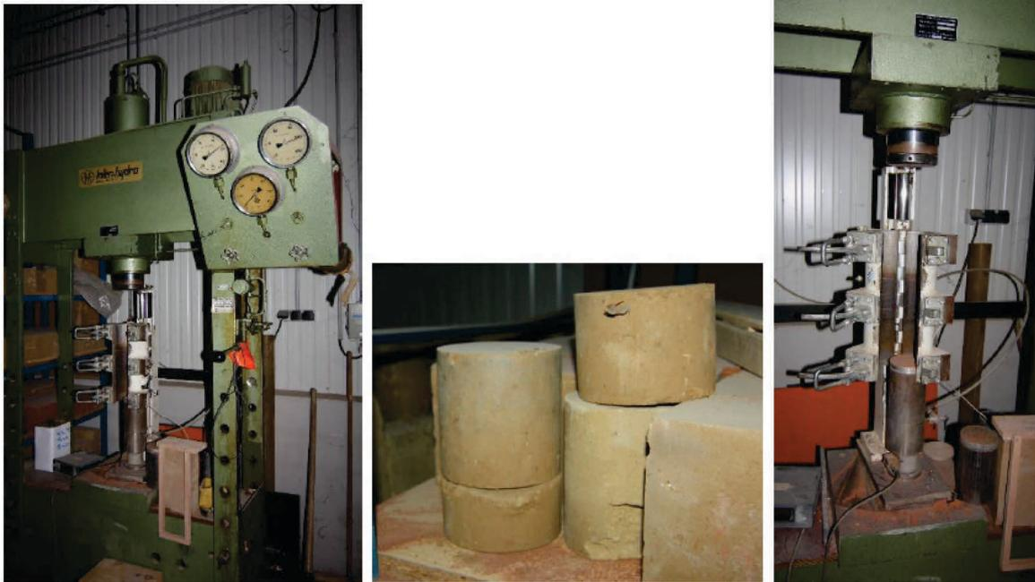
*Figure 157 : Presse pour la fabrication d'éprouvettes cylindriques*
