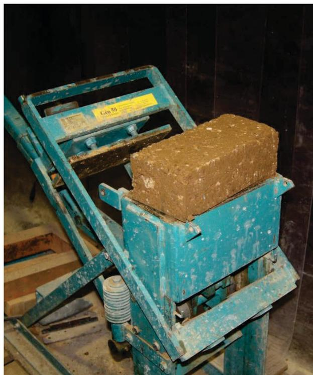
*Figure 158 : Echantillons prismatiques fabriqués par compactage statique*
