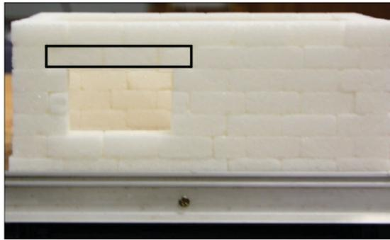
*Figure 41 : Blocs de sucre collés au-dessus de l'ouverture – essai 7*
