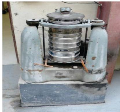
*Figure 144 : granulométrie sèche utilisé pour les graviers*
