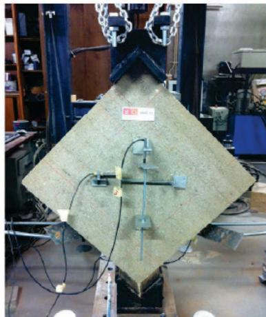
**Figure 76: Essai mené sur un mur sous chargement diagonal (Silva et al. 2013)**
