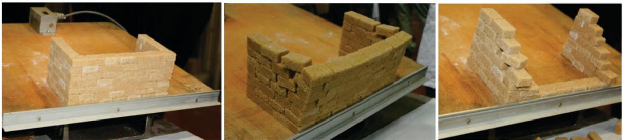
*Figure 32 : Processus de rupture de l'essai 2*
