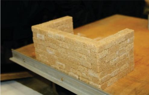
Figure 26 : Essai type 1 : Mur principal et deux murs de refend
