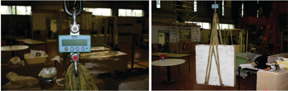
*Figure 153 : pesée du mur*
