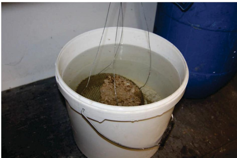
*Figure 160 : Pesée sous eau*
