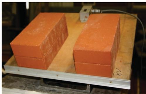
*Figure 45 : Essai pour déterminer l'angle de frottement entre les briques en béton*
