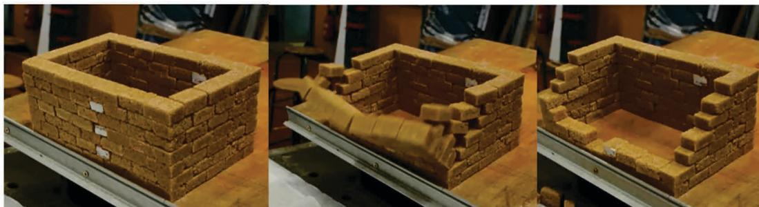
*Figure 39 : Processus de rupture de l'essai 6 – rupture mur amont*
