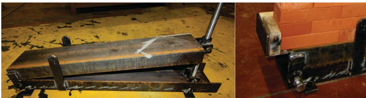
*Figure 44 : A gauche : le socle métallique, A droite : butée bloquant le déplacement horizontal de la première rangée de blocs*
