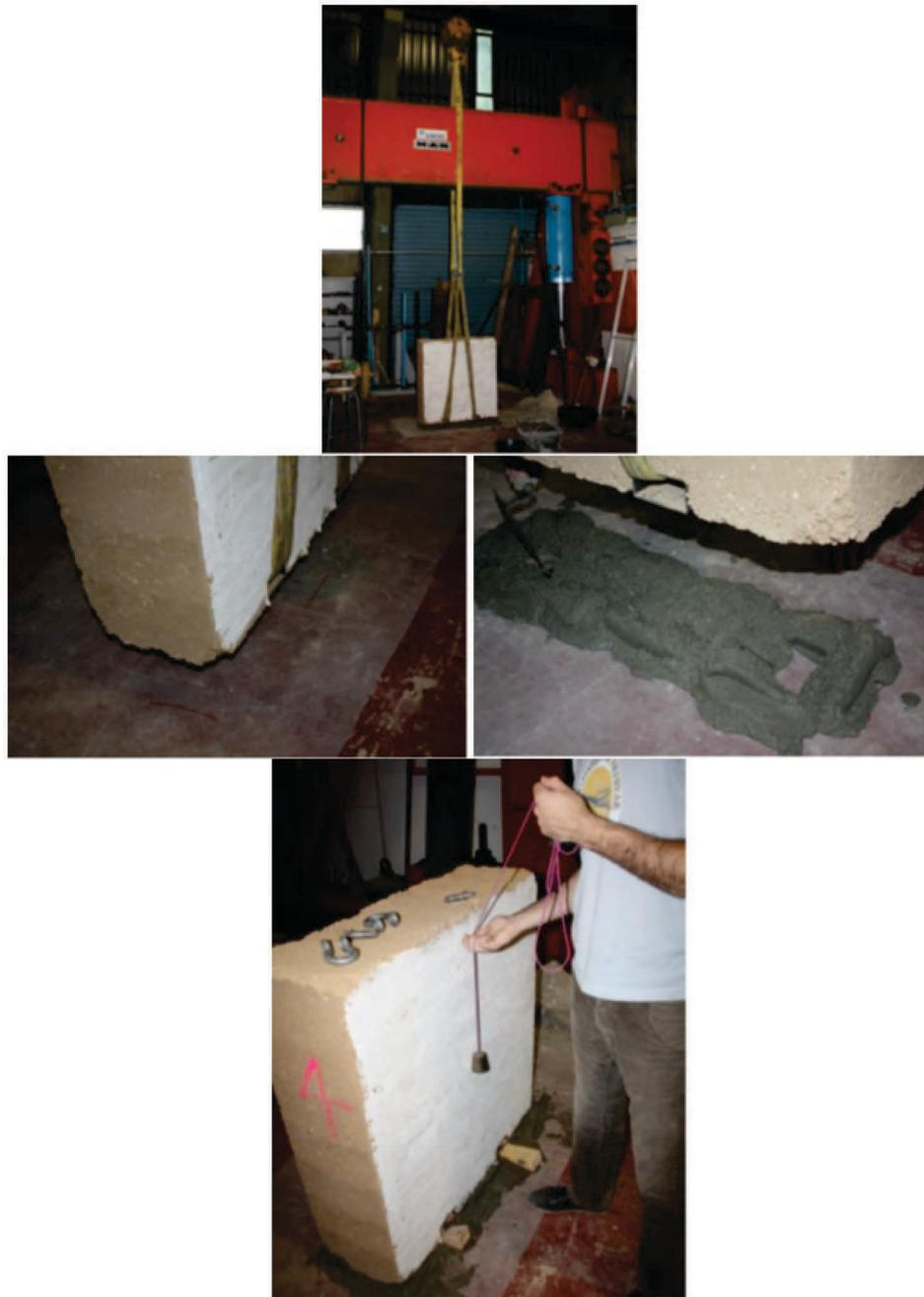
*Figure 155 : Assise du mur et Réglage de la verticalité*
