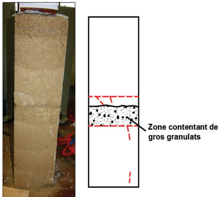
*Figure 92 : Mur 2 après rupture - Face C*
