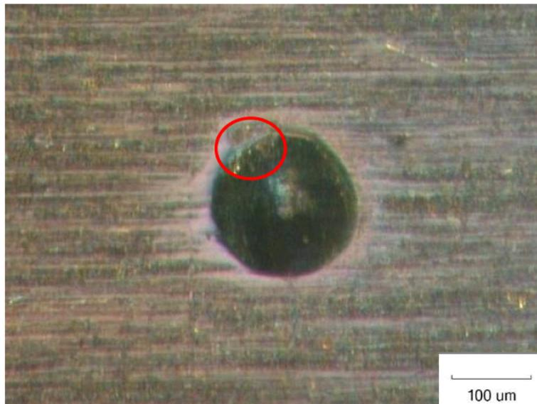
Figure II-12 Ingestion d'une particule en bord d'indent.
