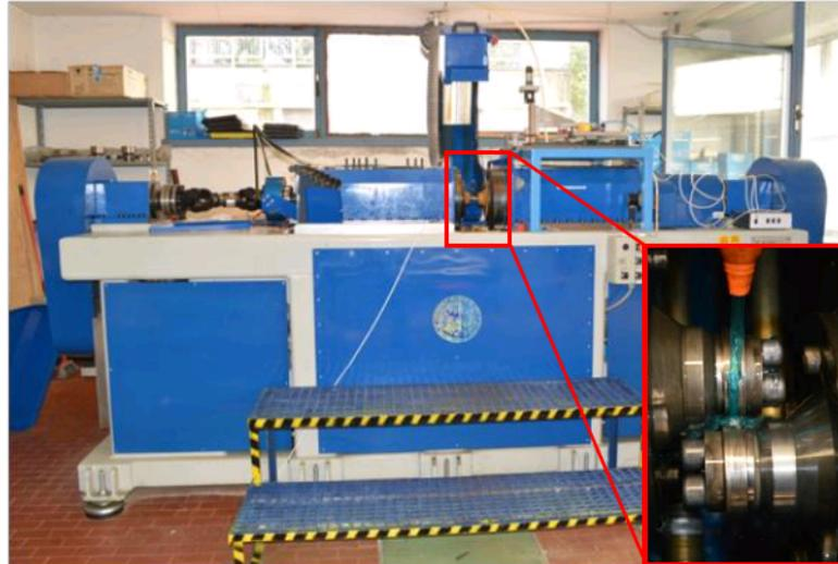
Figure II-2 Machine Bi-Disque de l'université de Brescia (Italie).
