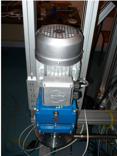
Fig. 79 Motoréducteur asynchrone monté sur le châssis du banc d'essai
