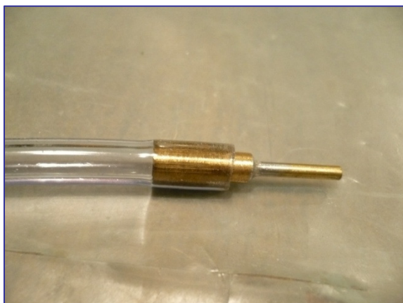
Fig. 66 Raccord en laiton enfilé dans un vinyle
