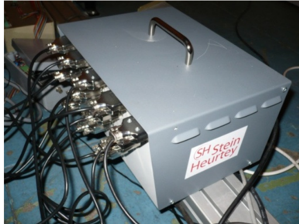
Fig. 84 Boitier d'alimentation des cartes de capteur avec tous les câbles SubD9 branchés dessus
