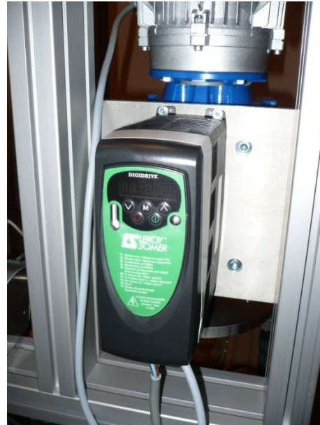
Fig. 80 Variateur du motoréducteur monté sur le châssis du banc d'essai
