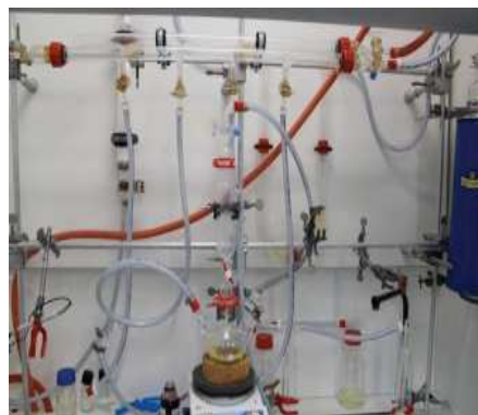
Figure II.5: Schéma de fonctionnement d'une rampe mixte vide/argon
