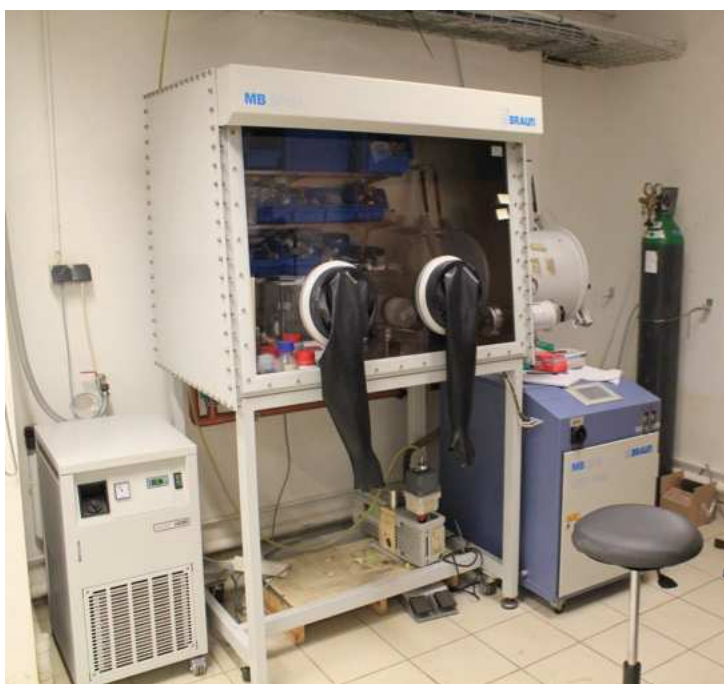
Figure II.6: Cliché d'une boîte à gants dédiée à la synthèse PDC.
