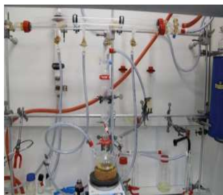
Figure II.5: Schéma de fonctionnement d'une rampe mixte vide/argon
