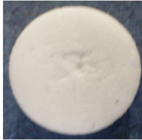
(b) mélamine d'épaisseur 4cm : \sigma = 12000 \text{Ns/m}^4 , \phi = 0.98 , \alpha_\infty = 1.01 , \Lambda = 100 \cdot 10^{-6} \text{m} , \Lambda' = 150 \cdot 10^{-6} \text{m} , [Lec05]
