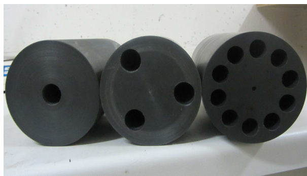
FIGURE 1.20 – Photographie de trois échantillons de blocs à résonateurs quart-d'onde
