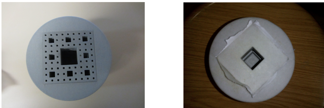
FIGURE 2.32 – Échantillons dans le porte-échantillon : la photo de droite montre l’utilisation des morceaux de papiers pour combler les jeux entre l’échantillon et son contenant
