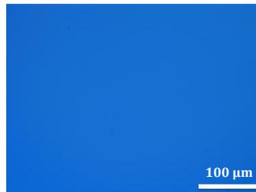
Figure 3-13. Observation au microscope optique interférométrique des couches minces d' $\text{Al}_2\text{O}_3$  amorphes (20 nm) après recuit comprenant un palier isotherme à  $950^\circ\text{C}$  sous atmosphère  $N_2$  puis sous  $O_2$  durant 2 heures. Le 1<sup>er</sup> recuit mène à la cristallisation du film sans formation de bulles.
