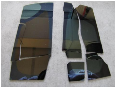
Figure 5-41. (a)(c)(d) Photographies et (b) images SAM des échantillons de mesure d'énergie pour le collage \alpha\text{-SiOCH}_3/\text{Si} (300 nm et k = 2,5 ) recuit à 900^\circ\text{C} selon le largueur de la barrette (a)(b) 3, 5 et 10 mm (c) 40 mm ; et (d) d'un collage \alpha\text{-SiOCH}_3/\text{Si} (300 nm et k = 2,25 ) pleine plaque de diamètre 200 mm.
