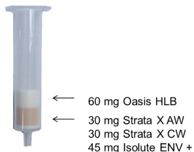
Figure 31 : Cartouche SPE multicouche fabriquée au laboratoire
