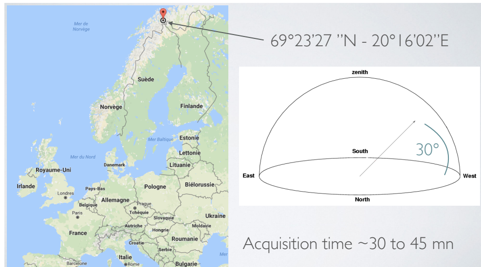
FIGURE 67 – Carte de la Norvège marquée du lieu d'observation et schéma décrivant la géométrie d'acquisition. Le temps d'acquisition pour chaque série de spectre était entre 30 et 45 minutes.
