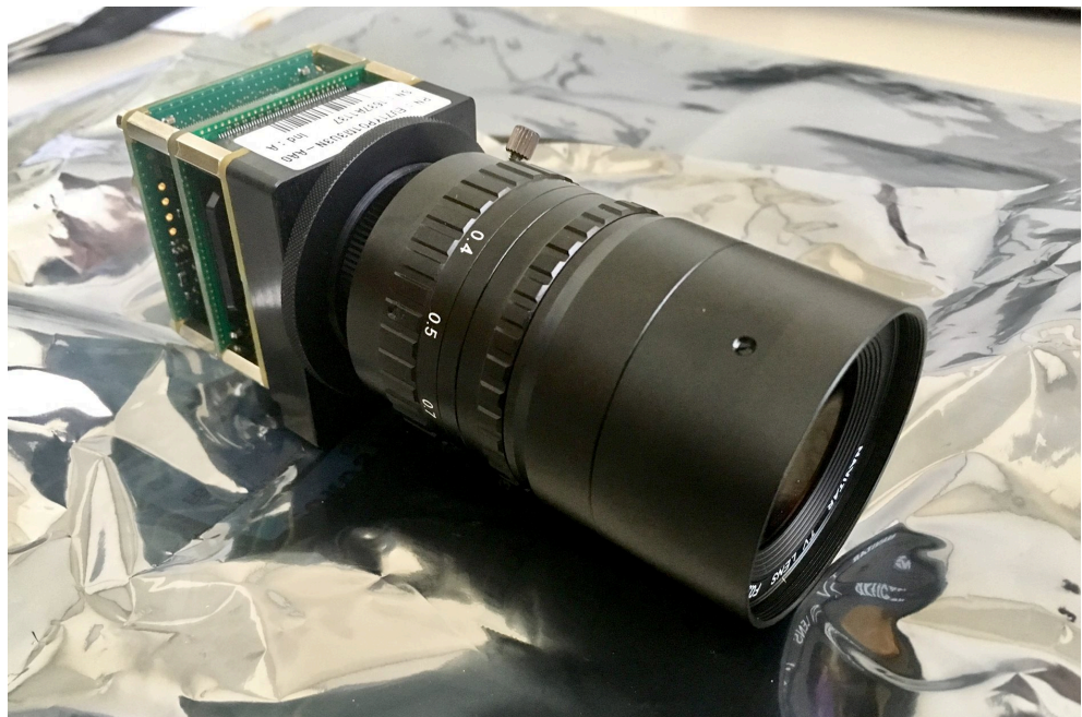
FIGURE 63 – Détecteur ONYX de Teledyne-E2V, monté ici avec l'objectif Navitar.
