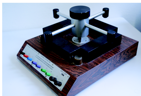
FIGURE 2.6 – Cadre d'Epstein 700 tours utilisé au laboratoire SATIE
