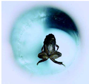
FIGURE 1.3 – Lévitation d'une grenouille dans un champ d'induction de 16 teslas [1]
