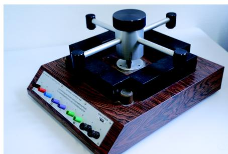
FIGURE 2.6 – Cadre d'Epstein 700 tours utilisé au laboratoire SATIE
