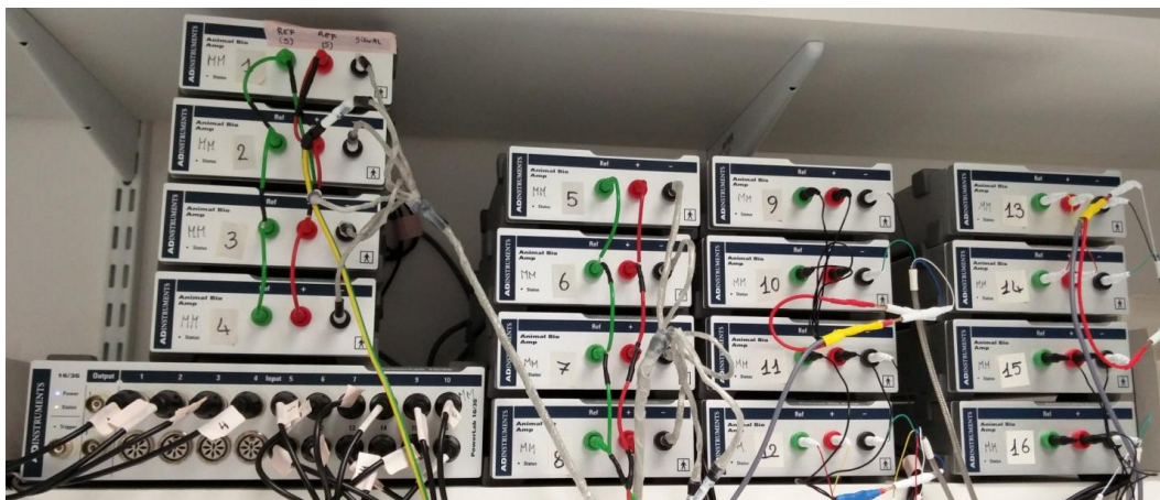
Fig. 36 : Enregistrement vidéo-EEG des souris Na_v1.1^{-/-} injectées avec les constructions virales et implantées avec des électrodes de contact. A) Caméra filmant la cage d'enregistrement dans laquelle se trouve une souris dont le connecteur est relié à un adaptateur rotatif (lui donnant une liberté de mouvement). B) Amplificateurs et système d'acquisition permettant d'enregistrer 16 électrodes simultanément (4 souris possédant 4 électrodes d'enregistrement).
