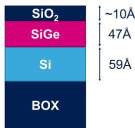
Figure 135 : Empilement SiO<sub>2</sub>/SiGe/Si/BOX(SiO<sub>2</sub>) et épaisseurs associées (mesurées par ellipsométrie).
