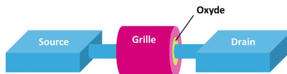
Figure 7 : Représentation schématique d'un transistor à grille enrobante (GAA).
