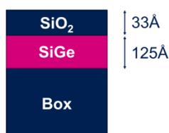
Figure 146 : Empilement SiO<sub>2</sub>/SiGe/BOx analysé.
