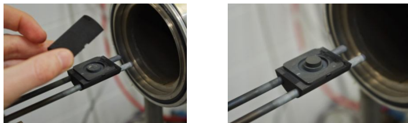
Figure B.III. 7 Suscepteur graphite avec ou sans pastille de graphite
