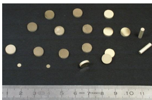
Figure A.I.1 : Échantillons de TiN préparés pour FUTURIX.
