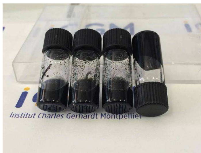
Figure 3 : Photographie du buckygel rédox à différents pourcentage en poids de NTCs. De 0,01%, 0,02 %, 0,5% et 5% en poids de NTCS respectivement.
