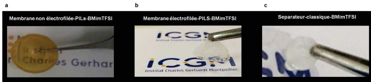
Figure 6 : Photographie des trois membranes après imprégnation d'un liquide ionique ( BMimTFSI ), (a) le polymère liquide ionique non électrofilé imprégné du liquide ionique BMimTFSI , (b) le polymère liquide ionique mis en œuvre par électrofilage et imprégné du liquide ionique BMimTFSI , (c) séparateur classique à base de cellulose imprégné de liquide ionique BMimTFSI .
