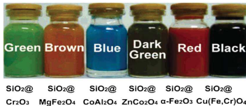
Figure 10: Photographie de silice avec des coquilles d'oxydes métalliques différentes[192].
