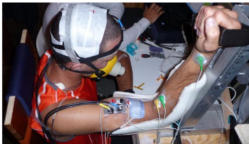
Figure 17. Dispositif expérimental utilisé pour l'évaluation de la fonction neuromusculaire lors d'un exercice des fléchisseurs du coude.
