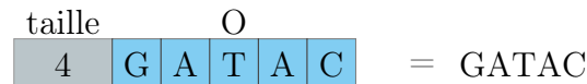
FIGURE 3.5 : Une boîte explicite BX(4, \{G, A, T, A\}) codant la séquence GATA.
